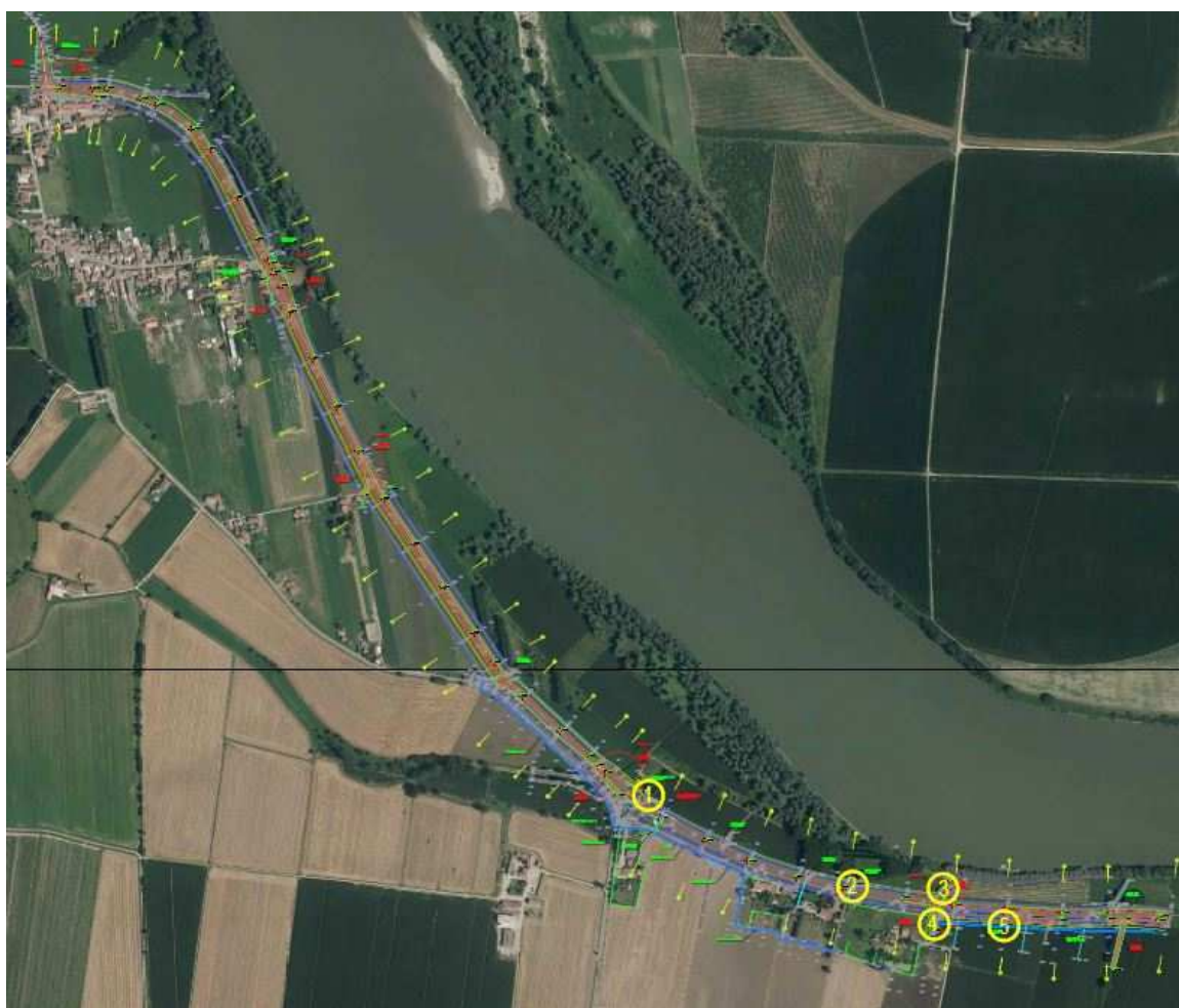
Fig.3.4.1 Individuazione vegetazione da rimuovere lungo l'argine
