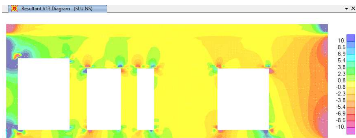
Figura 11.16 SLU FOND.1: V13, max= -19.23 kN/m
