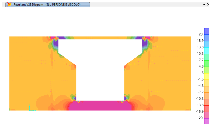
Figura 10.28 SLU. FOND2: V23, max= -37.06 kN/m
