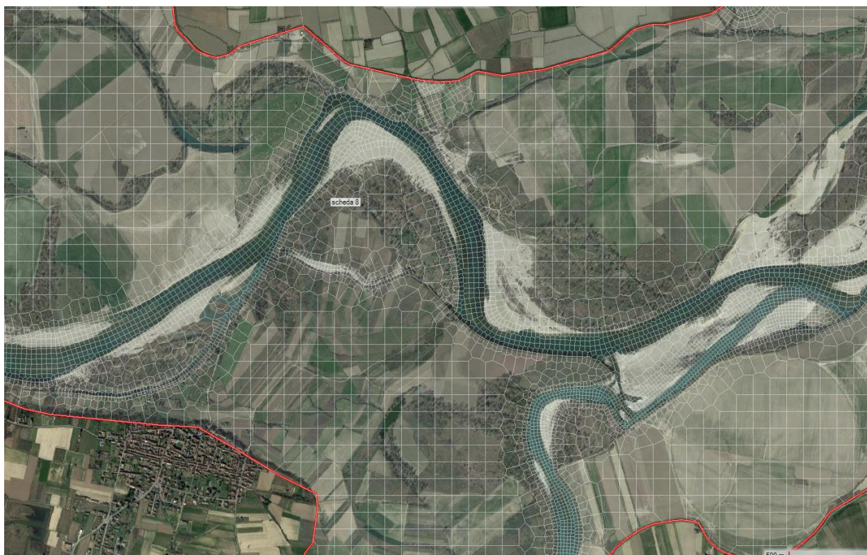
figura 4: Particolare della mesh di calcolo nella lanca su ortofoto.
