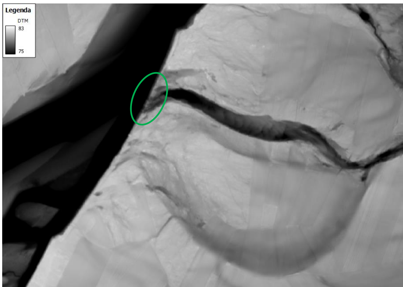
Figura 12 - Morfologia della zona del pennello. Il DTM evidenzia come nella zona evidenziata in verde siano presenti due depressioni nella struttura del pennello. In tali aree la quota risulta circa pari a 77.10 m s.l.m.m.
