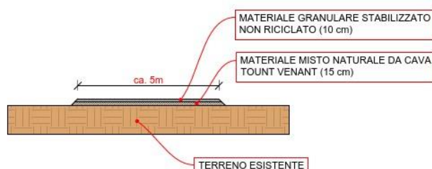
SEZIONE TIPO: strada di cantiere Scala 1:50
