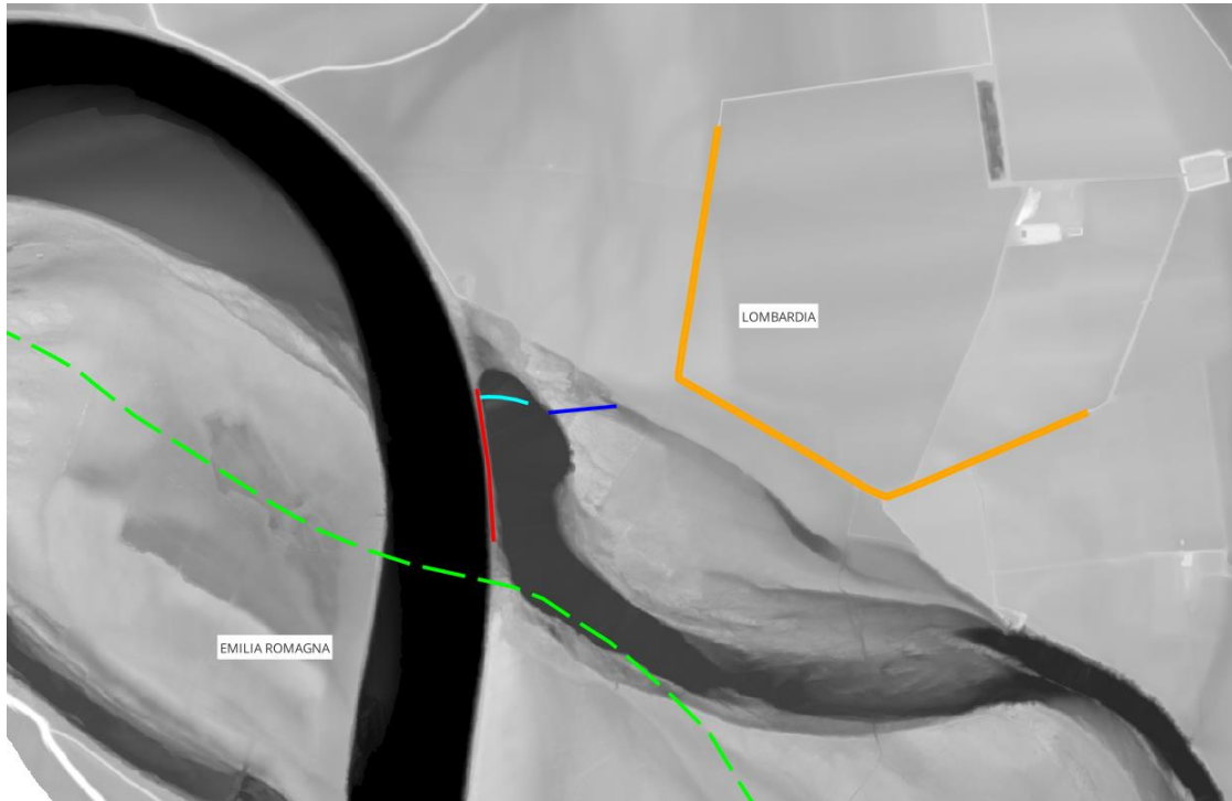
Figura 19 Planimetria degli interventi previsti: in rosso l'adeguamento del pennello idraulico, in blu lo scavo del canale per l'attivazione della lanca secondaria, in ciano la scogliera ed in arancio l'adeguamento dell'argine golenale. Come si vede dal confine indicato in verde, gli interventi sono tutti collocati all'interno del territorio della Regione Lombardia.
