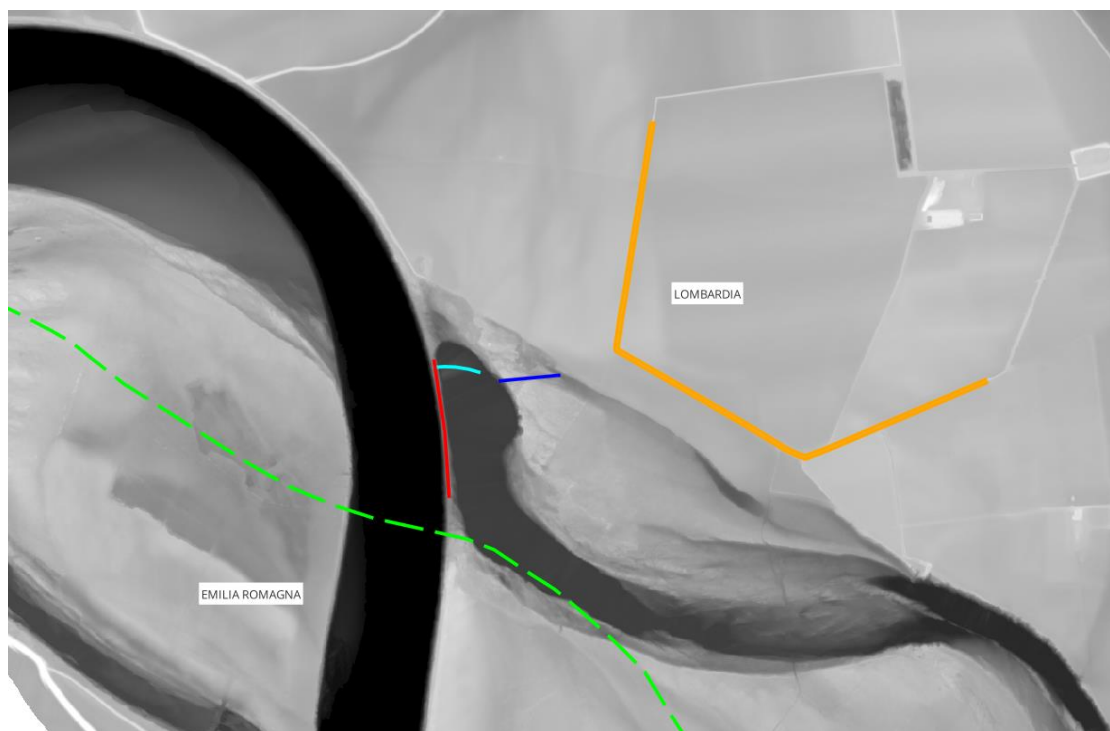
Figura 24 - Planimetria degli interventi previsti: in rosso l'adeguamento del pennello idraulico, in blu lo scavo del canale per l'attivazione della lanca secondaria, in ciano la scogliera ed in arancio l'adeguamento dell'argine golenale. Come si vede dal confine indicato in verde, gli interventi sono tutti collocati all'interno del territorio della Regione Lombardia.
