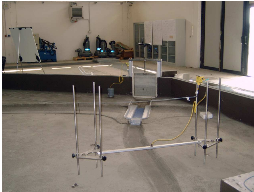
Fig. 2 Particolare di uno dei manufatti di regolazione (visto da monte)
