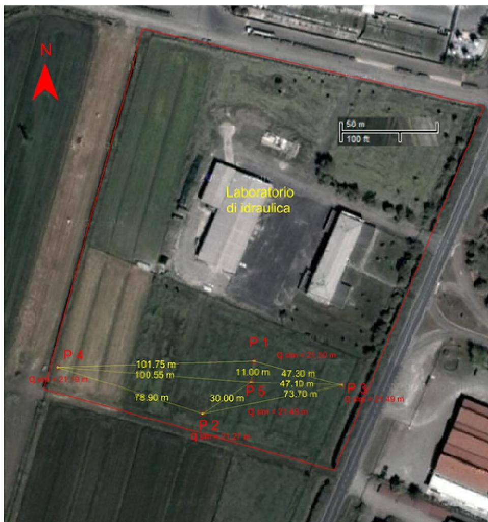
Fig. 1 Dettaglio disposizione pozzi
