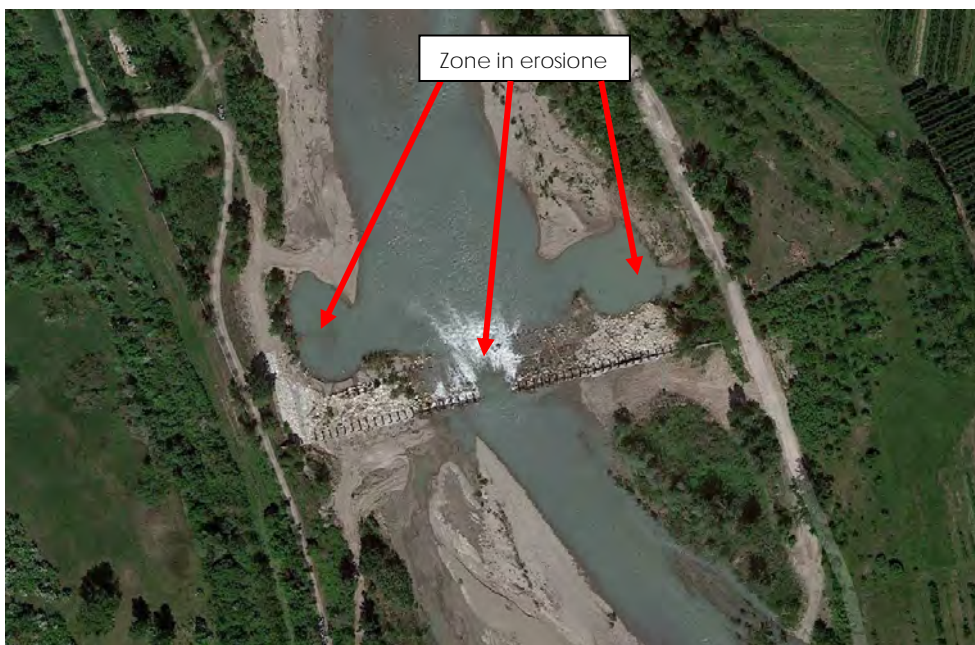
Figura 14 Configurazione attuale della briglia selettiva con evidenti segni di erosione a valle della struttura
