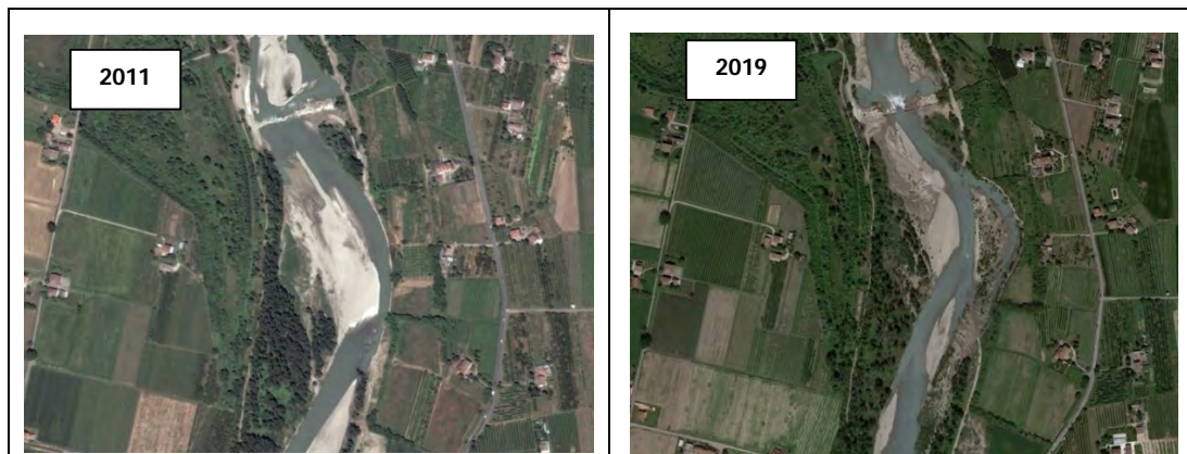
Figura 2-5 Evoluzione planimetrica della sponda destra, a monte della briglia selettiva, dal 2011 al 2019.
