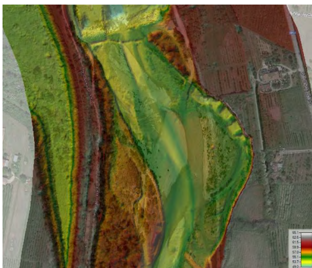
Figura 9 Rilievo DTM con l'erosione in atto della sponda destra
