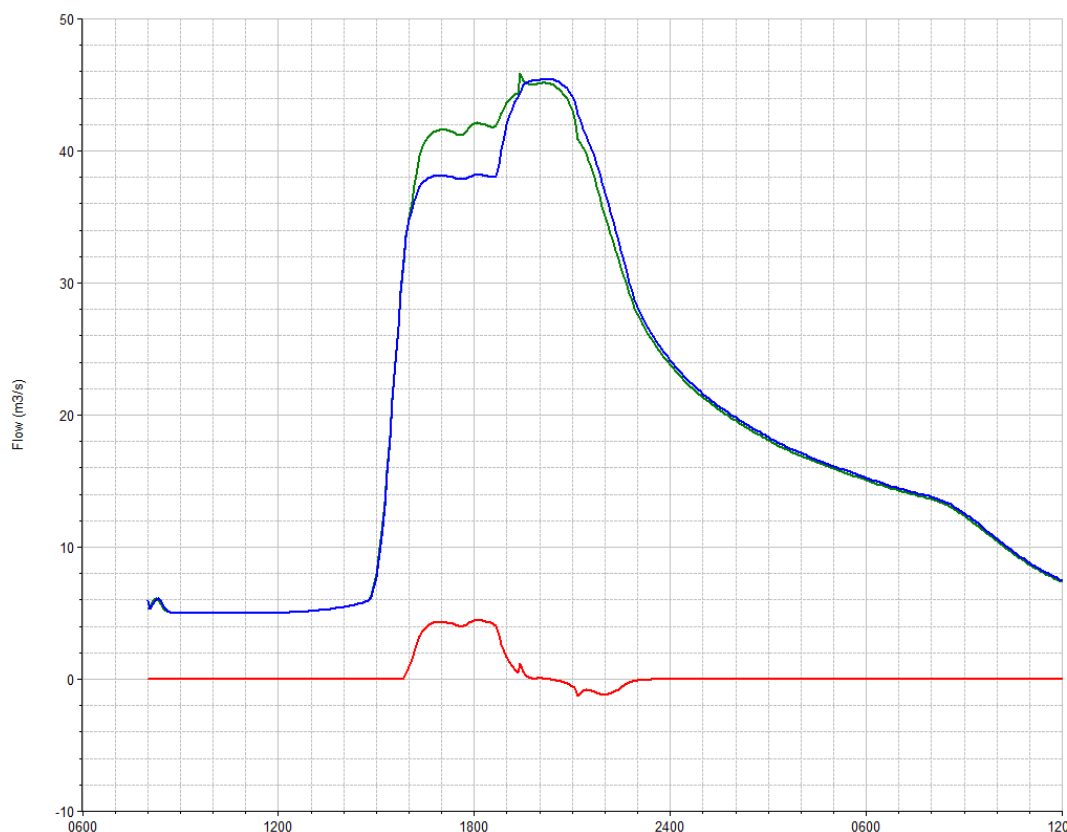
Figura 68 – Area 4 - Idrogramma a monte dello sfioro (verde), idrogramma a valle dello sfioro (blu) e idrogramma entrante nell'area golenale (rosso) per T=100 anni progetto con assetto attuale dell'alveo a monte del tratto di intervento
