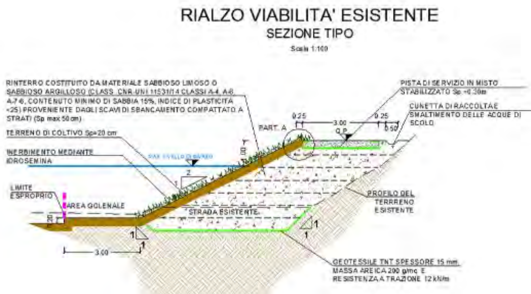
Figura 17 – Sezione tipo di rialzo della viabilità esistente
