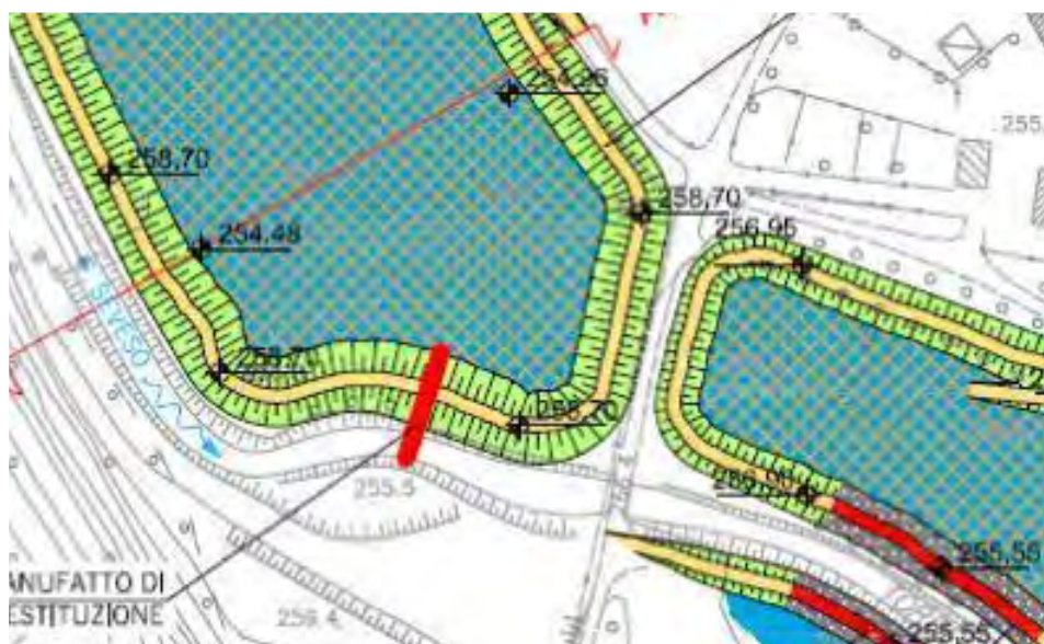
Figura 30 – Particolare della separazione tra area golenale 1 e 2 sinistra nel progetto preliminare
