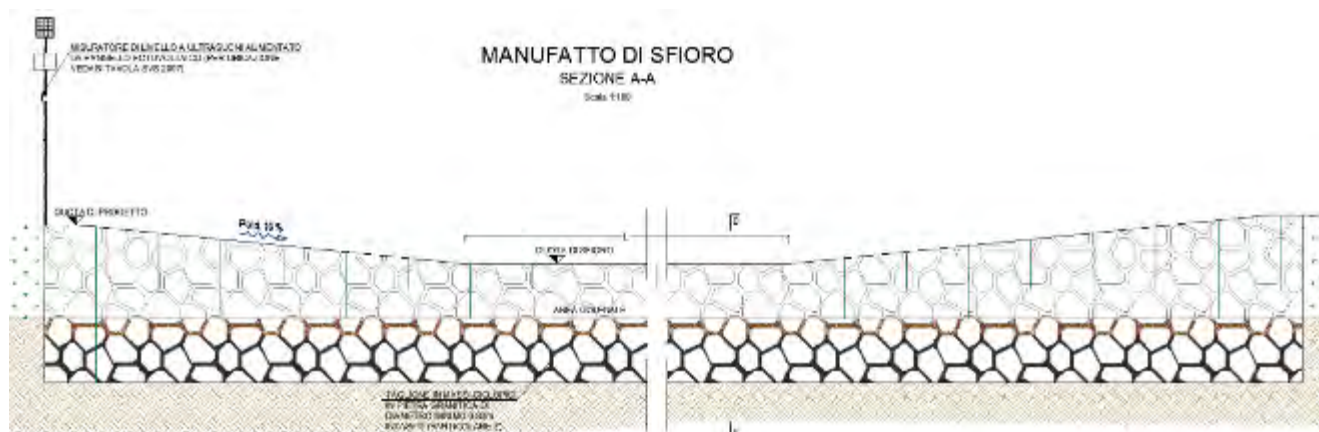
Figura 12 – Sezione tipo longitudinale dello sfioratore di alimentazione delle aree golenali
