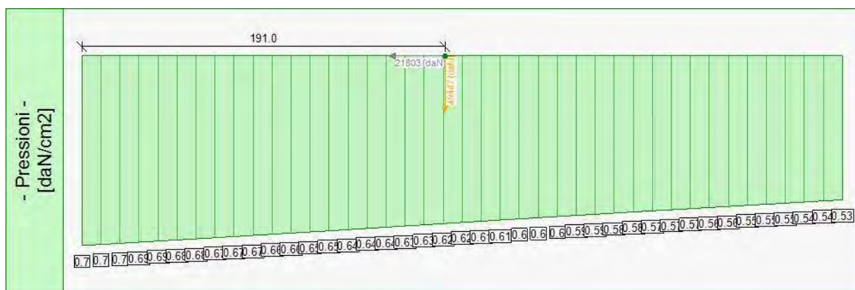
Forze (totali) e Pressioni lungo il fusto, per il Caso 6 ( RARA [ Caratteristica ] - SLE caratteristica (rara) )
