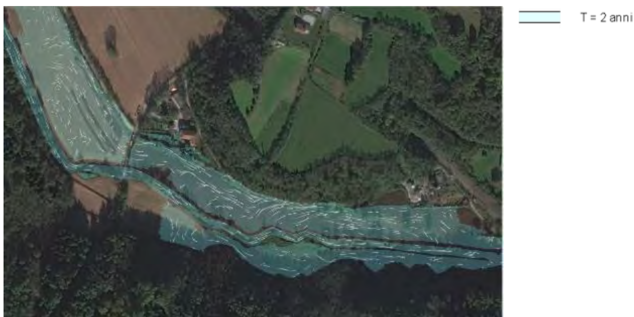
Figura 32 – Planimetria degli allagamenti stato di fatto T=2 anni con frecce di direzione e velocità della corrente
