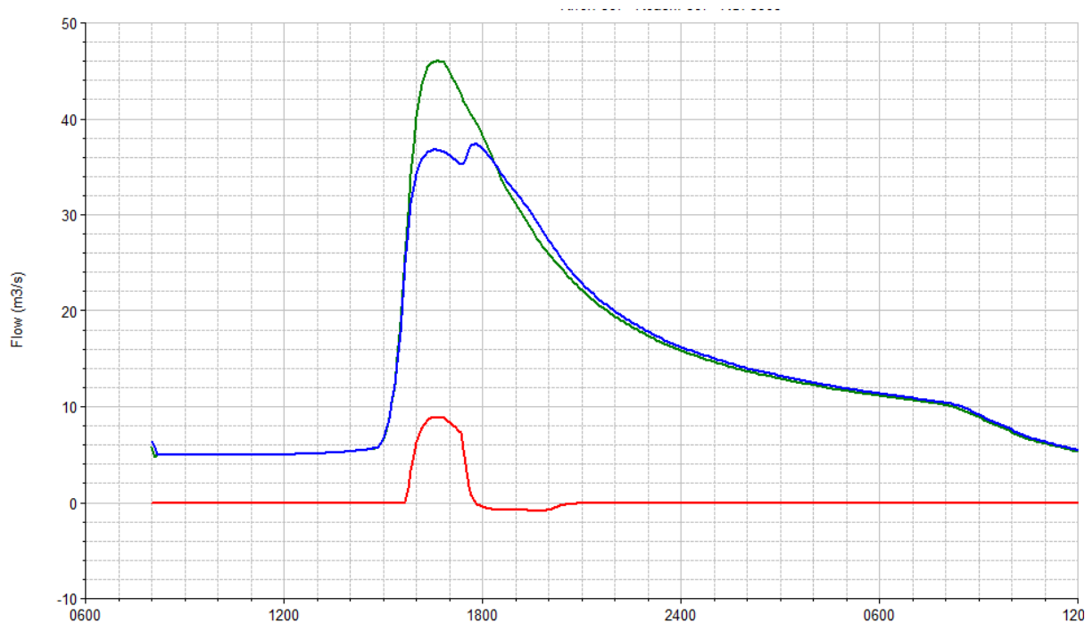
Figura 57 – Area 2 sinistra - Idrogramma a monte dello sfioro (verde), idrogramma a valle dello sfioro (blu) e idrogramma entrante nell'area golenale (rosso) per T=100 anni progetto con assetto futuro dell'alveo a monte del tratto di intervento
