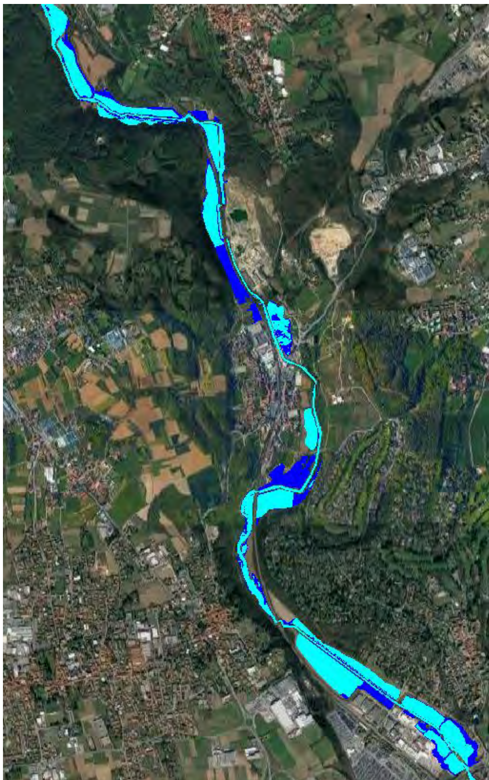
Figura 86 – Confronto tra aree di allagamento T100 anni con l'assetto futuro dell'alveo a monte (realizzate vasche nella parte alta del bacino) tra stato di fatto (blu) e assetto di progetto (azzurro)
