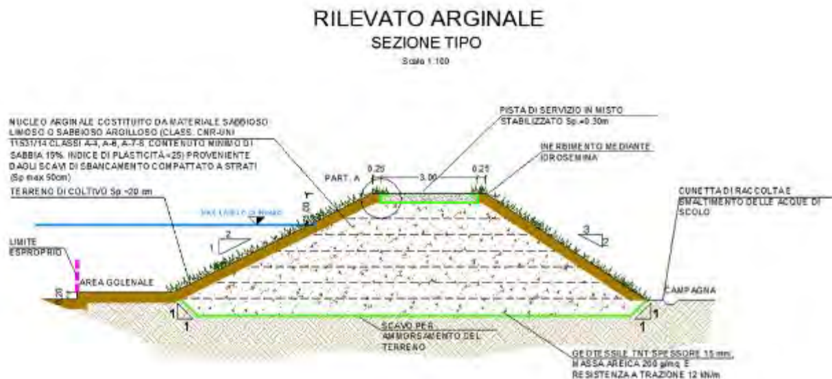
Figura 16 – Sezione tipo di ringrosso e nuovo rilevato arginale
