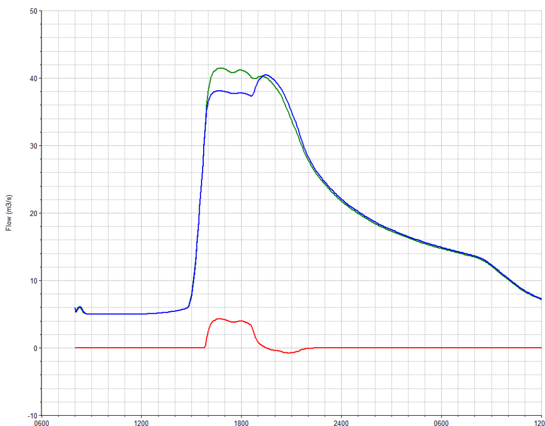
Figura 69 – Area 4 - Idrogramma a monte dello sfioro (verde), idrogramma a valle dello sfioro (blu) e idrogramma entrante nell'area golenale (rosso) per T=100 anni progetto con assetto futuro dell'alveo a monte del tratto di intervento
