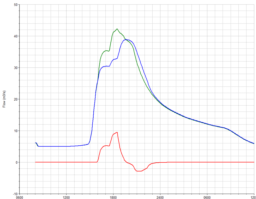
Figura 63 – Area 3 - Idrogramma a monte dello sfioro (verde), idrogramma a valle dello sfioro (blu) e idrogramma entrante nell'area golenale (rosso) per T=100 anni progetto con assetto attuale dell'alveo a monte del tratto di intervento
