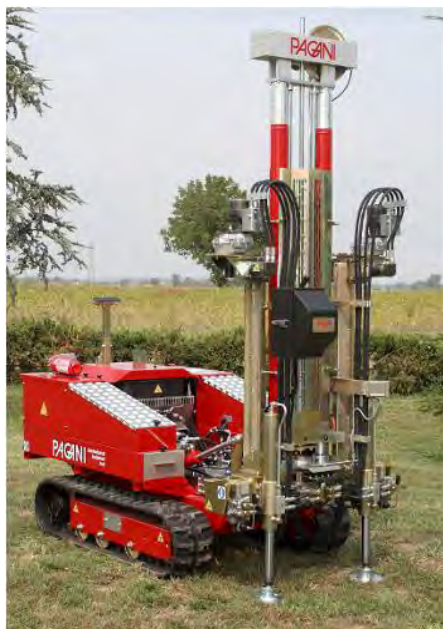
Fig. 3.1. Penetrometro PAGANI modello TG 63-100
