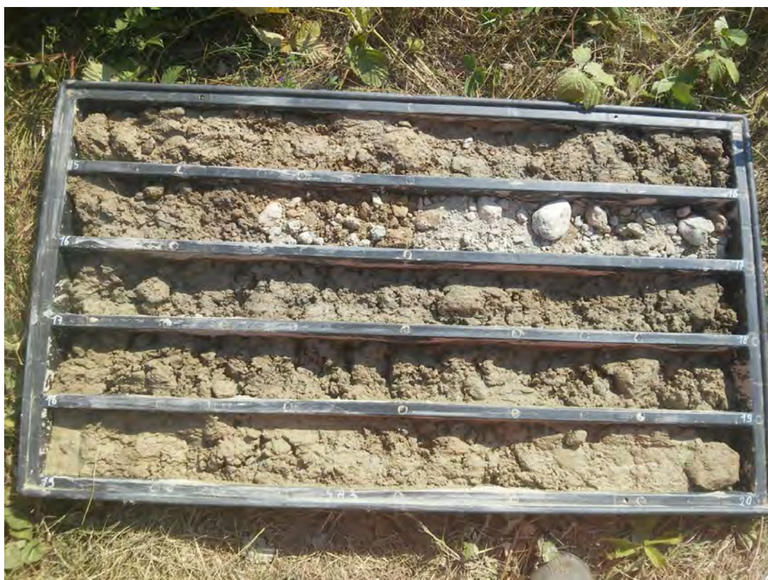
SONDAGGIO SA3 – Cassa n.4 da 15.00 m a 20.00 m
