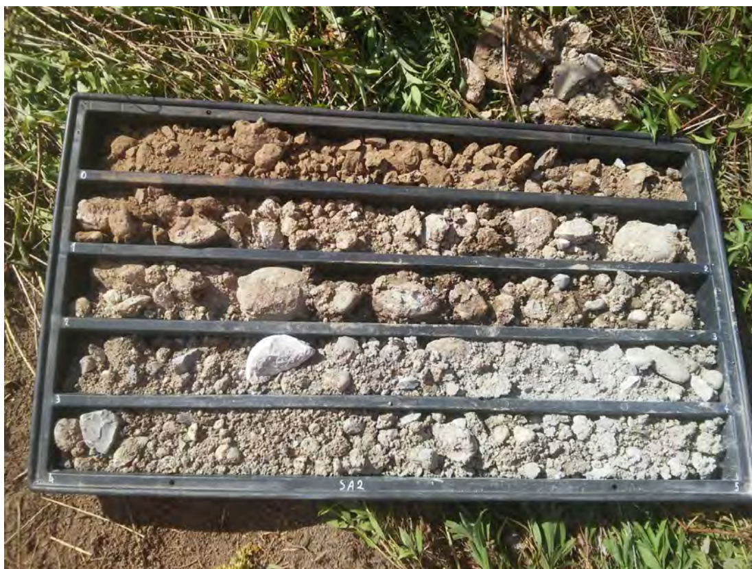
SONDAGGIO SA2 – Cassa n.1 da 0.00 m a 5.00 m
