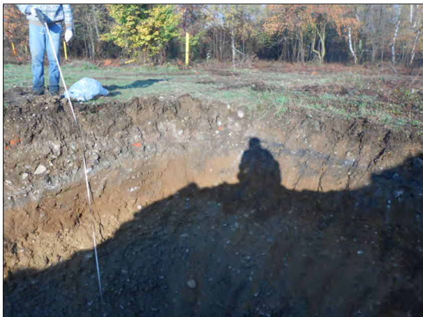
Particolare del primo livello identificato come riporto
