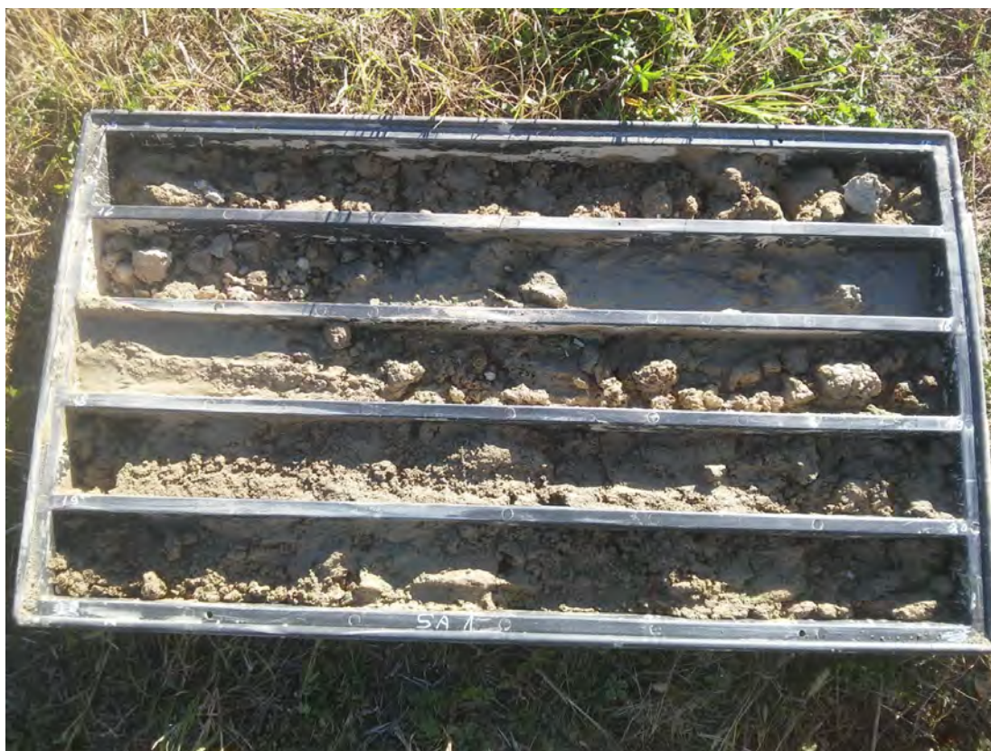
SONDAGGIO SA1 – Cassa n.4 da 15.00 m a 20.00 m
