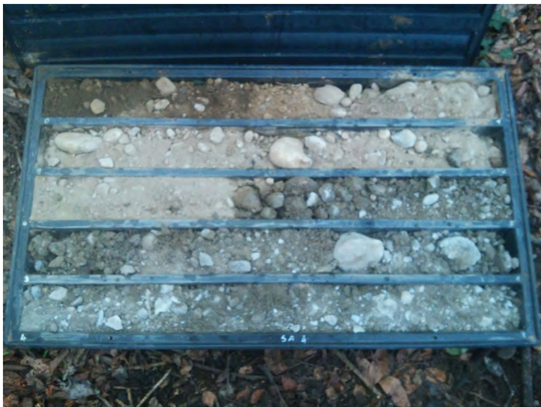
SONDAGGIO SA4 – Cassa n.1 da 0.00 m a 5.00 m
