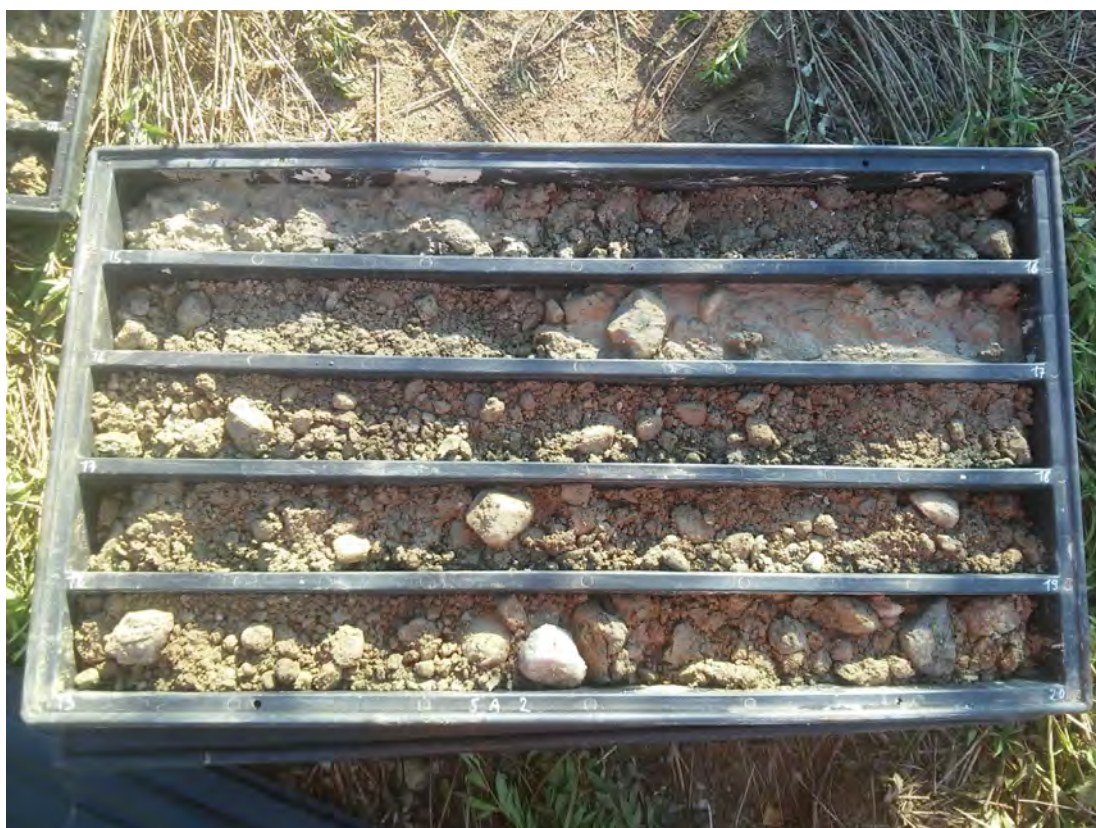
SONDAGGIO SA2 – Cassa n.4 da 15.00 m a 20.00 m
