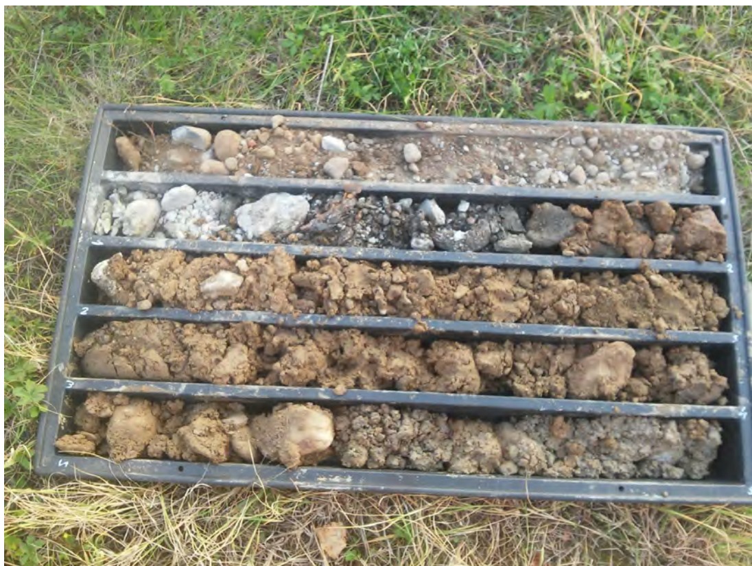
SONDAGGIO SA1 – Cassa n.1 da 0.00 m a 5.00 m
