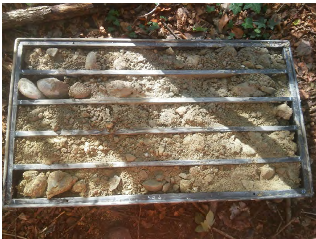
SONDAGGIO SA4 – Cassa n.2 da 5.00 m a 10.00 m
