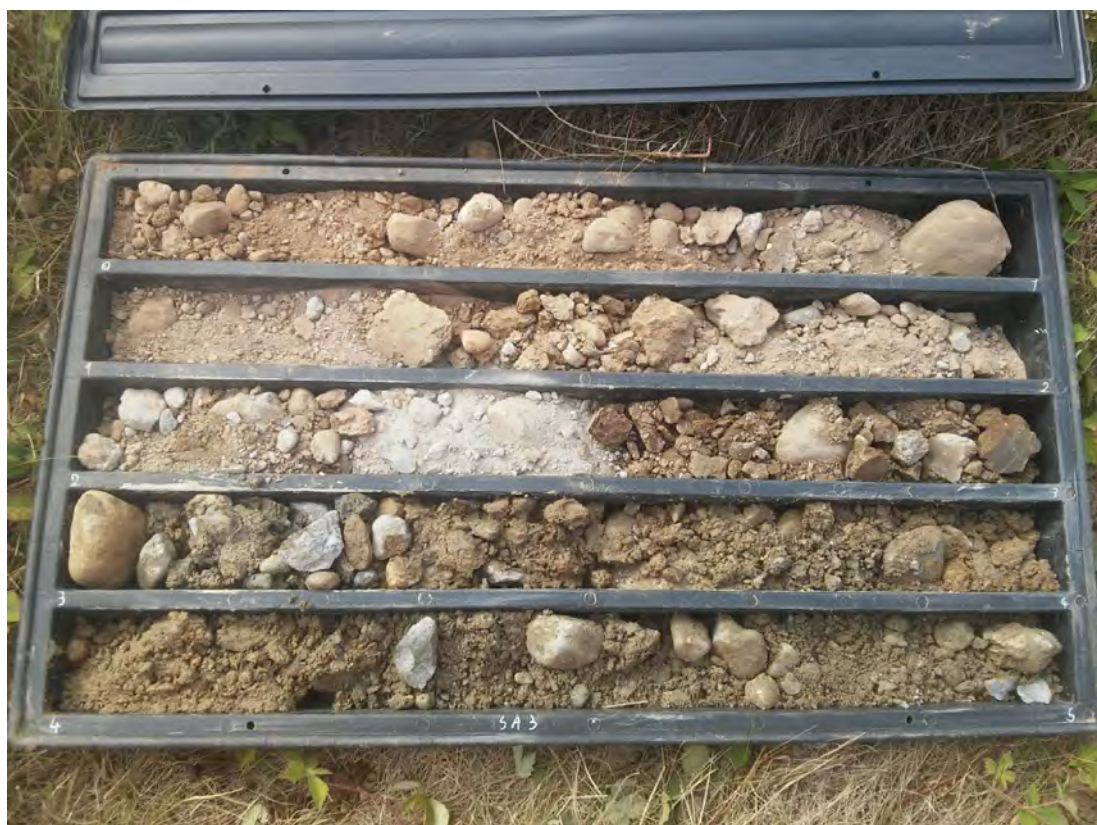
SONDAGGIO SA3 – Cassa n.1 da 0.00 m a 5.00 m
