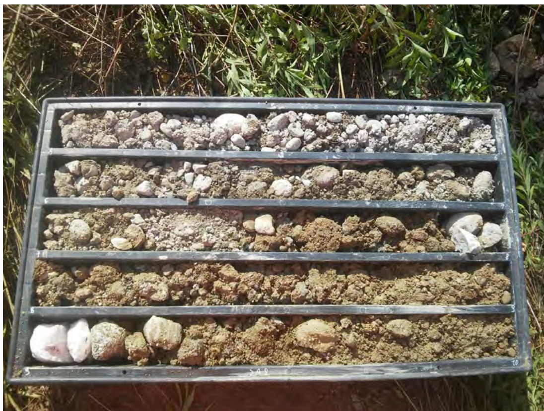
SONDAGGIO SA2 – Cassa n.2 da 5.00 m a 10.00 m
