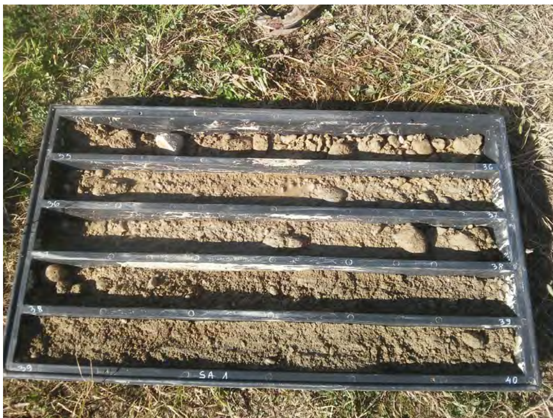
SONDAGGIO SA1 – Cassa n.8 da 35.00 m a 40.00 m
