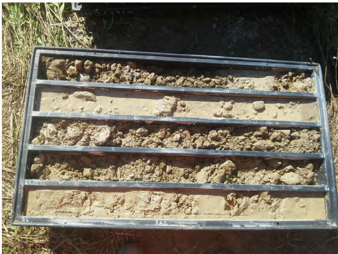
SONDAGGIO SA2 – Cassa n.9 da 40.00 m a 45.00 m
