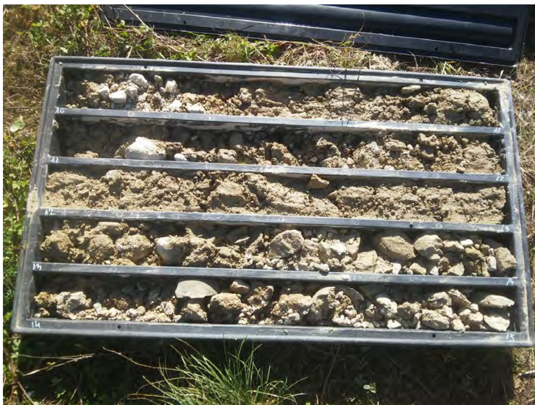
SONDAGGIO SA1 – Cassa n.3 da 10.00 m a 15.00 m
