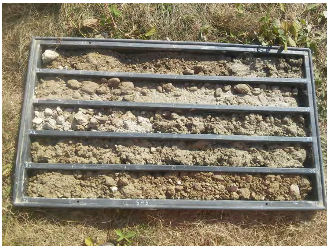
SONDAGGIO SA3 – Cassa n.5 da 20.00 m a 25.00 m
