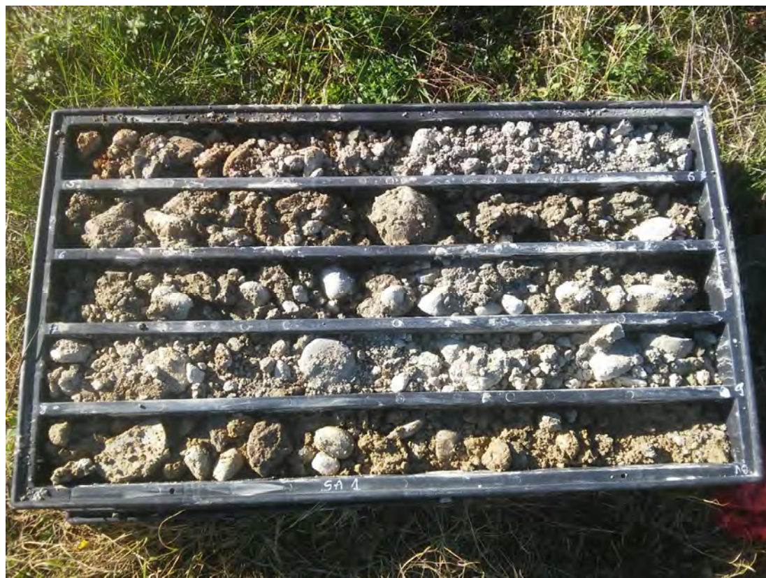
SONDAGGIO SA1 – Cassa n.2 da 5.00 m a 10.00 m
