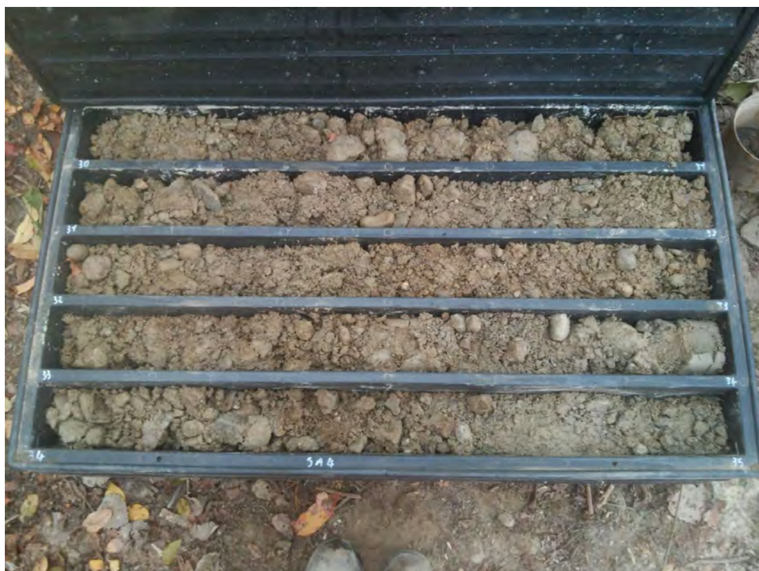
SONDAGGIO SA4 – Cassa n.7 da 30.00 m a 35.00 m
