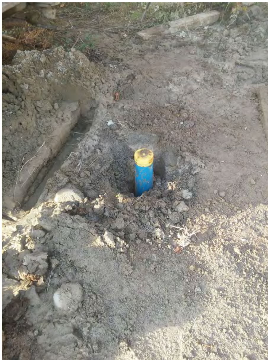
SONDAGGIO SA2 – Piezometro
