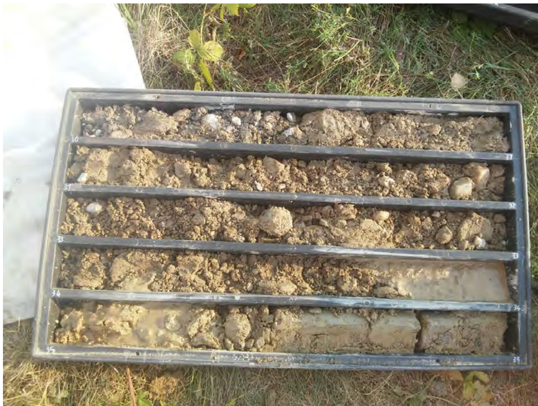
SONDAGGIO SA3 – Cassa n.7 da 30.00 m a 35.00 m
