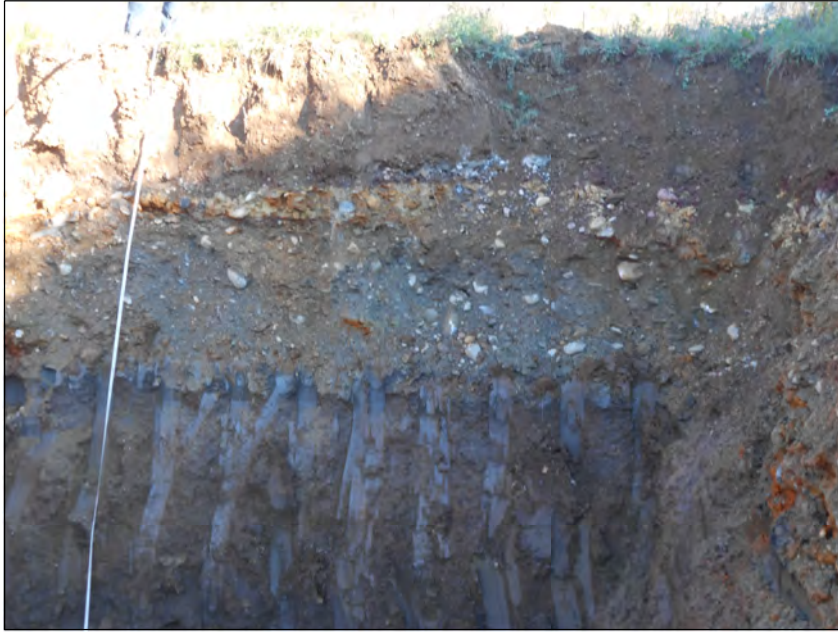
Particolare del primo livello identificato come riporto
