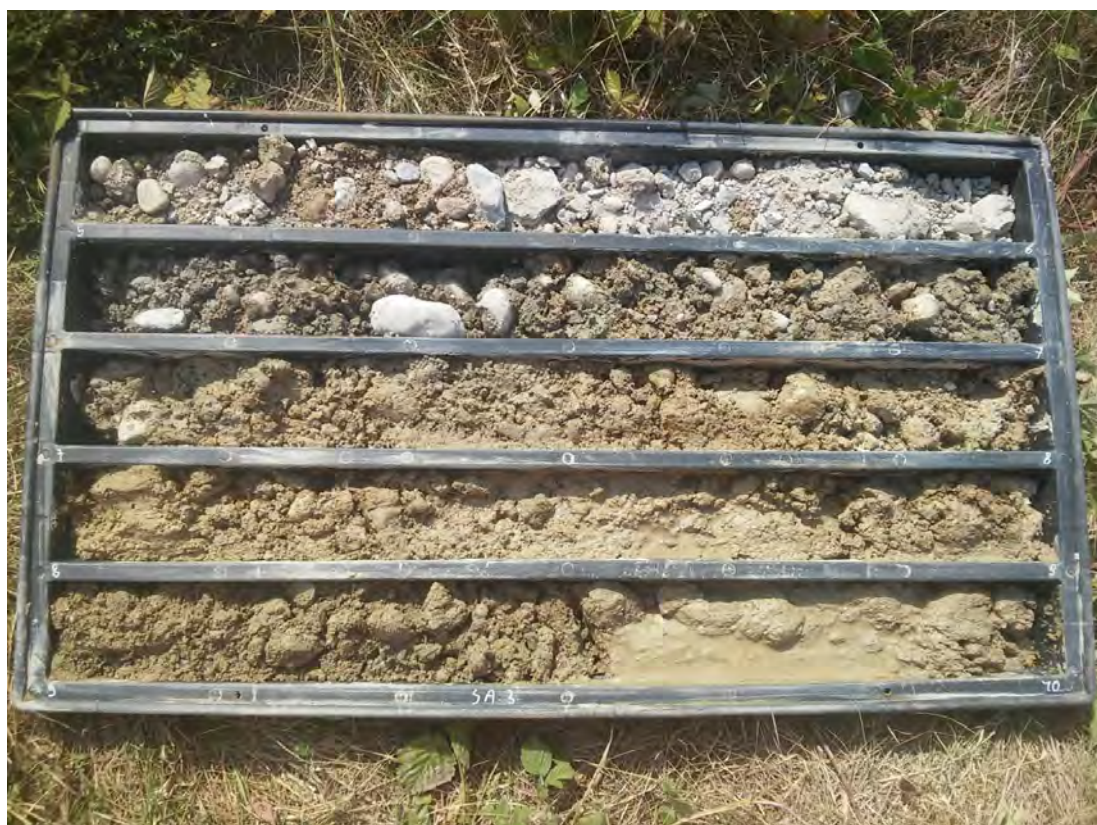
SONDAGGIO SA3 – Cassa n.2 da 5.00 m a 10.00 m
