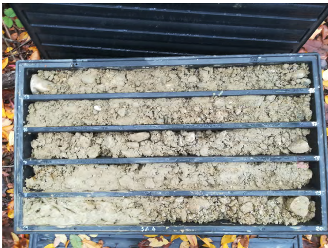
SONDAGGIO SA4 – Cassa n.4 da 15.00 m a 20.00 m
