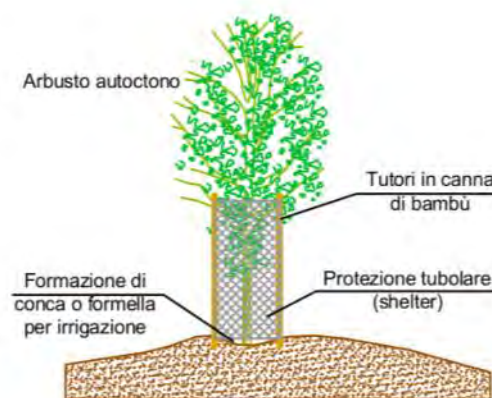
Figura 22 – Modalità di messa a dimora piantina forestale.
