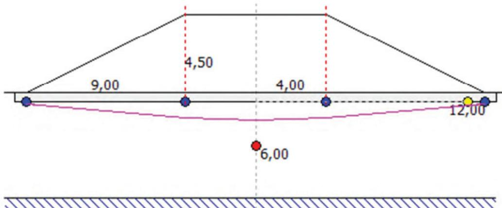
**Fig. 84 Punti di calcolo dei cedimenti lungo la sezione ST071\_SX**
