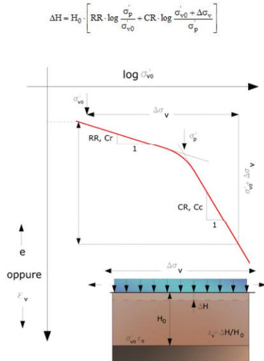
**Fig. 83 Cedimento edometrico**
