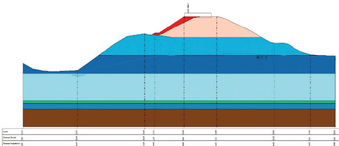
Fig. 11 Schematizzazione della sezione oggetto di verifica di stabilità
