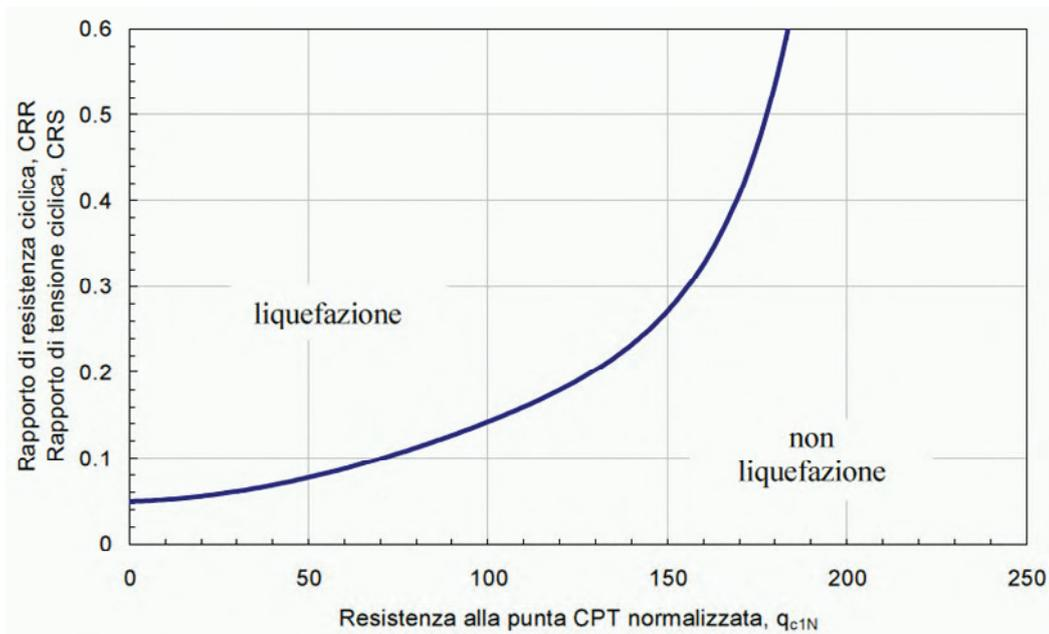
**Fig. 79** Carte per la stima della resistenza normalizzata alla liquefazione CRR di un terreno sabbioso saturo in funzione dei valori di resistenza alla punta  $q_c$  (D.A.L. 112/2007).
