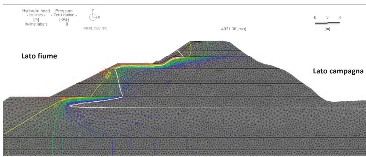
**Fig. 58 Verifica alla filtrazione in stato transitorio**
