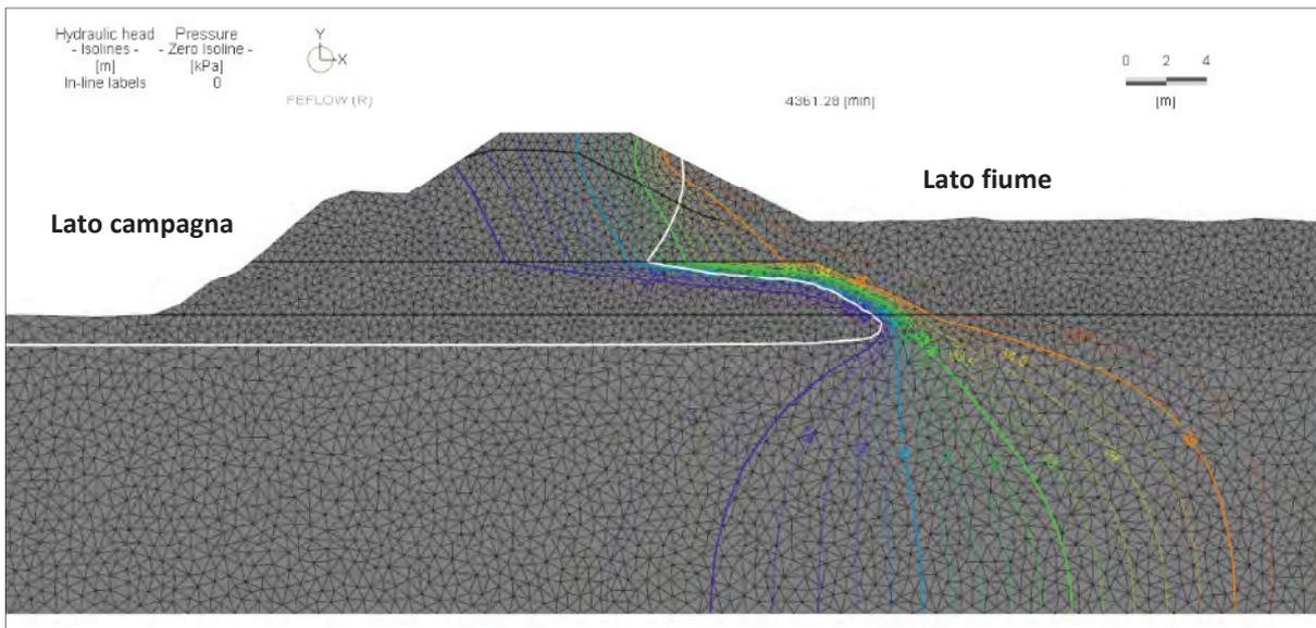
**Fig. 56** Verifica alla filtrazione in stato transitorio
