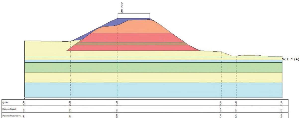
**Fig. 49** Schematizzazione della sezione oggetto di verifica di stabilità
