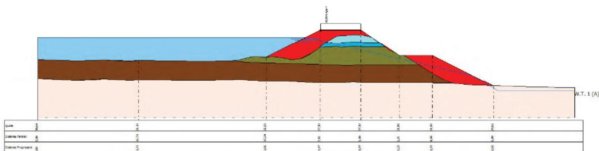
**Fig. 32 Schematizzazione della sezione oggetto di verifica di stabilità**
