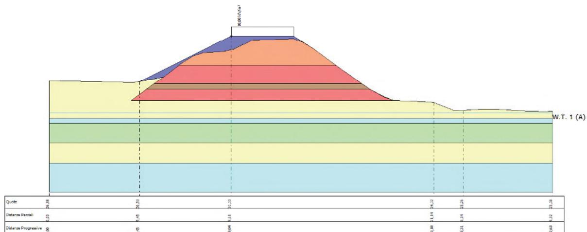
Fig. 16 Schematizzazione della sezione oggetto di verifica di stabilità
