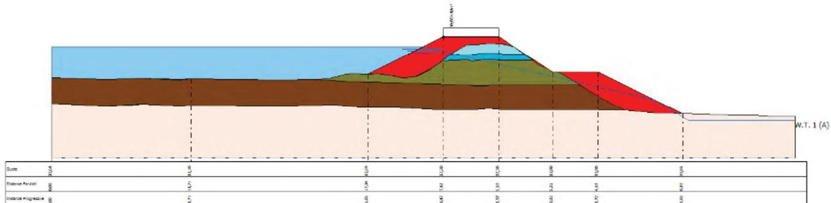
Fig. 9 Schematizzazione della sezione oggetto di verifica di stabilità
