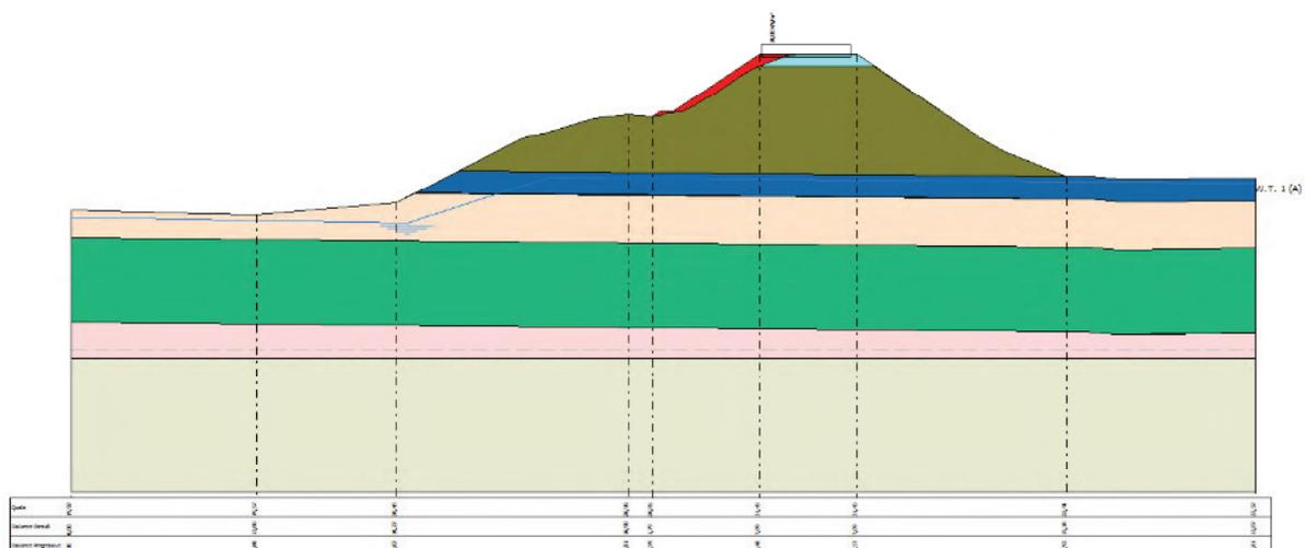
Fig. 65 Schematizzazione della sezione oggetto di verifica di stabilità
