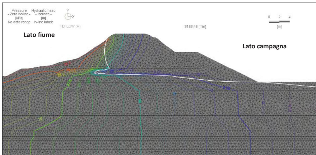
**Fig. 47 Verifica alla filtrazione in stato transitorio**
