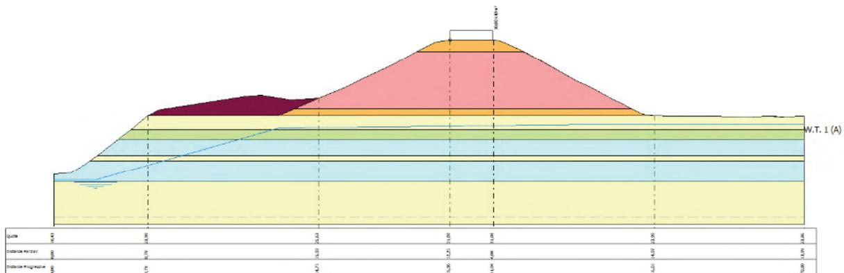
Fig. 25 Schematizzazione della sezione oggetto di verifica di stabilità
