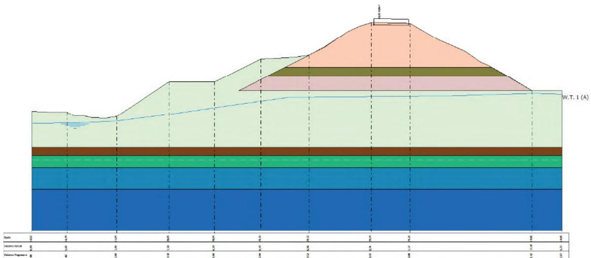
**Fig. 75 Schematizzazione della sezione oggetto di verifica di stabilità**
