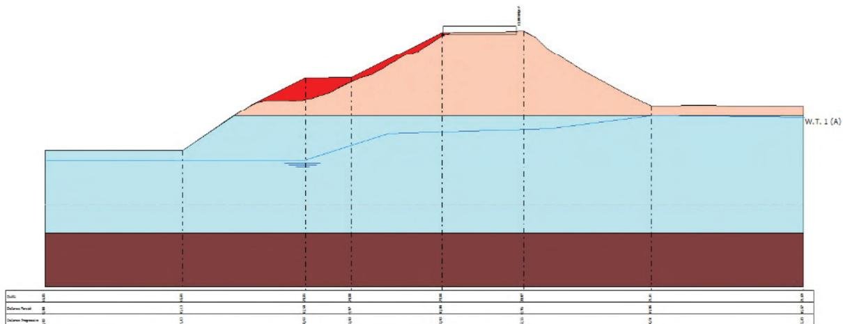
Fig. 27 Schematizzazione della sezione oggetto di verifica di stabilità
