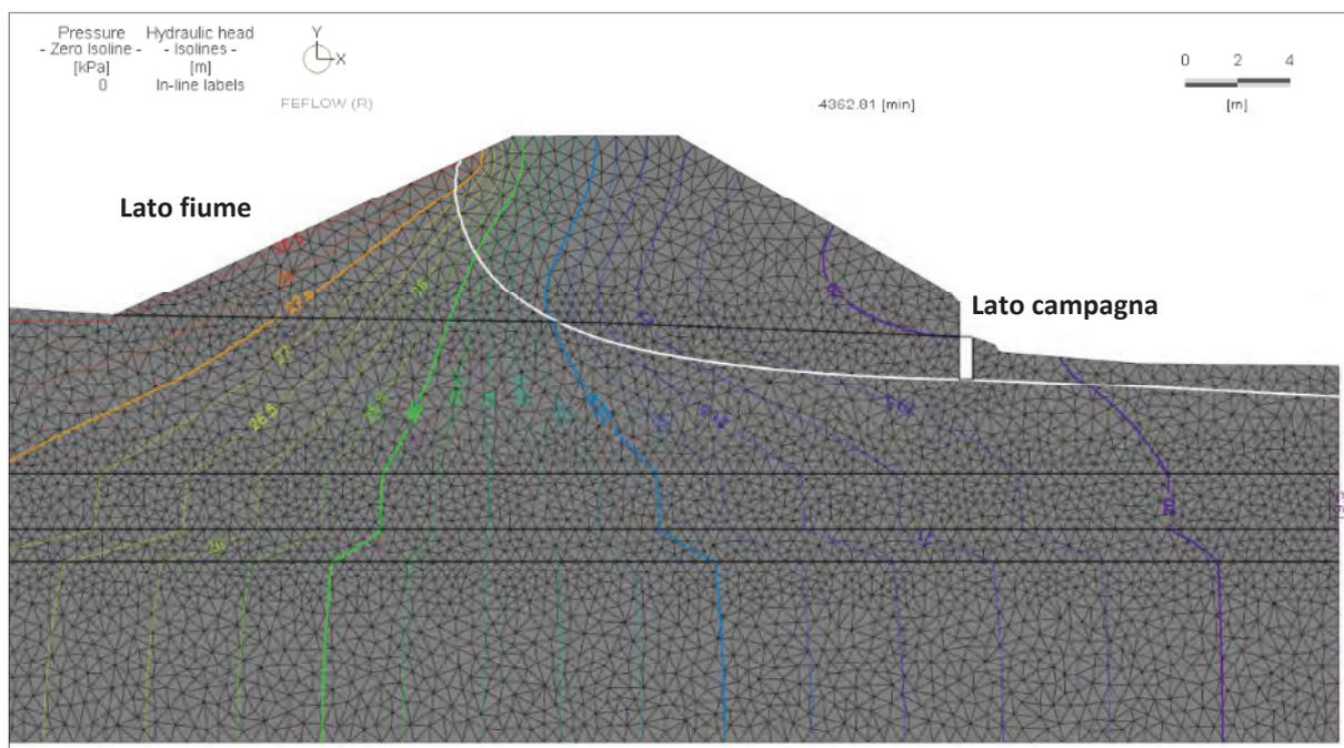
**Fig. 74 Verifica alla filtrazione in stato transitorio**
