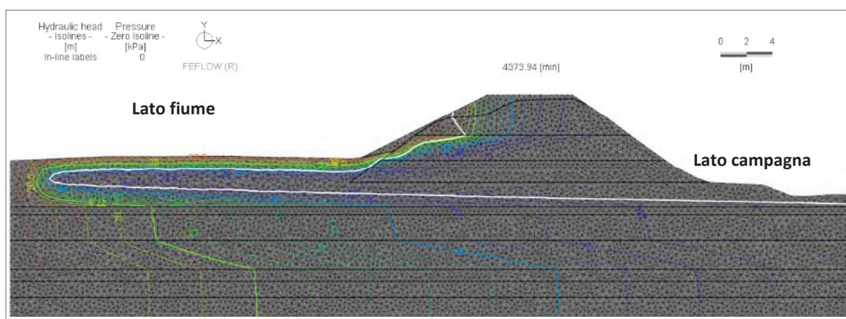
**Fig. 50 Verifica alla filtrazione in stato transitorio**
