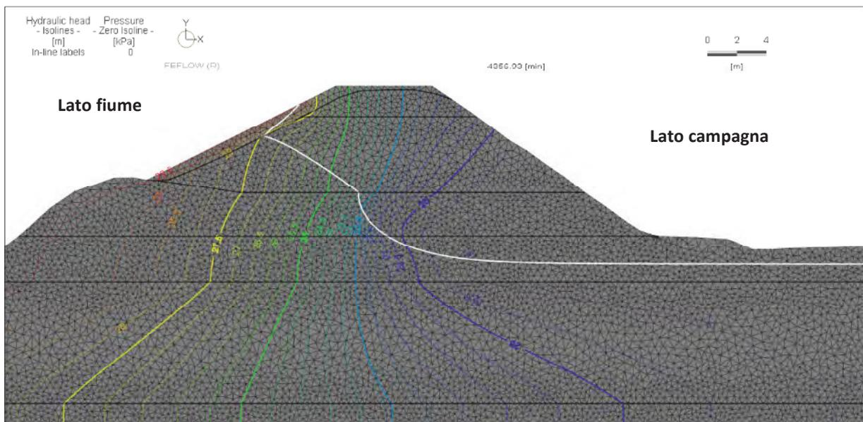
**Fig. 52** Verifica alla filtrazione in stato transitorio
