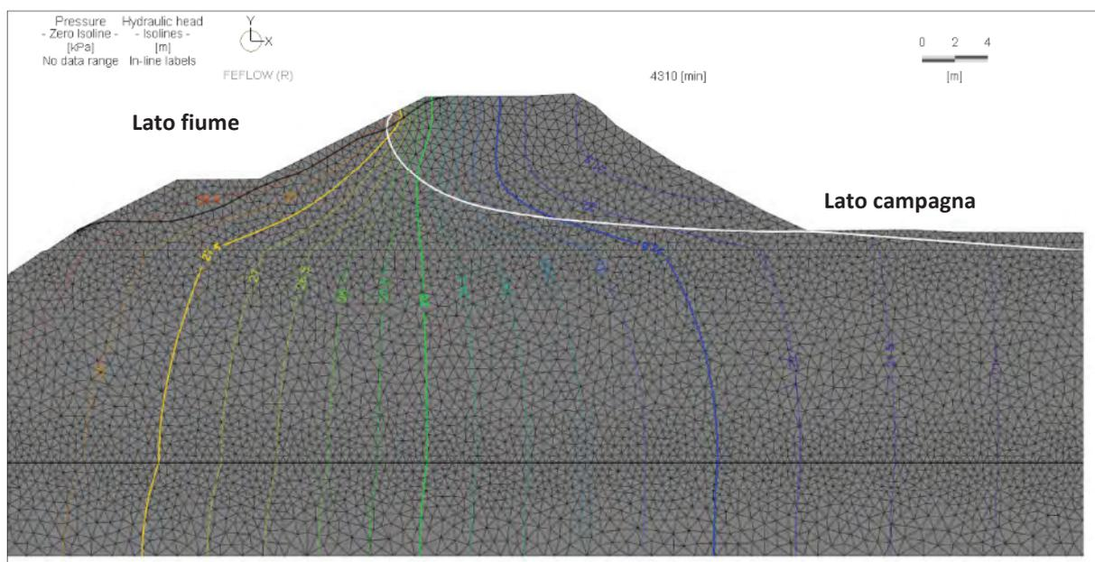
**Fig. 72 Verifica alla filtrazione in stato transitorio**
