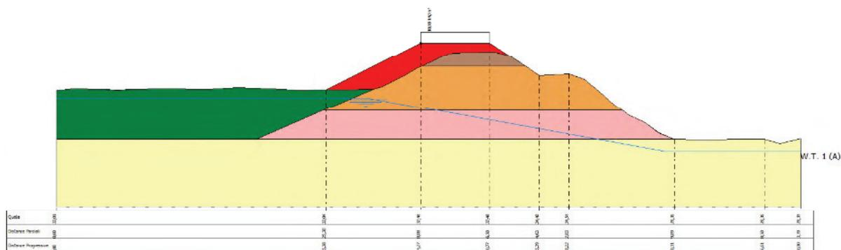
**Fig. 19 Schematizzazione della sezione oggetto di verifica di stabilità**
