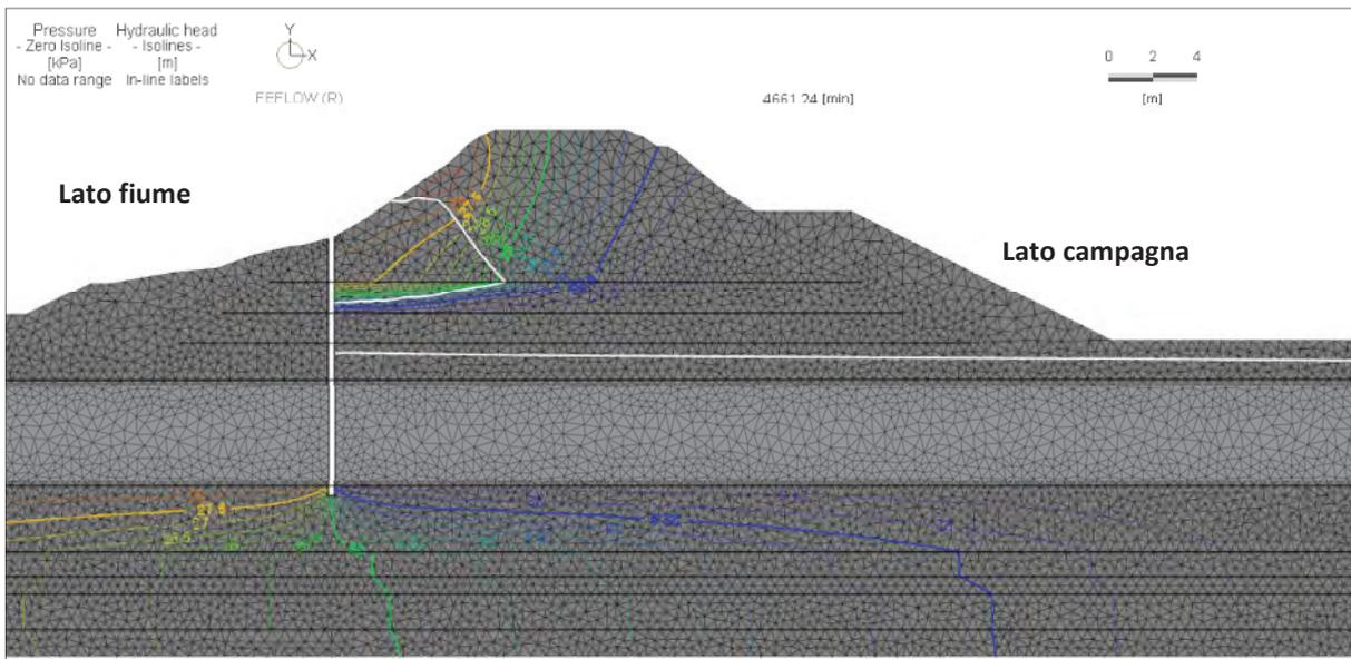
**Fig. 48** Verifica alla filtrazione in stato transitorio a seguito dell’inserimento degli interventi in progetto
