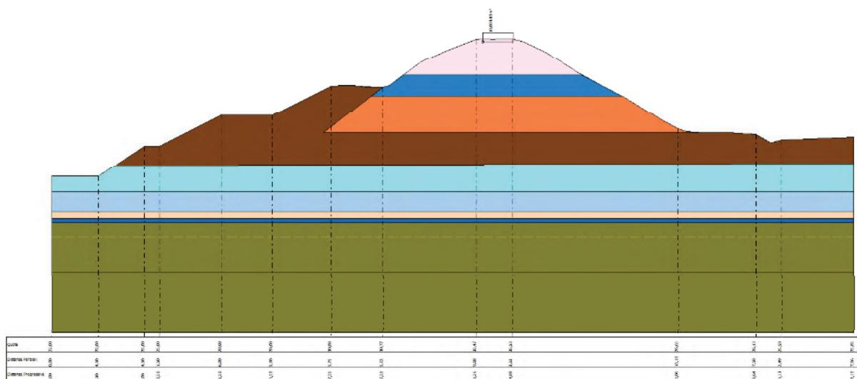
**Fig. 38 Schematizzazione della sezione oggetto di verifica di stabilità**
