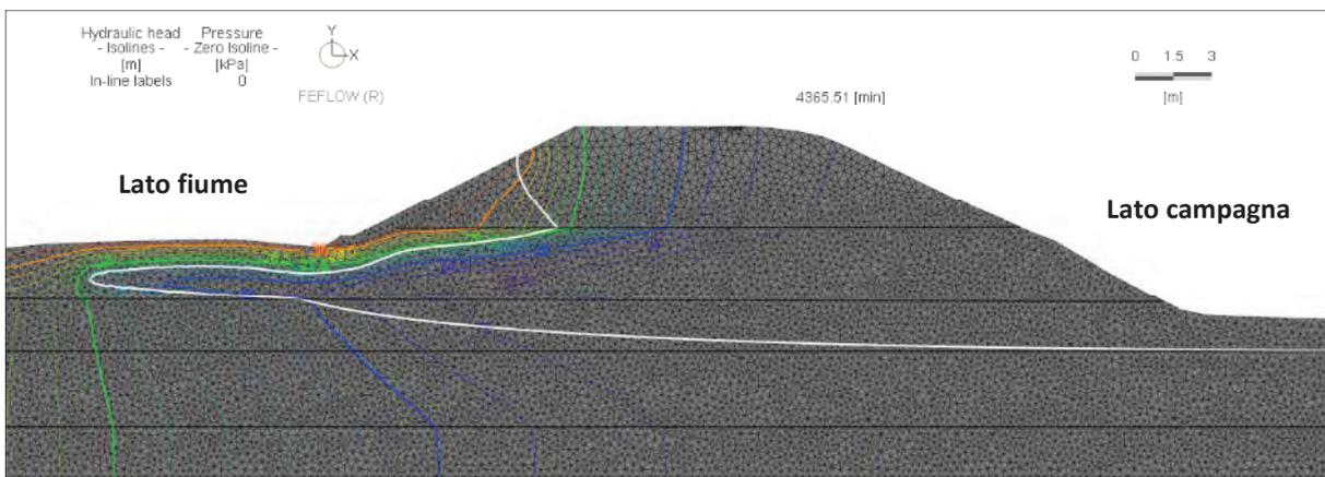
**Fig. 60** Verifica alla filtrazione in stato transitorio
