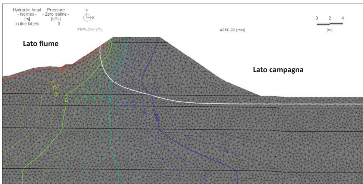
**Fig. 66 Verifica alla filtrazione in stato transitorio**
