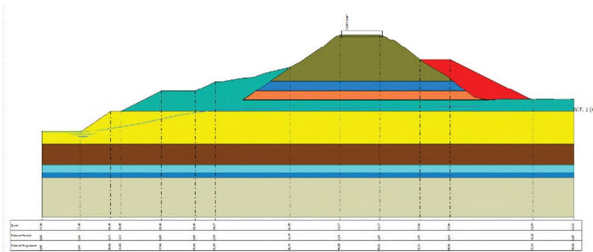
**Fig. 46** Schematizzazione della sezione oggetto di verifica di stabilità
