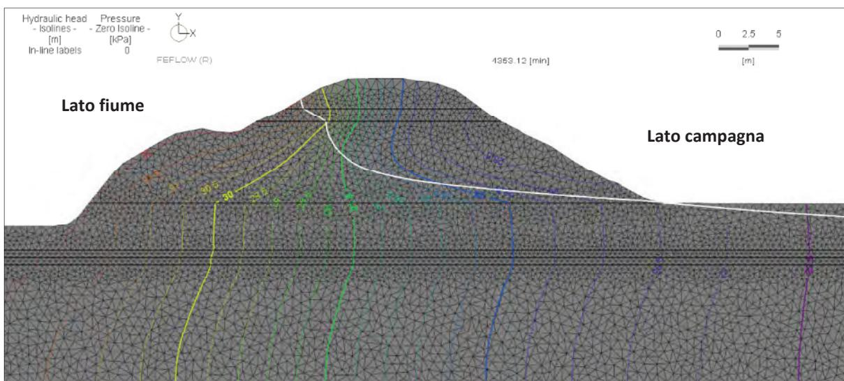
**Fig. 42** Verifica alla filtrazione in stato transitorio
