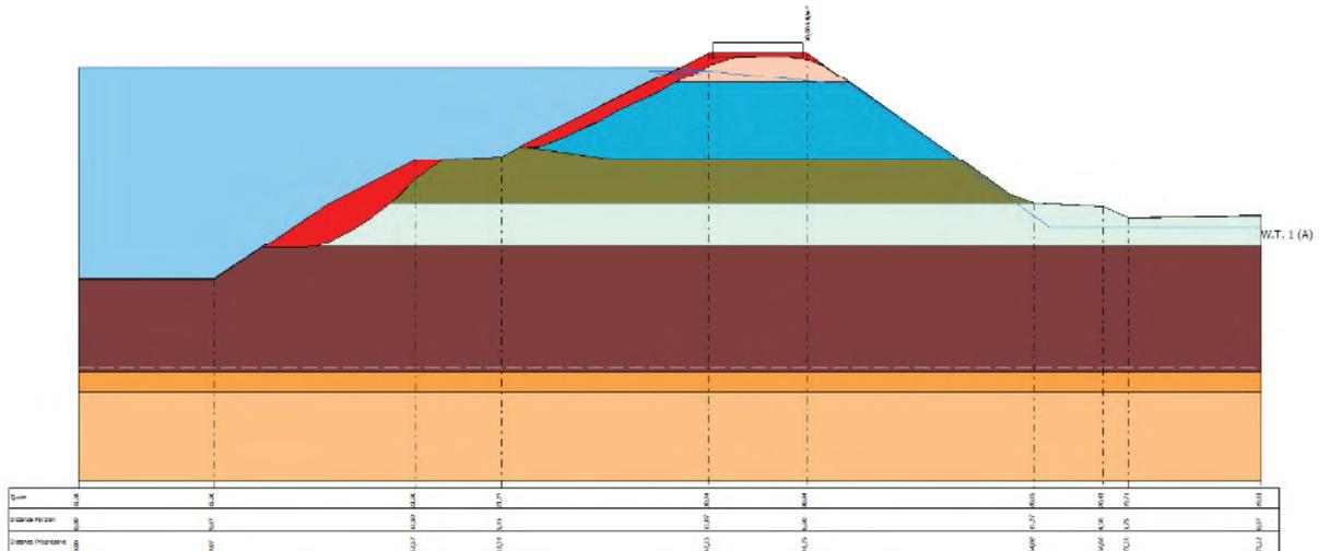
**Fig. 51 Schematizzazione della sezione oggetto di verifica di stabilità**
