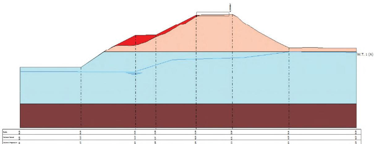
**Fig. 71 Schematizzazione della sezione oggetto di verifica di stabilità**
