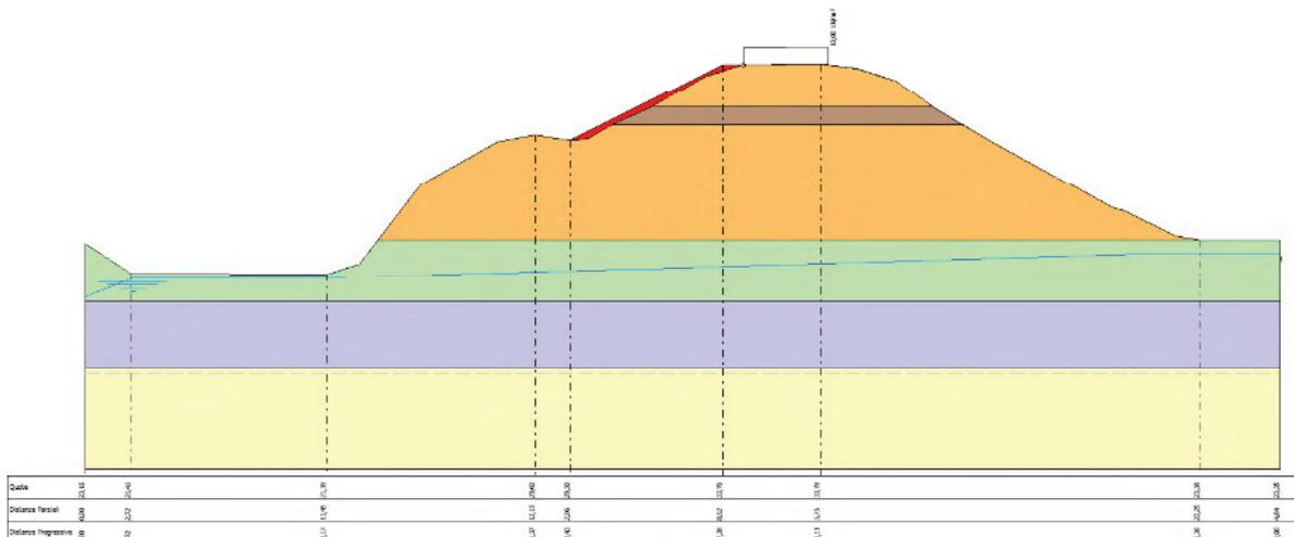
**Fig. 13 Schematizzazione della sezione oggetto di verifica di stabilità**
