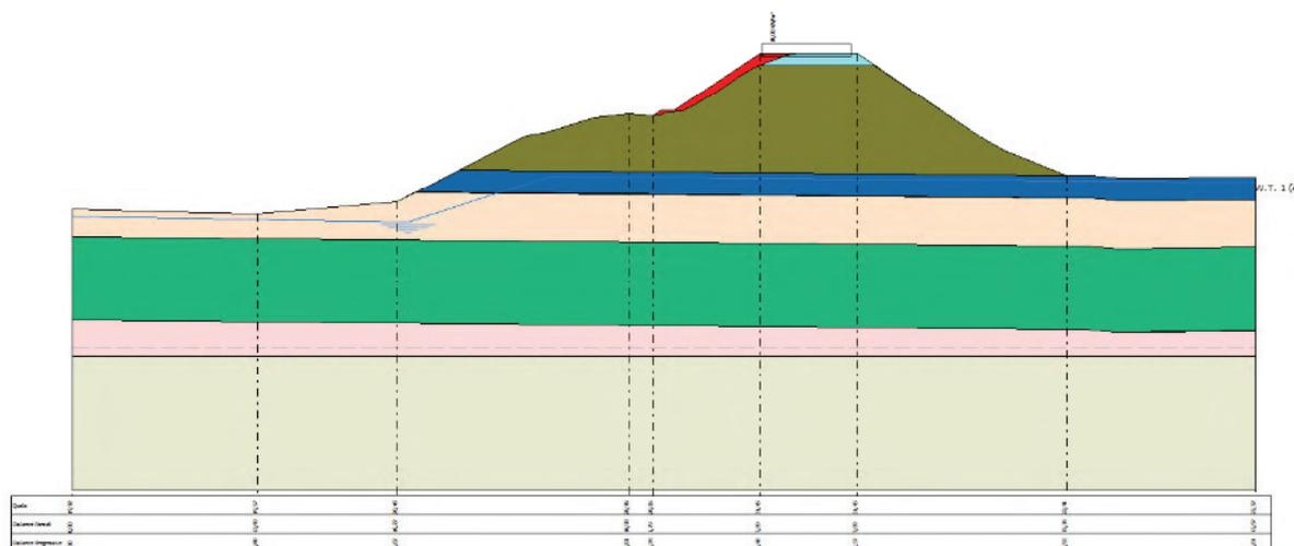
**Fig. 24** Schematizzazione della sezione oggetto di verifica di stabilità
