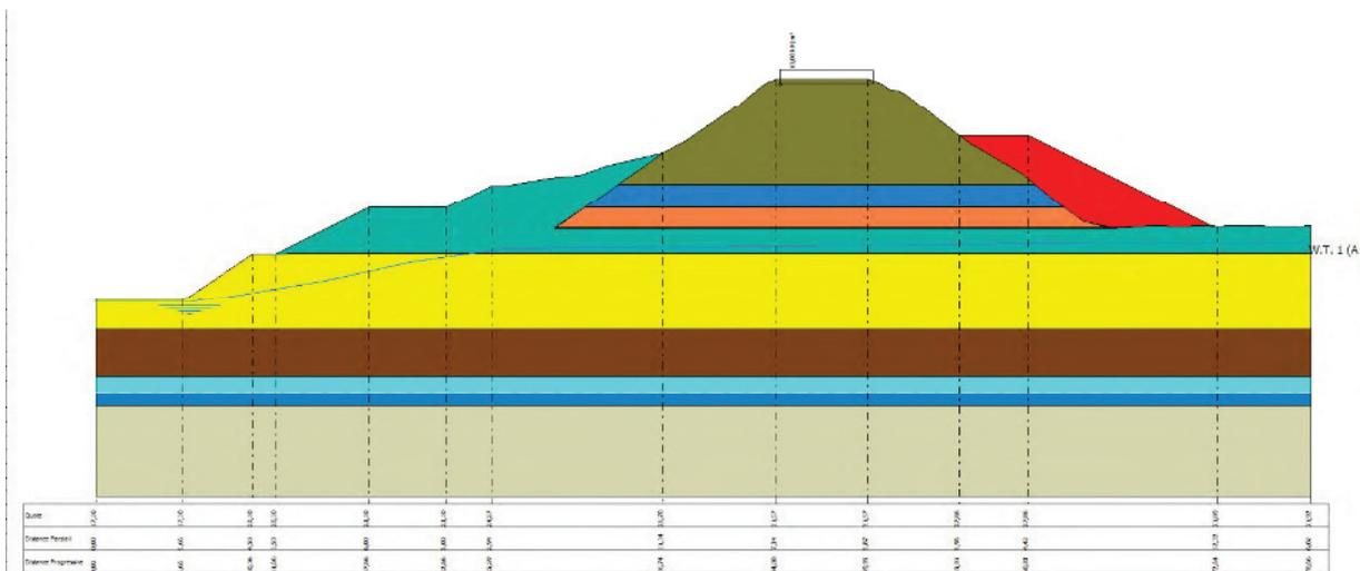
Fig. 15 Schematizzazione della sezione oggetto di verifica di stabilità
