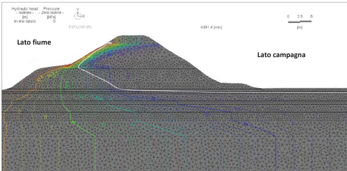
Fig. 54 Verifica alla filtrazione in stato transitorio
