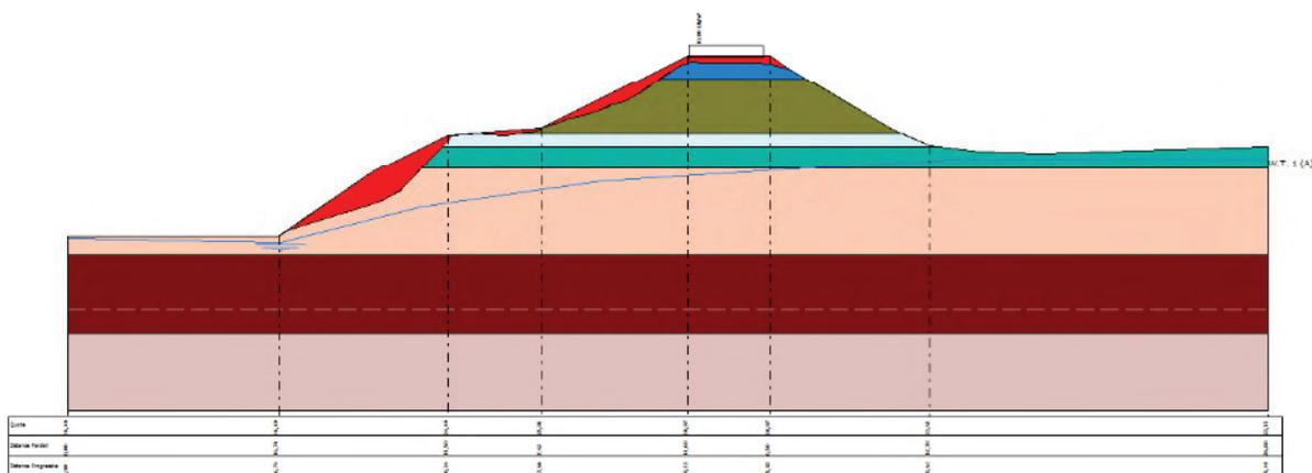
**Fig. 69** Schematizzazione della sezione oggetto di verifica di stabilità
