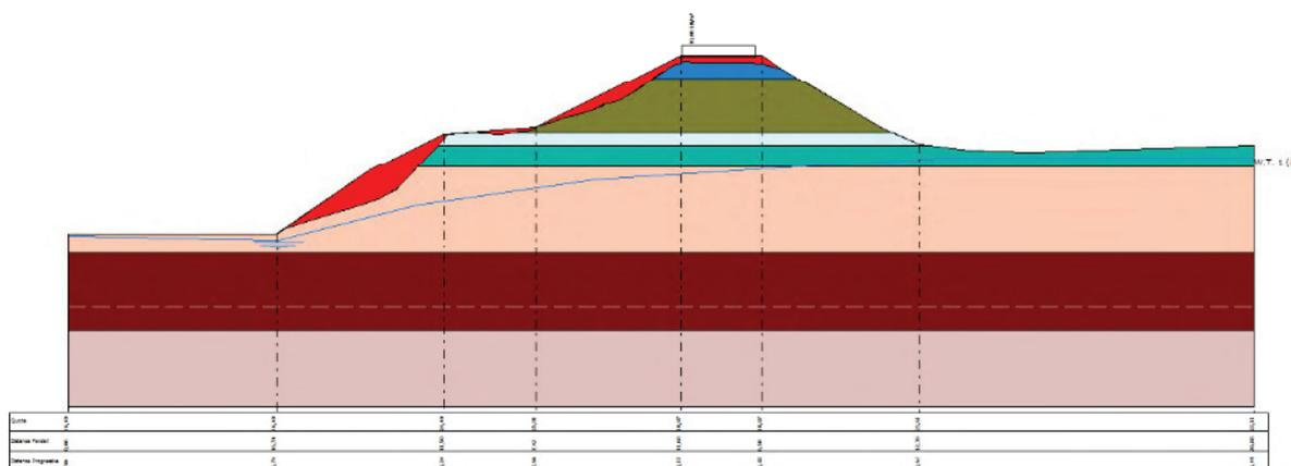
Fig. 26 Schematizzazione della sezione oggetto di verifica di stabilità
