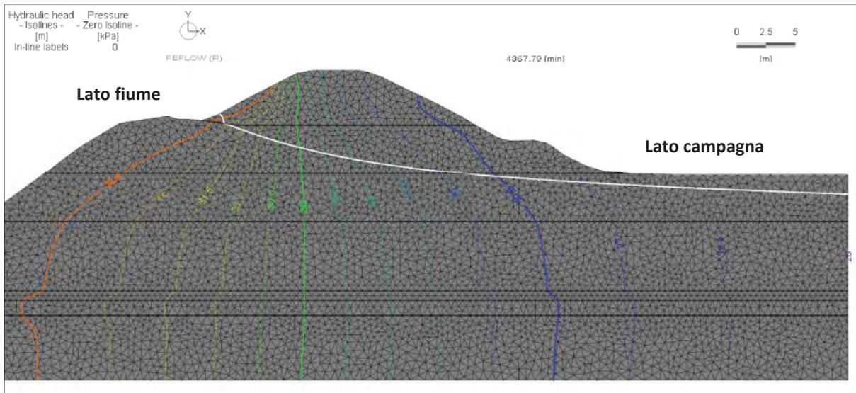
**Fig. 37** Verifica alla filtrazione in stato transitorio
