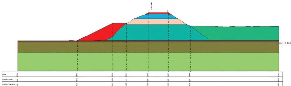
**Fig. 44** Schematizzazione della sezione oggetto di verifica di stabilità
