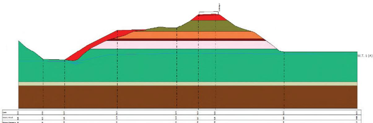
**Fig. 20 Schematizzazione della sezione oggetto di verifica di stabilità**
