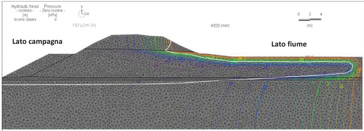
Fig. 64 Verifica alla filtrazione in stato transitorio
