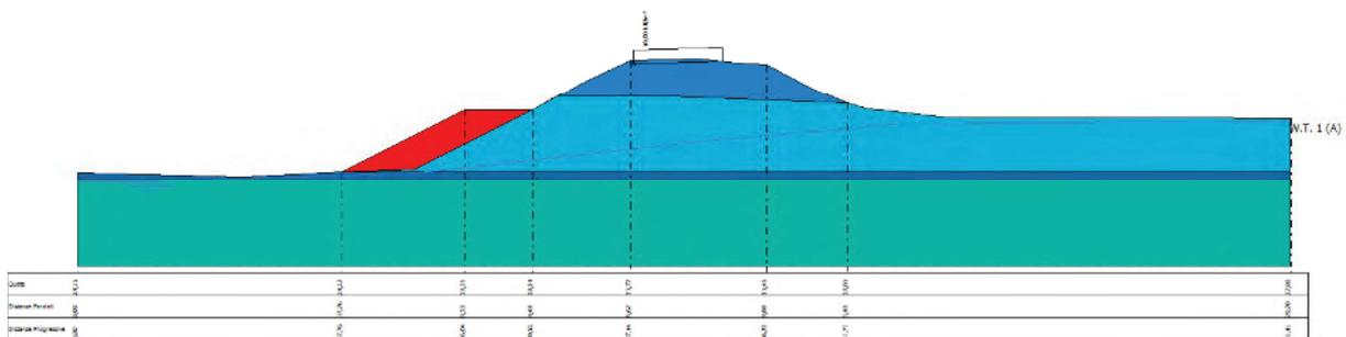
Fig. 23 Schematizzazione della sezione oggetto di verifica di stabilità
