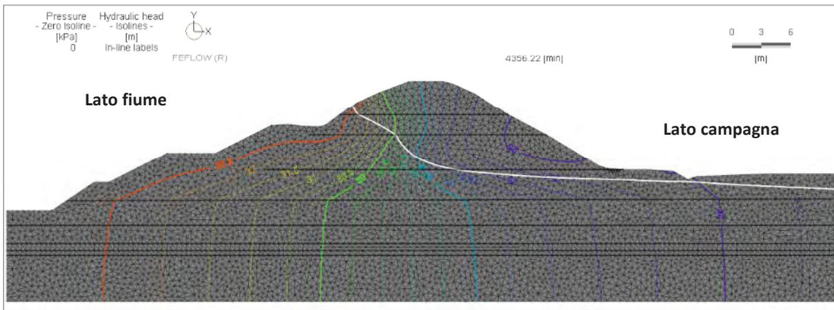
**Fig. 39 Verifica alla filtrazione in stato transitorio**
