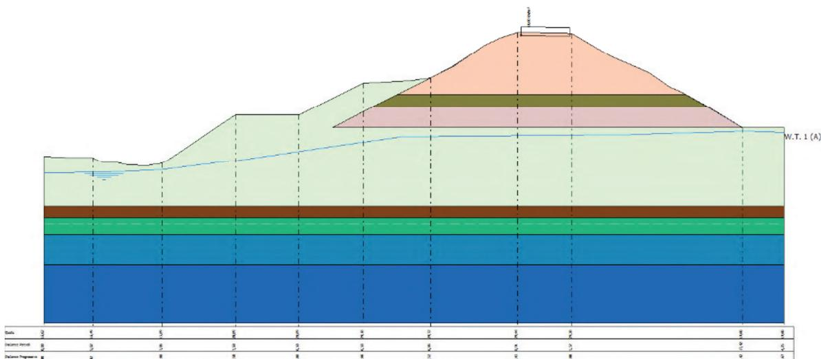
**Fig. 29** Schematizzazione della sezione oggetto di verifica di stabilità
