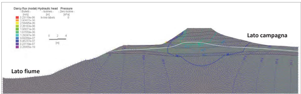
Fig. 35 Verifica alla filtrazione in stato transitorio
