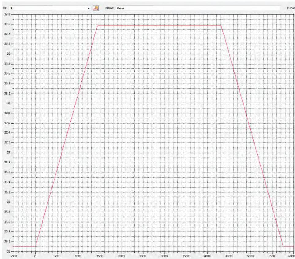
**Fig. 31** Esempio di Time series utilizzata per una sezione in esame in cui l’innalzamento e la discesa della piena sono previsti in 24h mentre il mantenimento della stessa in 48h.
