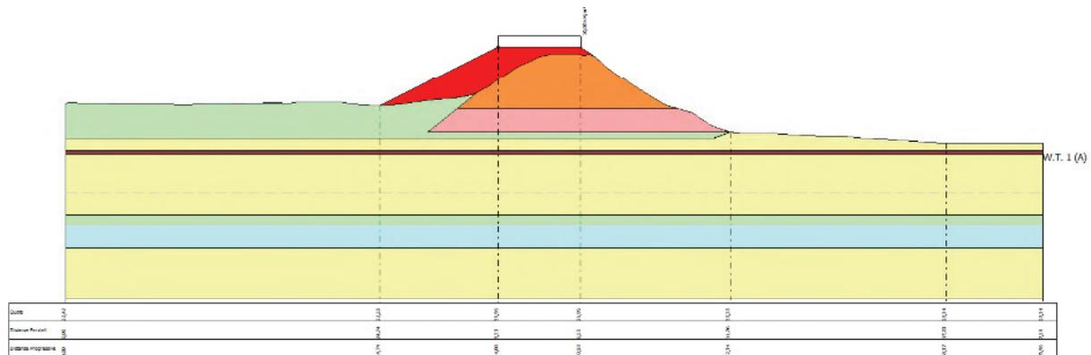
**Fig. 82** Schematizzazione della sezione ST092\_DX di verifica dei cedimenti dei terreni di fondazione
