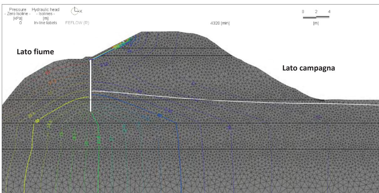
**Fig. 43** Verifica alla filtrazione in stato transitorio a seguito dell'inserimento degli interventi in progetto
