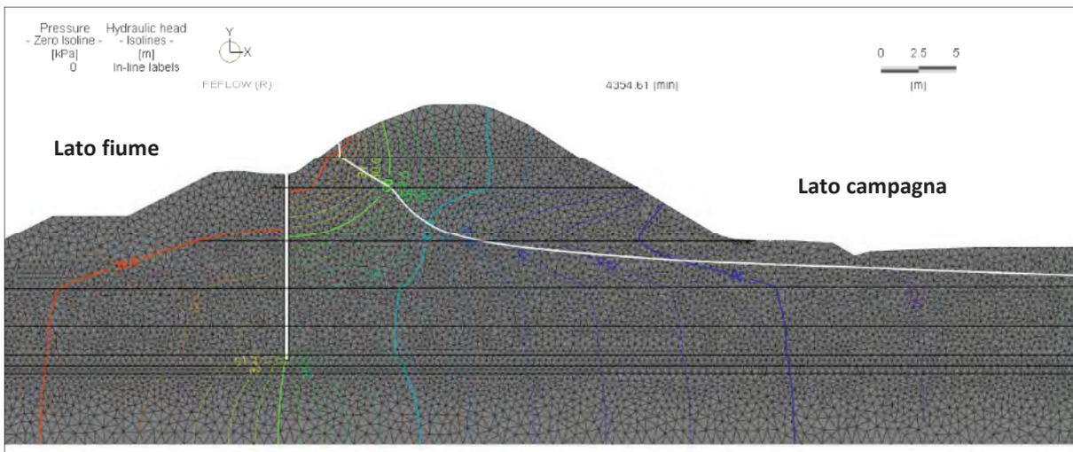
**Fig. 40 Verifica alla filtrazione in stato transitorio a seguito dell'inserimento degli interventi in progetto**
