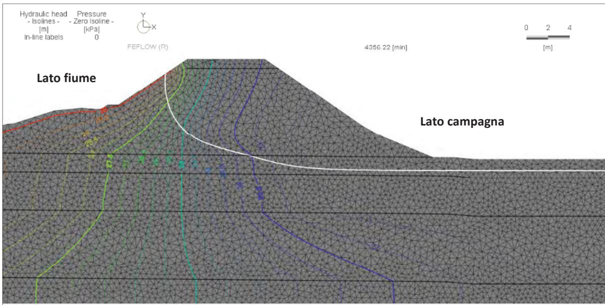
**Fig. 68** Verifica alla filtrazione in stato transitorio
