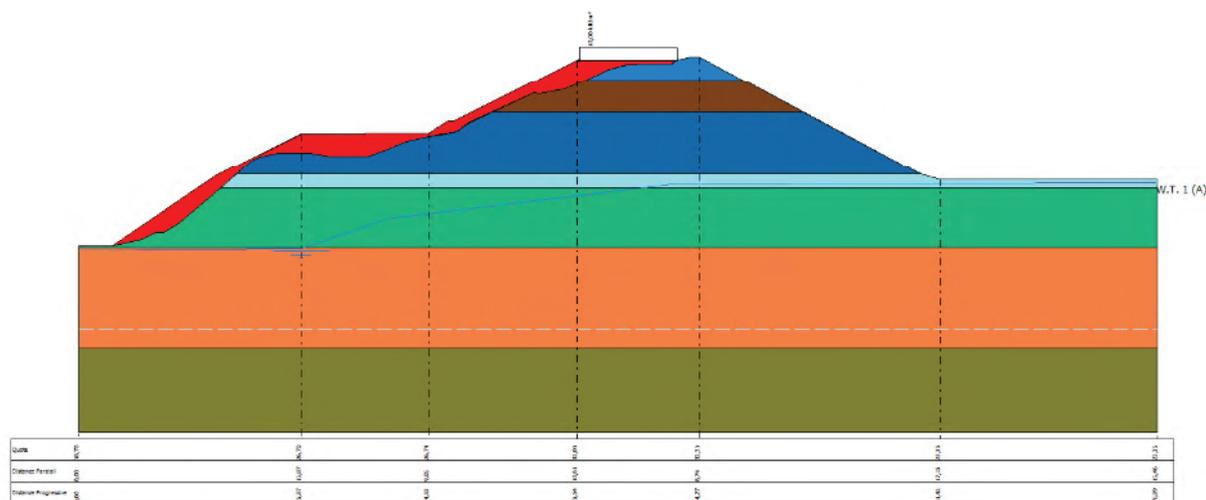
**Fig. 61** Schematizzazione della sezione oggetto di verifica di stabilità
