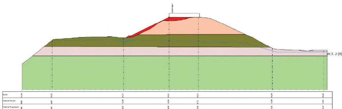
**Fig. 21** Schematizzazione della sezione oggetto di verifica di stabilità
