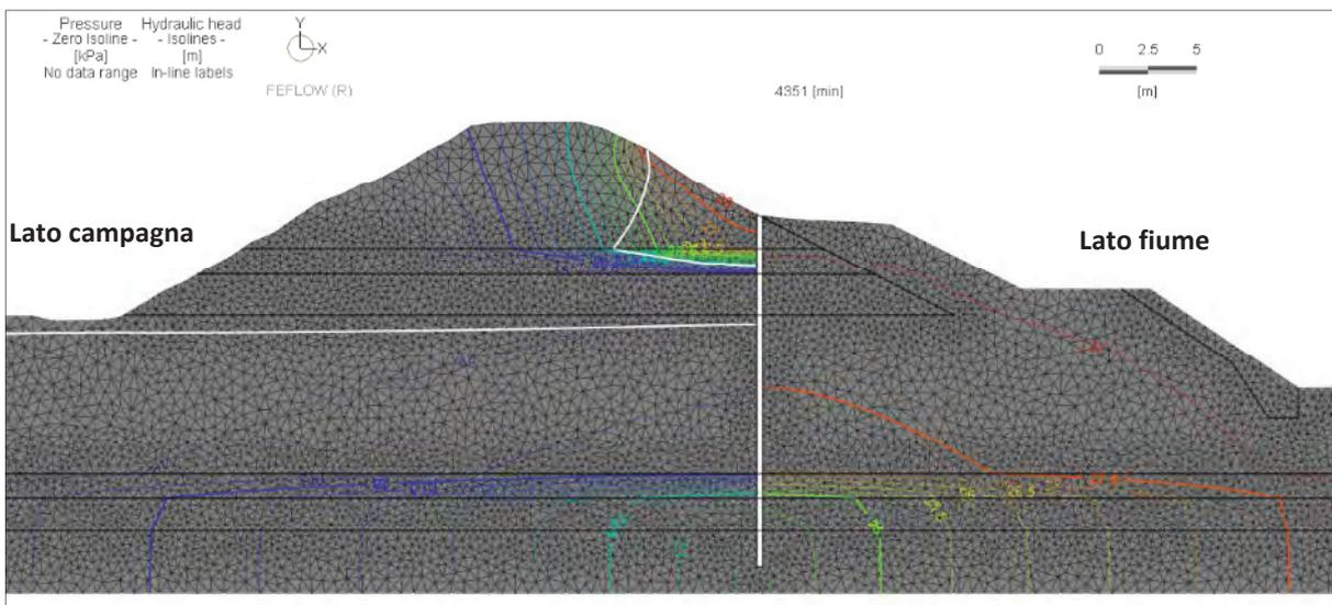
**Fig. 77 Verifica alla filtrazione in stato transitorio a seguito dell'inserimento degli interventi in progetto**
