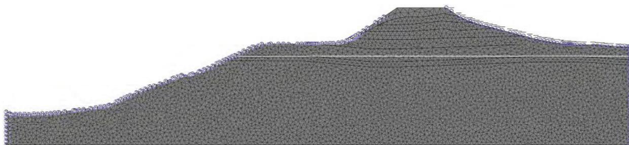
**Fig. 30 Rappresentazione grafica di un modello in esame in cui è presente la mesh e alcune condizioni a contorno**
