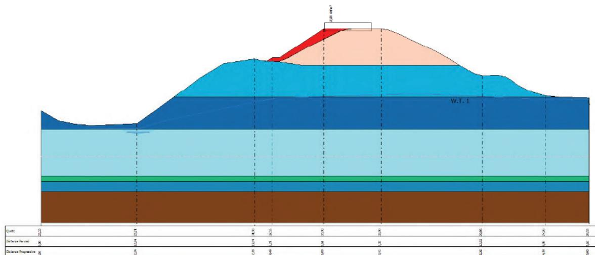
Fig. 36 Schematizzazione della sezione oggetto di verifica di stabilità
