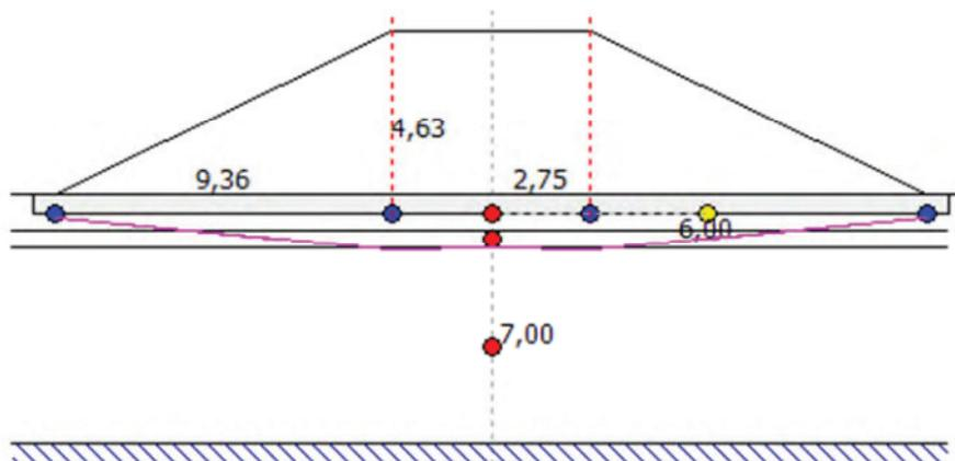
Fig. 85 Punti di calcolo dei cedimenti lungo la sezione ST092\_DX
