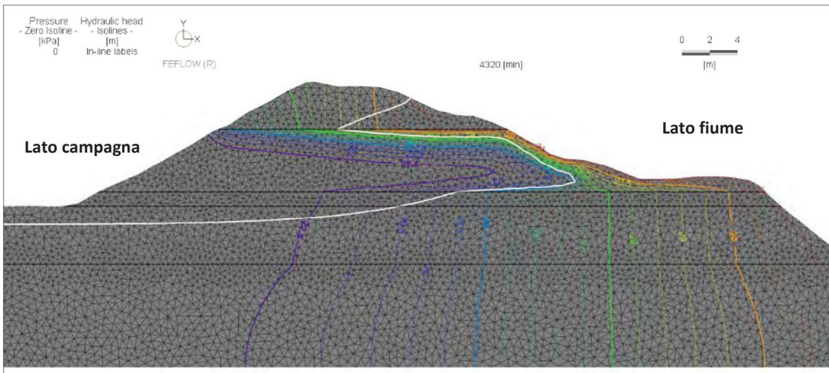
**Fig. 62** Verifica alla filtrazione in stato transitorio
