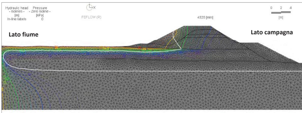
**Fig. 33 Verifica alla filtrazione in stato transitorio**
