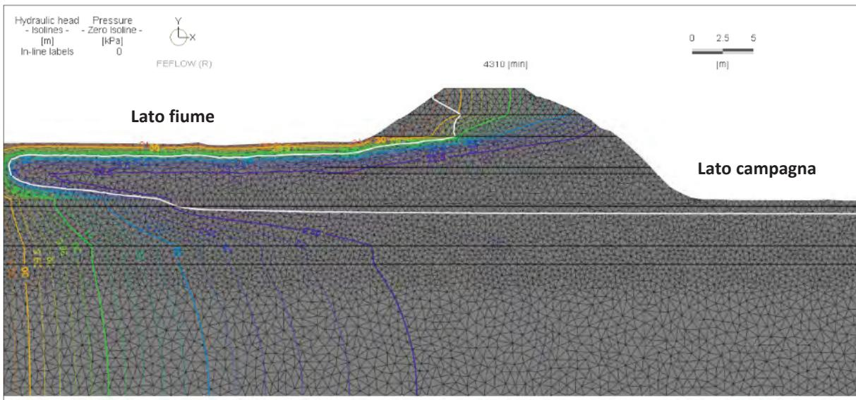
**Fig. 45** Verifica alla filtrazione in stato transitorio
