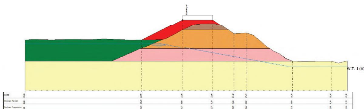
**Fig. 55** Schematizzazione della sezione oggetto di verifica di stabilità
