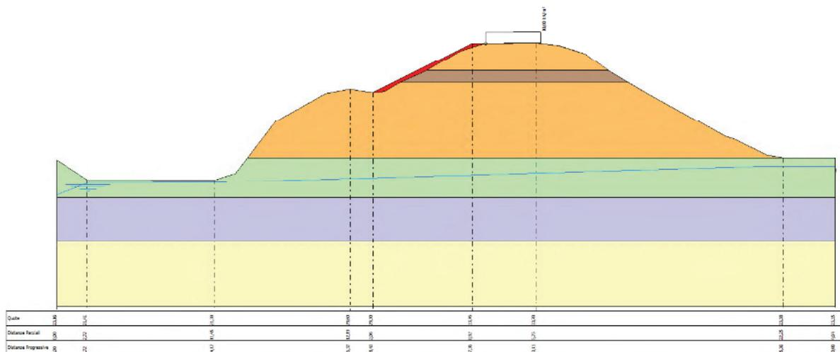
**Fig. 41 Schematizzazione della sezione oggetto di verifica di stabilità**
