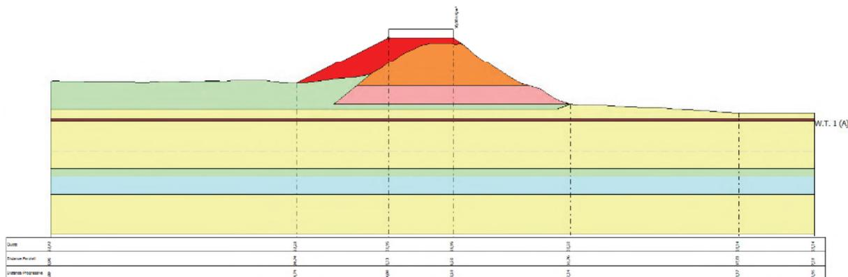
**Fig. 34 Schematizzazione della sezione oggetto di verifica di stabilità**
