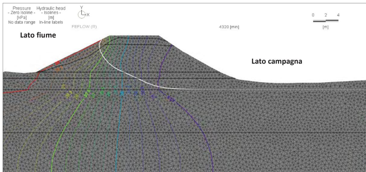
**Fig. 70 Verifica alla filtrazione in stato transitorio**
