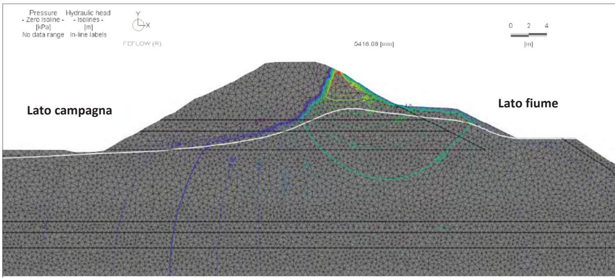
**Fig. 76 Verifica alla filtrazione in stato transitorio**
