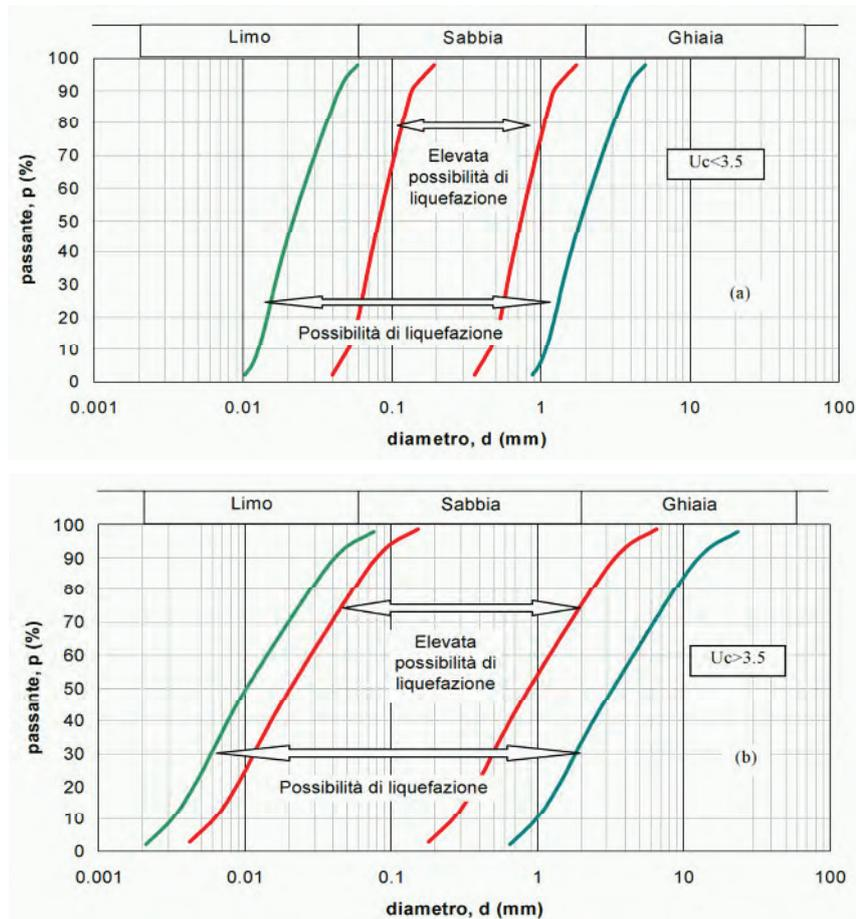
**Fig. 78** Fasce granulometriche per la valutazione preliminare della suscettibilità alla liquefazione di un terreno a differente coefficiente di uniformità: a)  $U_c < 3,5$ ; b)  $U_c > 3,5$  (fonte: AGI, 2005)
