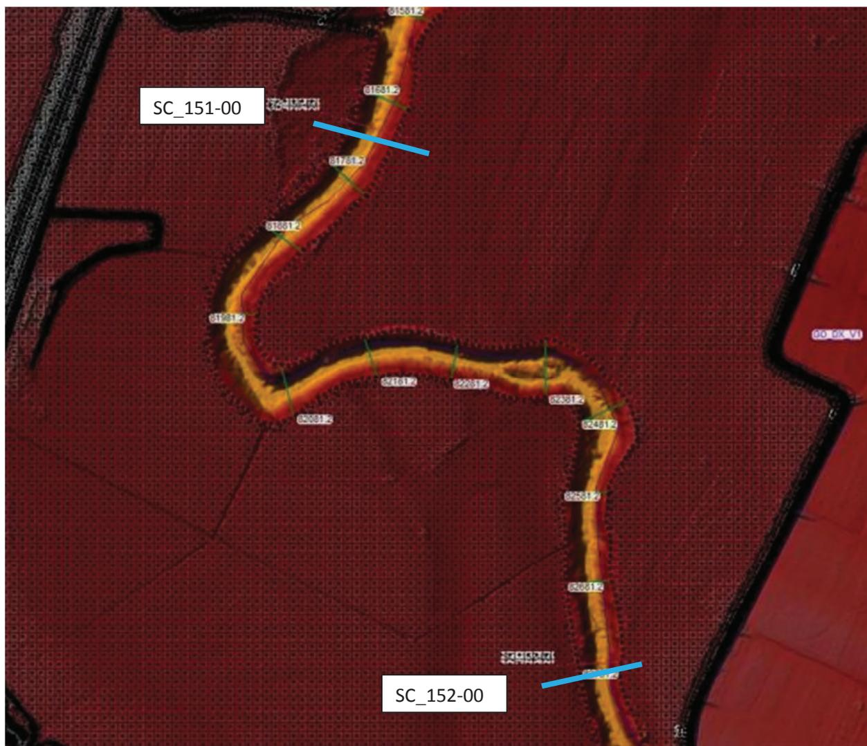
**Fig. 15** Posizione delle sezioni trasversali dell'alveo inciso utilizzate per la costruzione del modello geometrico 1D lungo un tratto del corso d'acqua
