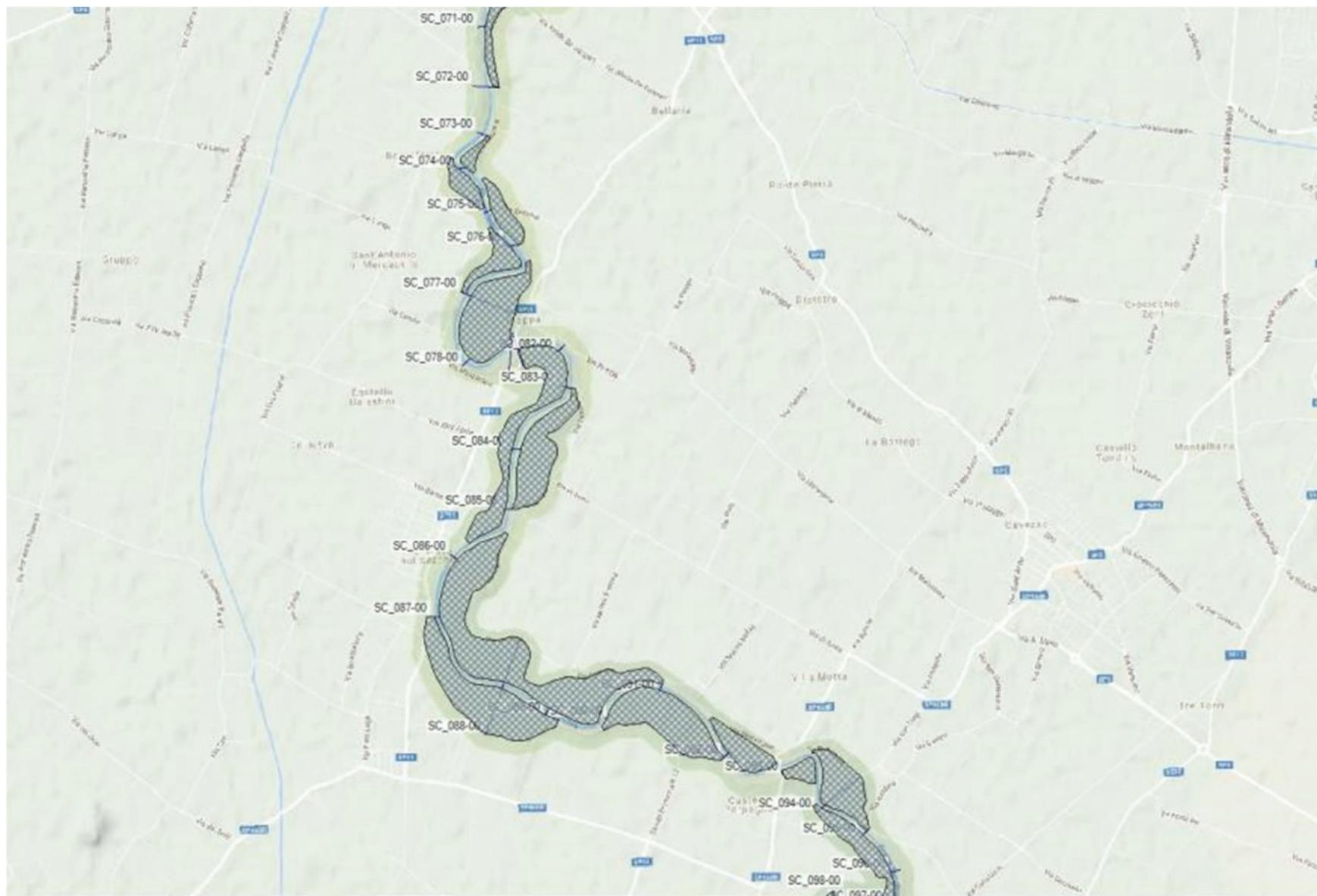
Fig. 35 Schematizzazione aree 2D del modello idraulico
