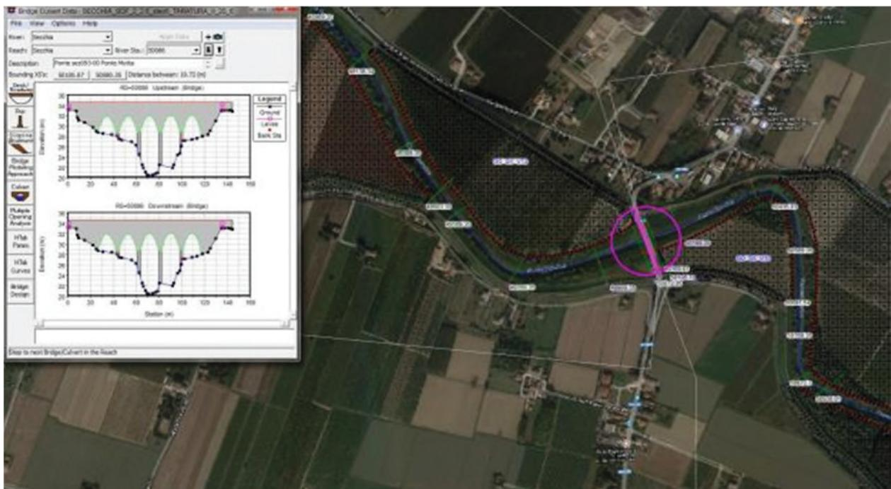
**Fig. 66** Implementazione della geometria di ponte Motta
