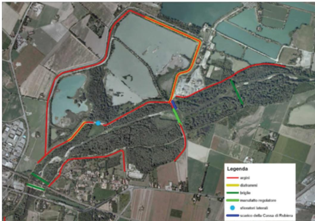
**Fig. 16 – Planimetria di insieme della cassa di espansione con evidenziazione delle opere componenti**
