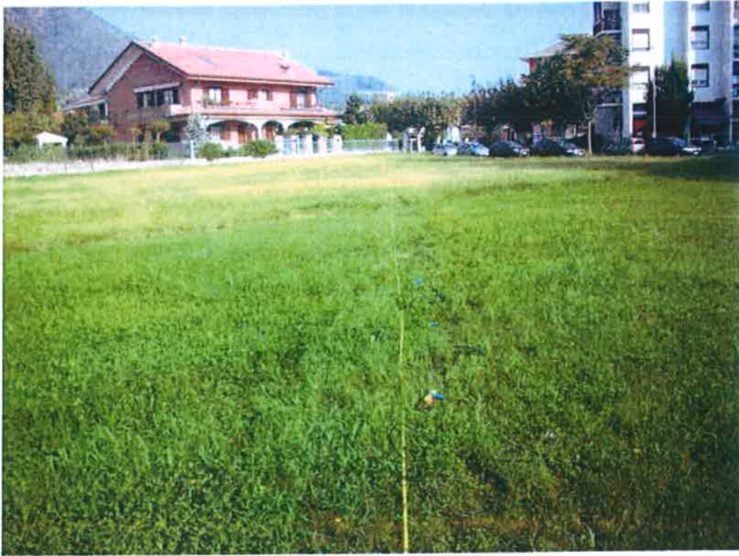
Stendimento di geofoni verticali
