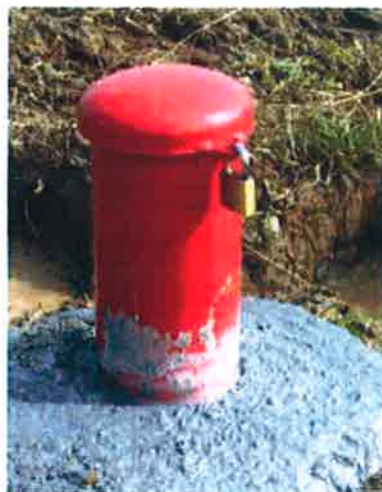
Particolare fotografico del tipo di terminale di protezione adottato su S1 ed S3
