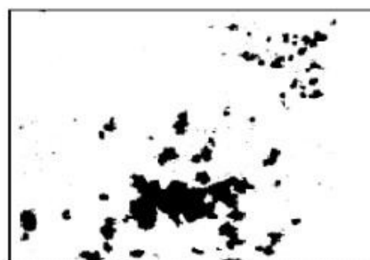
O (10% superficie corrosa)
