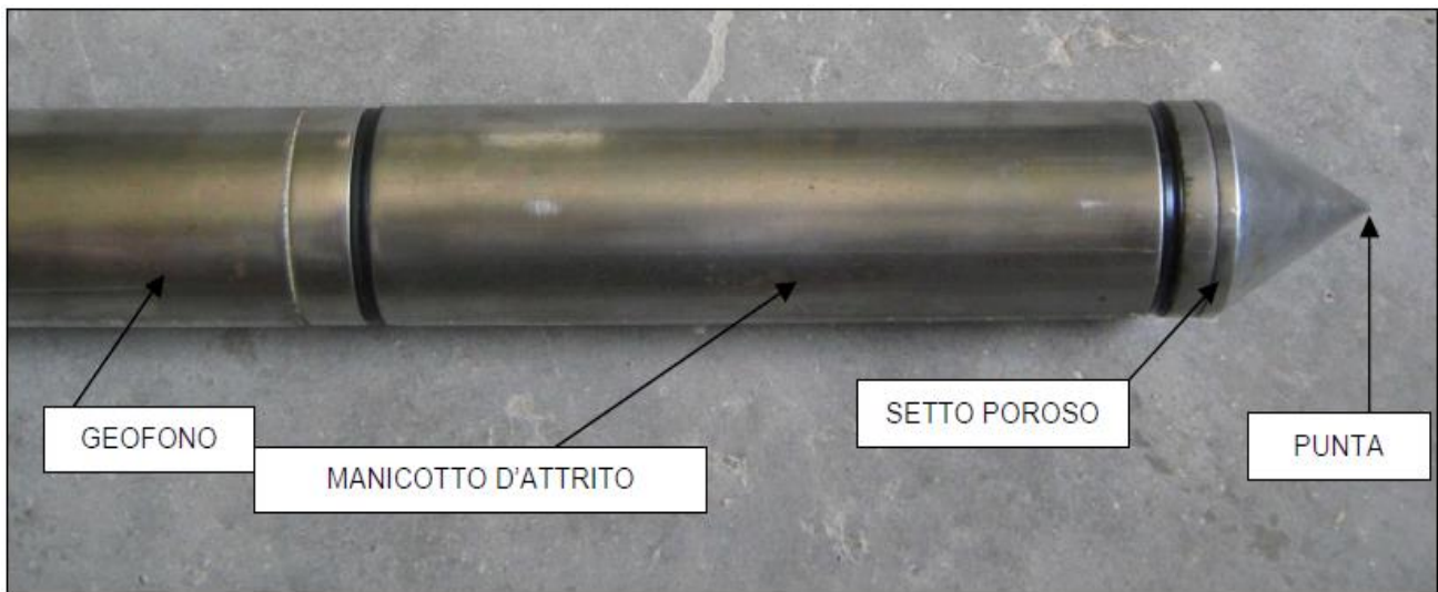
Fig. 12 – Punta del penetrometro elettrico e sismocono
