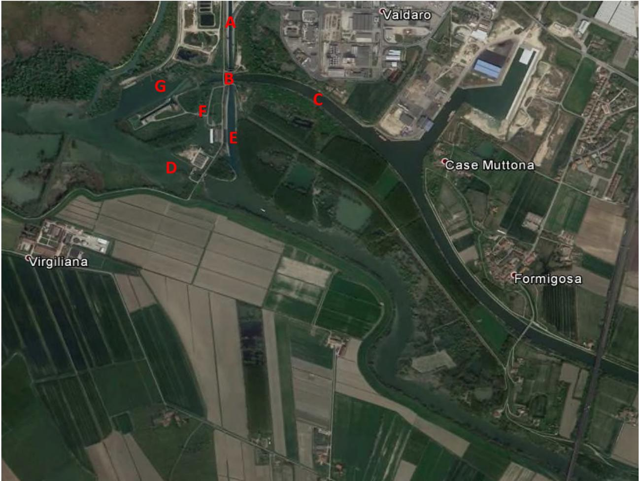
Figura 4-6 - Nodo idraulico di Formigosa – A =Diversivo; B = sifone; C = canale navigabile Fissero – Canal Bianco; D = Fornice e controfornice; E = idrovore; F= scaricatore Vallazza-Fissero; G = conca di Valdaro
