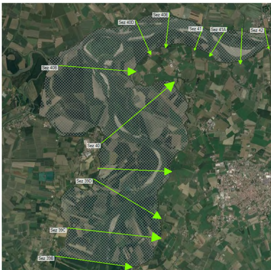
Fig. 42 Tratto di fiume Po interessato dalla simulazione idraulica 2D (tra la sez. 39B, prossimità di Luzzara, e la sez. 42 ponte ferroviario a Borgoforte)
