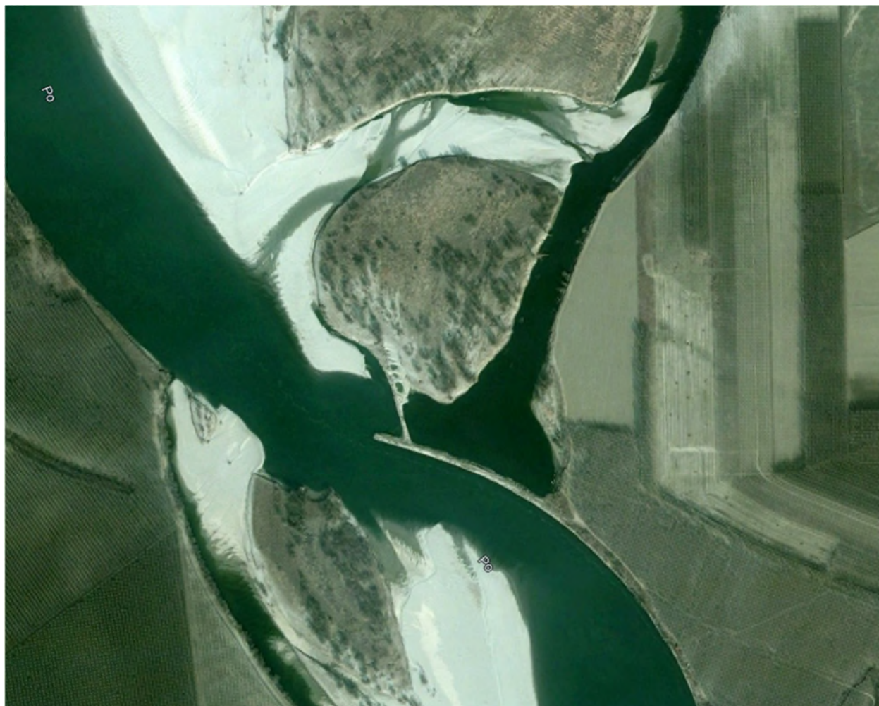
Fig. 6 Pennello della curva di navigazione 14 a monte dell'isola in prossimità della confluenza dell'Oglio in Po ( 2003, Google Earth).
