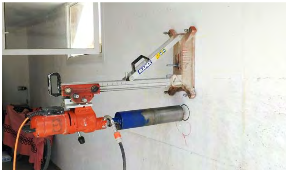
Foto 13. Strumento utilizzato per il carotaggio in elevazione
