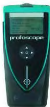
Figura 01. Strumento utilizzato per le indagini (pacometro modello “Profoscope Proceq”).
