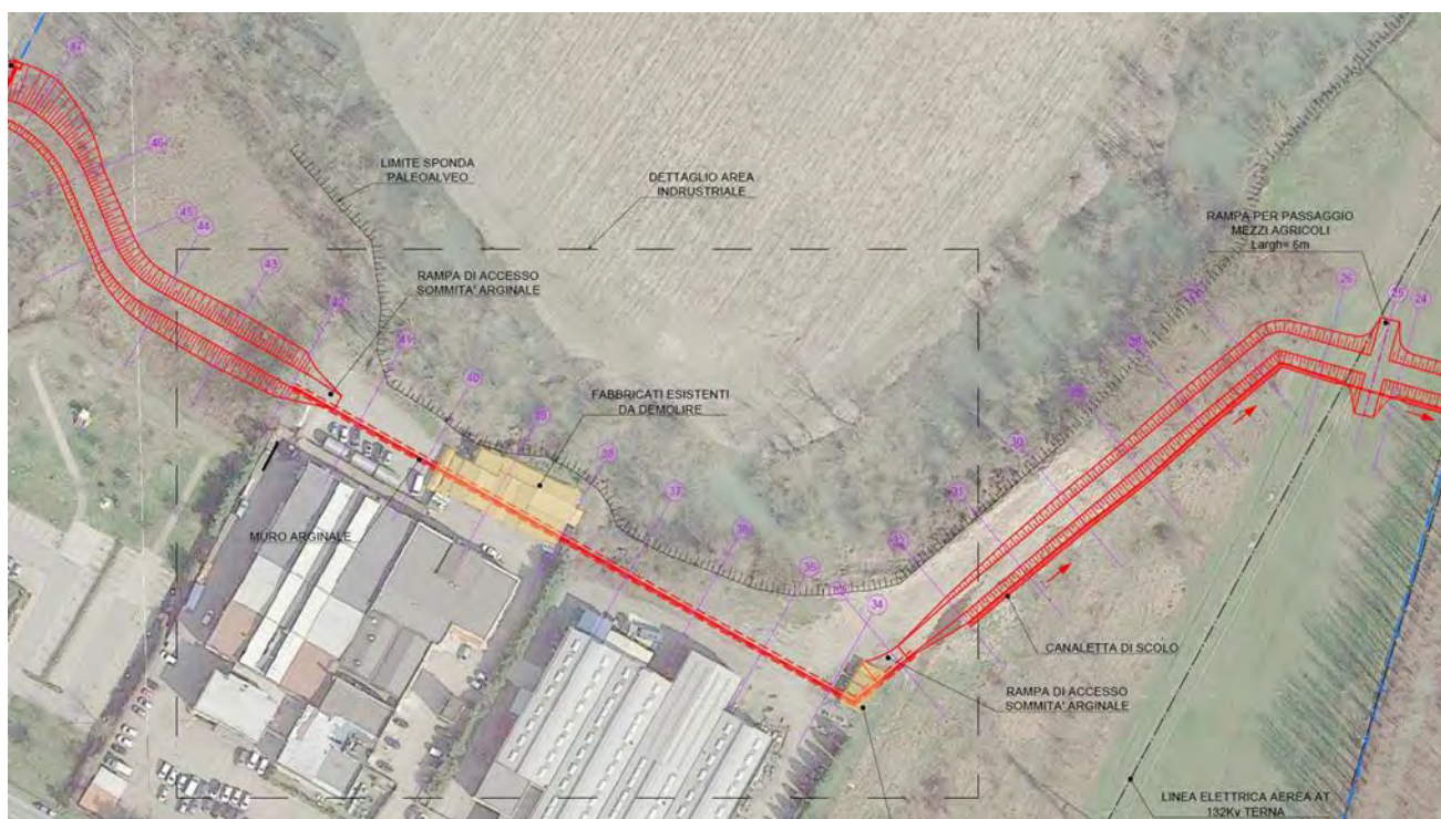
Tratto insediamenti produttivi - formazione di un nuovo muro arginale (intervento tipo D)
