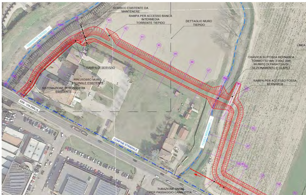
Adeguamento in quota e in sagoma di rilevato arginale esistente (intervento tipo B) e rialzamento e ringrosso di un muro in c.a. esistente (intervento tipo A)
