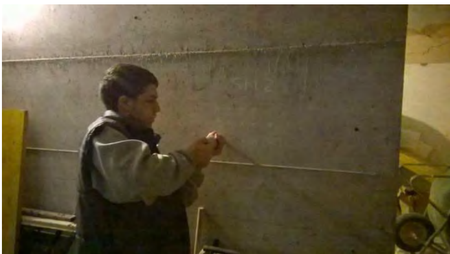
Foto 09. Esecuzione prova sclerometrica
