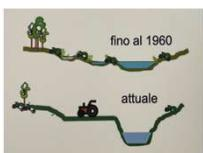
Riduzione dell'artificialità dell'alveo: adeguamento pennelli di navigazione, dismissione/modifica opere di difesa
