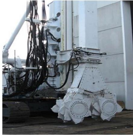
Figura 5-1 – A sx: principio della tecnologia Cut Soil Mixing per realizzare la diaframmatura; - dx: l'utensile montato sulla macchina operatrice
