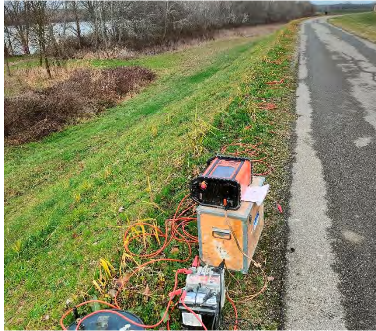
Stendimento tomografia elettrica
