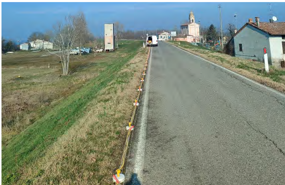
Stendimento sismico Masw 2D
