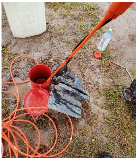
Figura 32. Esecuzione prova sismica Down Hole.
