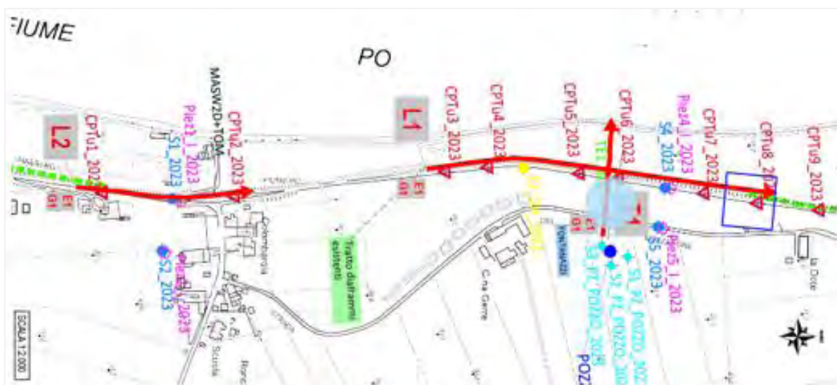
Planimetria ubicazione sezioni di rilievo indagini tomografia elettrica (freccia di colore rosso)
