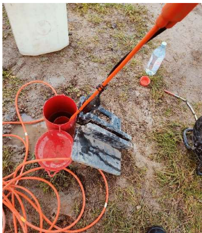
Figura 32. Esecuzione prova sismica Down Hole.
