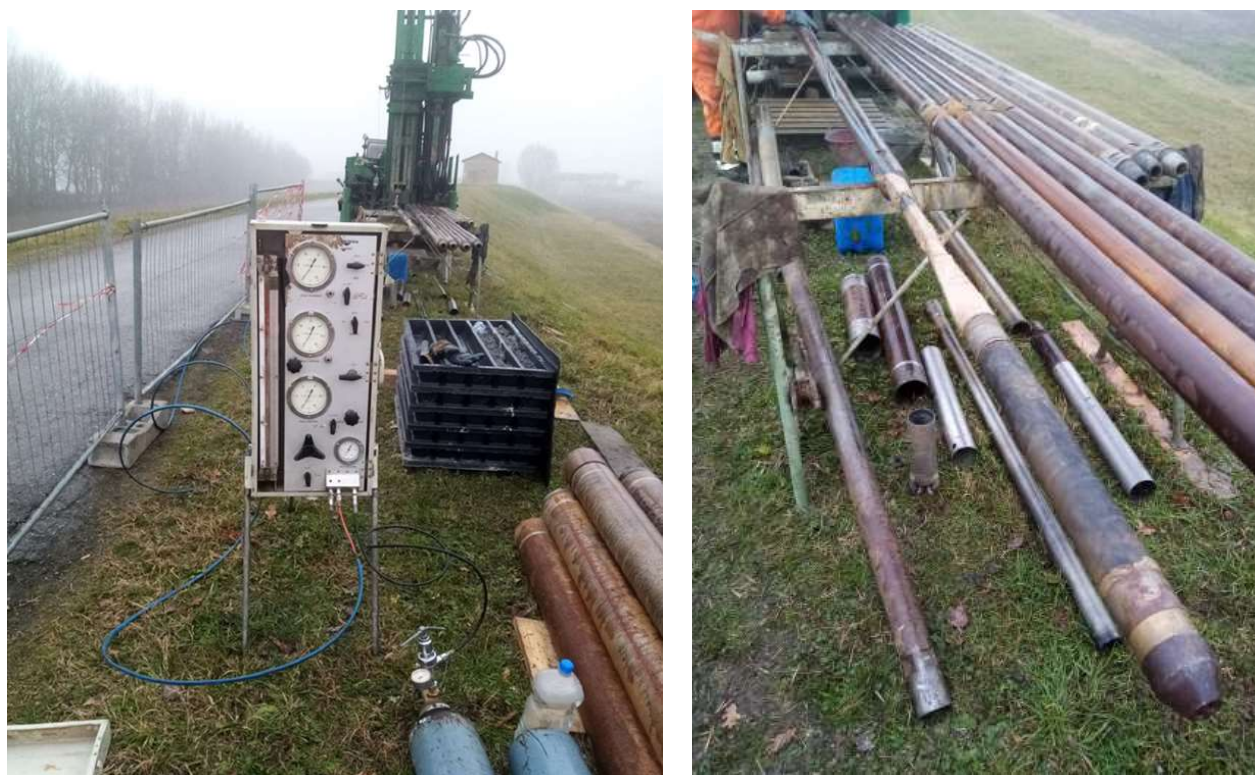
Figura 34. Allestimento prova pressiometrica Menard.
