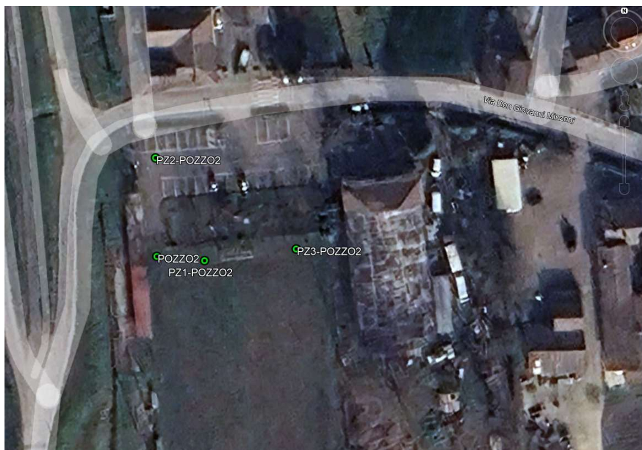
Figura 36. Ubicazione Pozzo 2 e piezometri per prove di portata.
