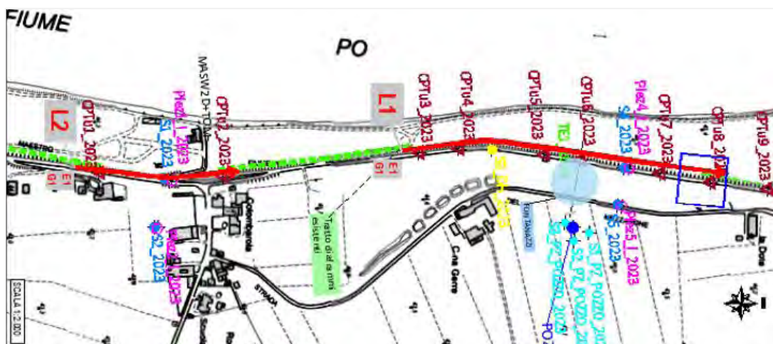
Planimetria ubicazione sezioni di rilievo indagini Masw 2D (frece di colore rosso)
