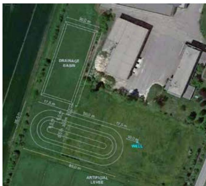
Fig 5: Possibile disposizione del bacino sperimentale nel campo prove AIPO di Boretto.
