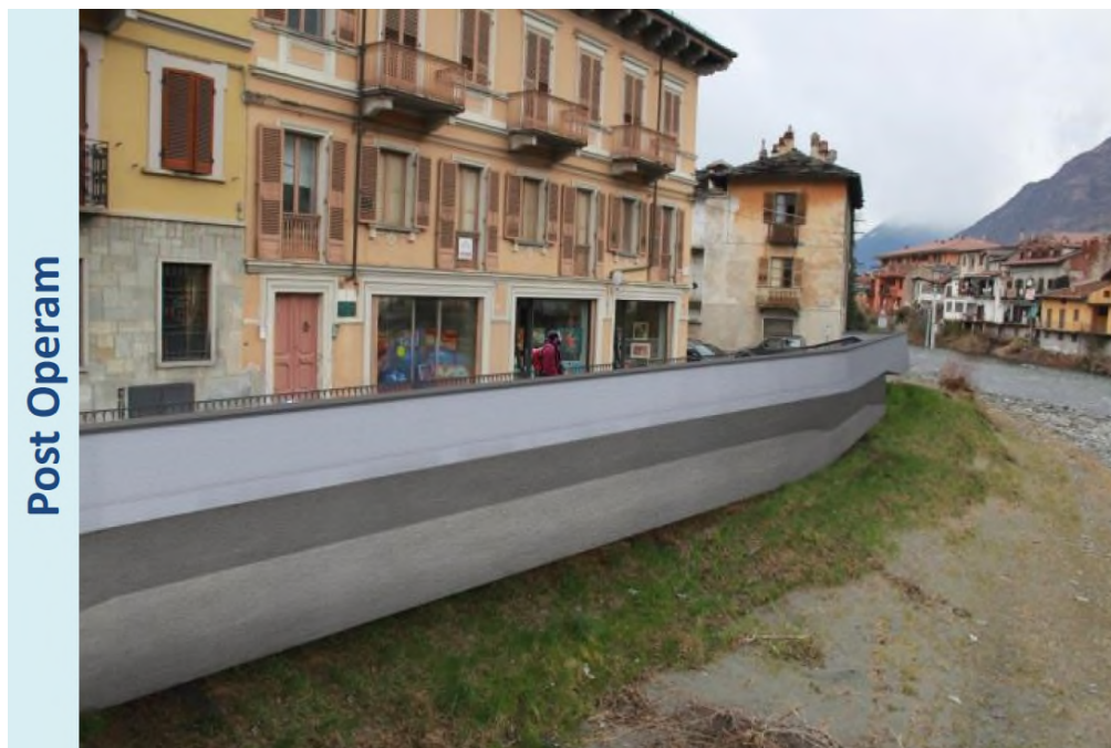
Fig. 33 - Render relativo alla ricostruzione del muro di sponda a monte del ponte Vecchio.
