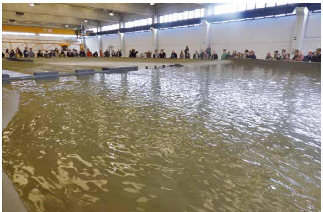
Modello fisico della cassa di espansione del Baganza, presso il Polo scientifico AIPO di Boretto - Simulazione dell'accumulo dell'acqua di piena nel primo comparto
