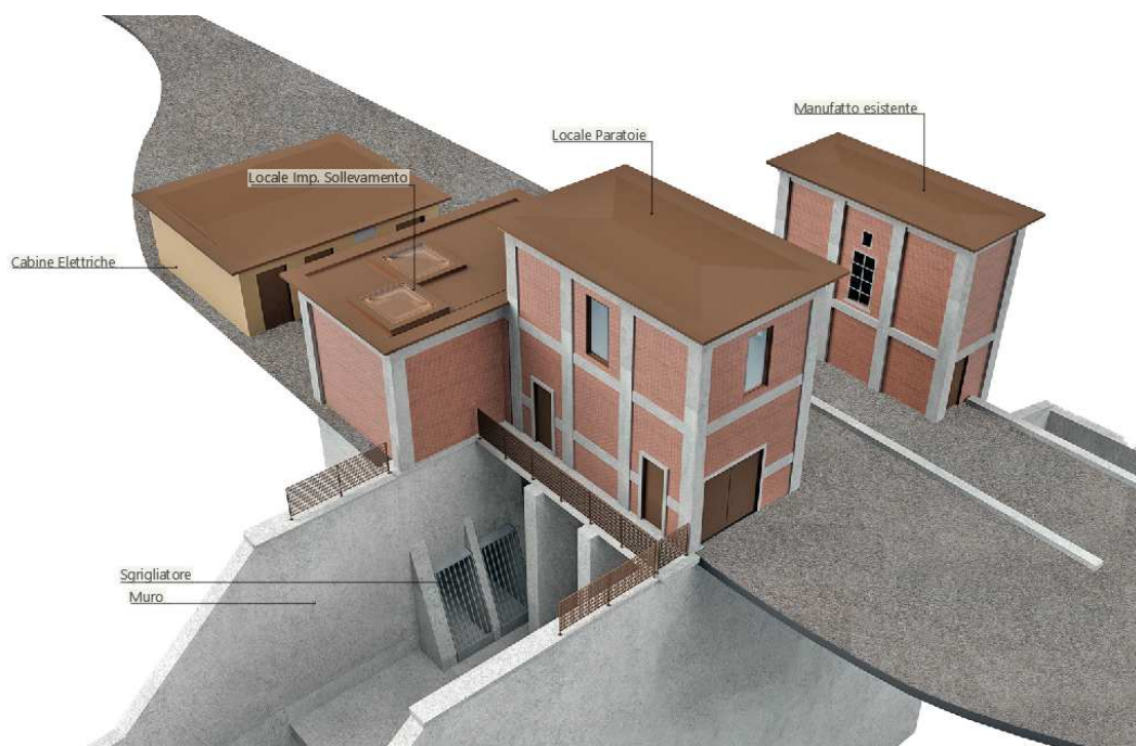
Figura 6: Indicazione delle opere strutturali del complesso principale e manufatti accessori
