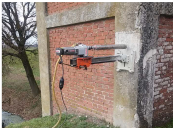
Figura 1: Ubicazione della estrazione di carota di cls – campagna di indagini 2015
