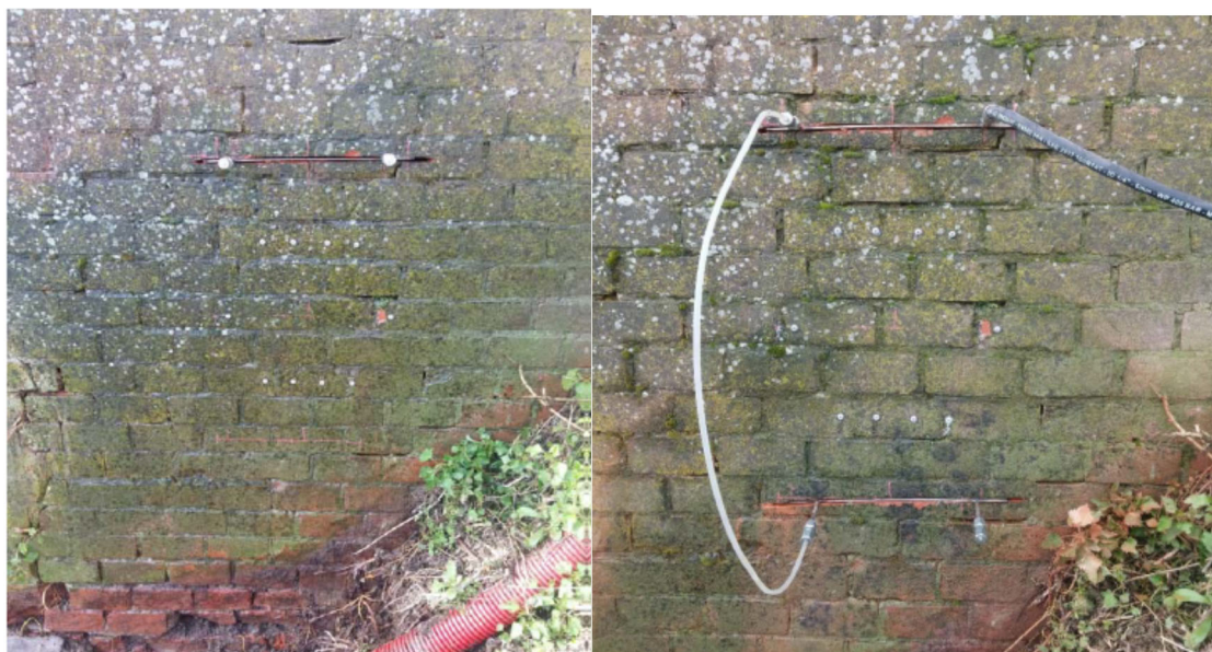
Figura 7: Immagini della prova con martinetto piatto – 2015
