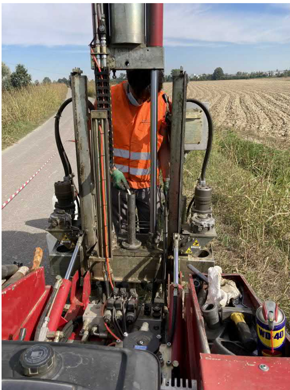
Prove di permeabilità in sito. Misurazione sistematica del livello idrico tramite sonda elettrica.
