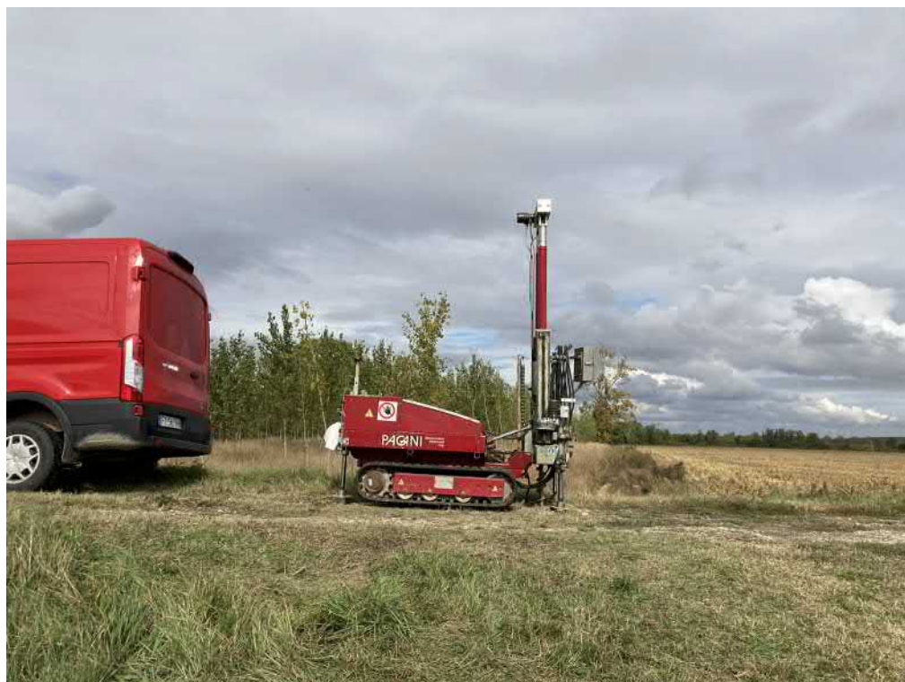
Esecuzione delle indagini penetrometriche
