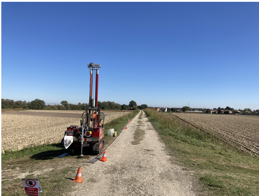
Esecuzione delle indagini penetrometriche
