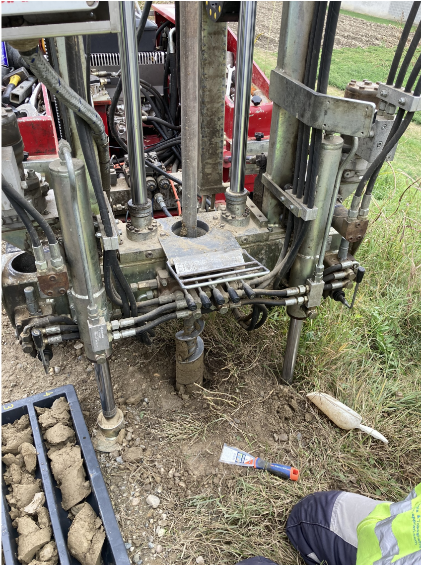
Carotaggio mediante sonda carotatrice con aste elicoidali
