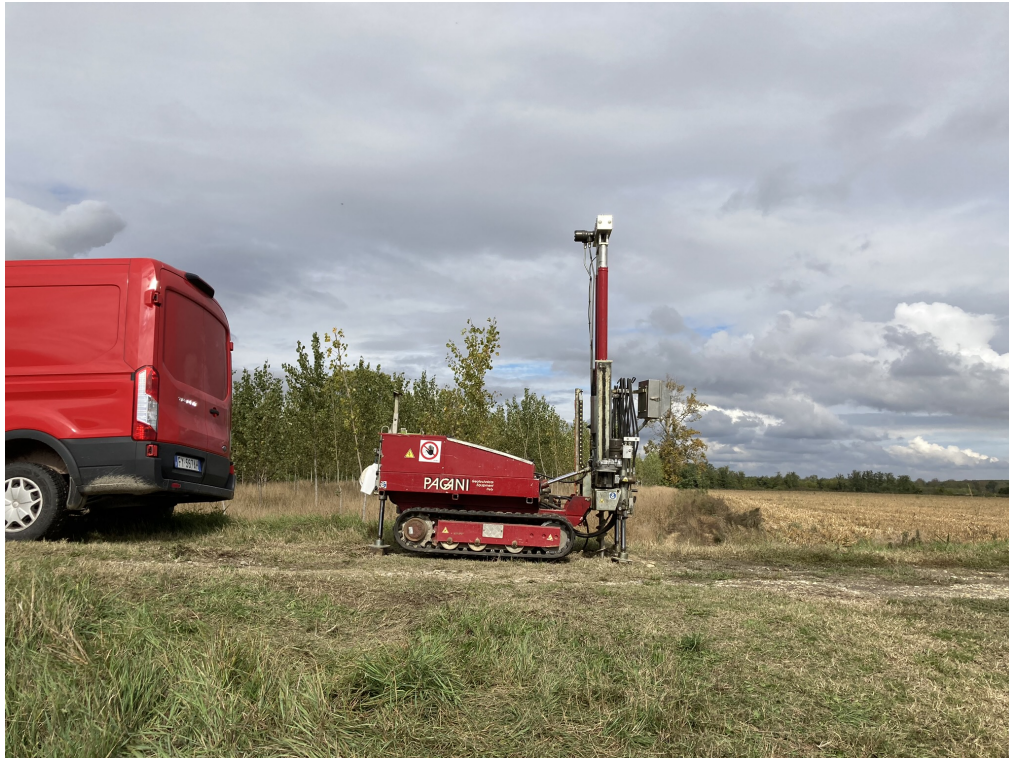
Esecuzione delle indagini penetrometriche
