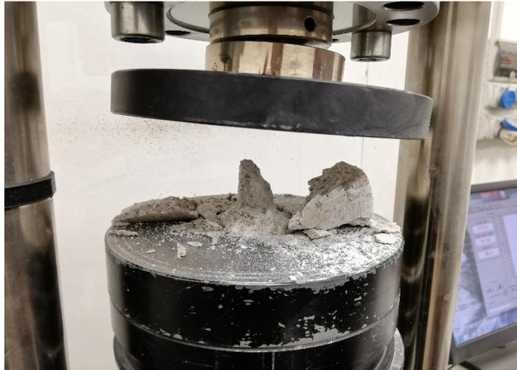
Figura 10: Provino di roccia dopo compressione
