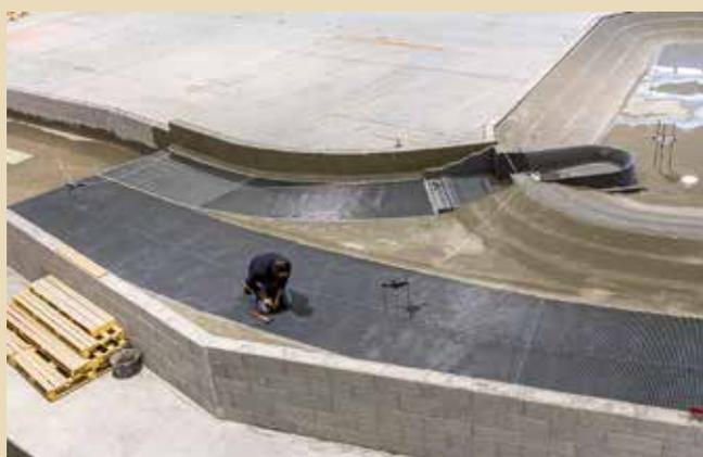
Figura 6. Posa in opera della rete metallica per riprodurre correttamente la scabrezza del fondo dell'alveo del modello
