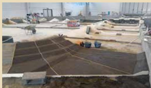
Figura 5. Fasi di realizzazione del modello fisico: posa delle centine in legno per alveo e arginature e riempimento.
