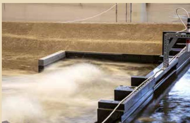
Figura 15. Verifica dell'adeguatezza delle opere di contenimento (muri laterali e quinta) della vasca di dissipazione a valle del manufatto A, sponda destra. Piena con  $T=1000$  anni e luci di fondo completamente aperte.
