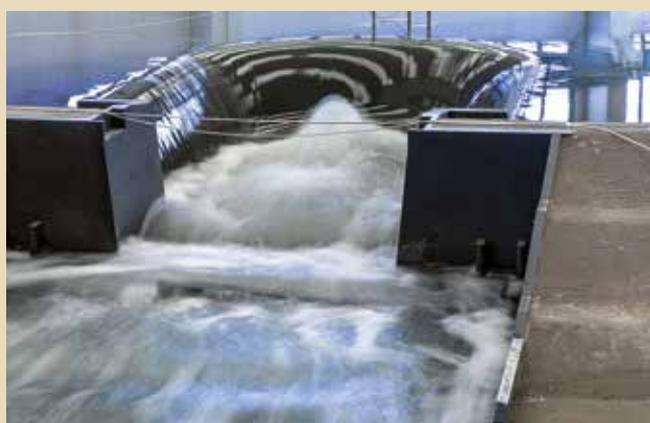
Figura 4. Modello in scala del manufatto C nella configurazione originariamente prevista dal progetto esecutivo
