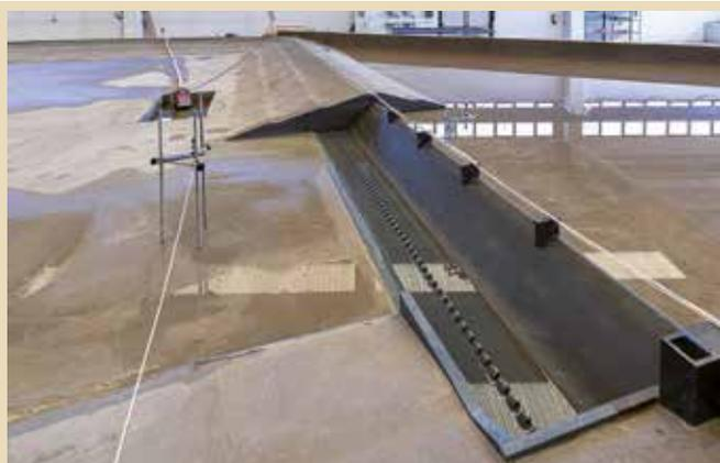
Figura 3. Modello in scala del manufatto B (configurazione già modificata rispetto a quella originariamente prevista dal progetto esecutivo)
