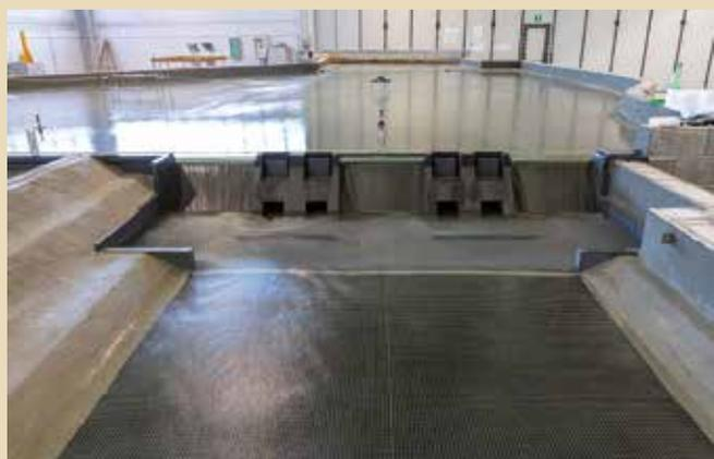
Figura 2. Modello in scala del manufatto A nella configurazione originariamente prevista dal progetto esecutivo
