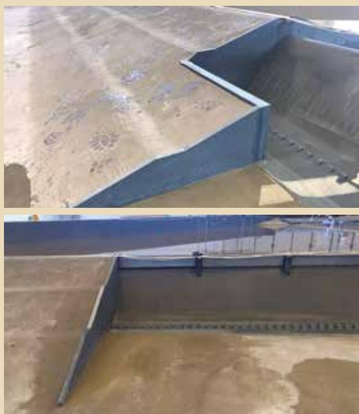
Figura 13. Manufatto B: muri di sostegno e quinta a valle della vasca di dissipazione in destra idraulica. Configurazione originariamente prevista dal progetto esecutivo (a sinistra) e modificata (a destra).
