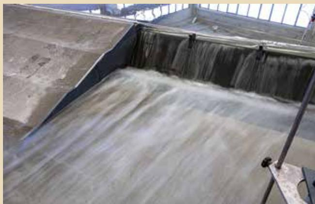
Figura 14. Manufatto B: configurazione modificata della sponda destra. La foto scattata con tempo di posa lungo mostra il campo di moto regolare in uscita dalla vasca di dissipazione.
