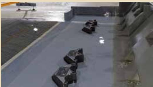
Figura 8. Blocchi di dissipazione del manufatto A nella configurazione proposta nel progetto esecutivo (a sinistra) e conformati secondo la sezione trasversale di un doppio cucchiaino (a destra).
