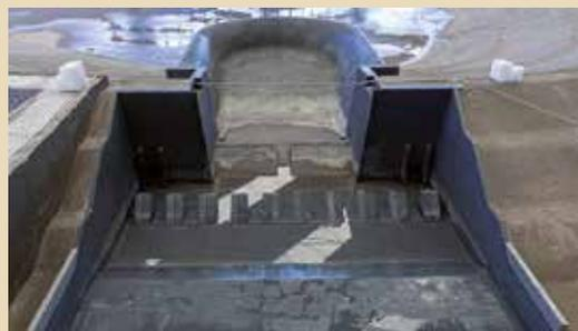
Figura 10. Blocco di dissipazione del manufatto C nella configurazione originariamente proposta nel progetto esecutivo (a sinistra) e configurazione alternativa con denti tipo Rehbock (a destra).
