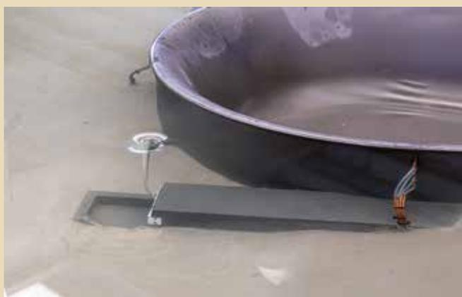
Figura 12. Vortice pienamente sviluppato con gli scarichi nella configurazione originaria.
