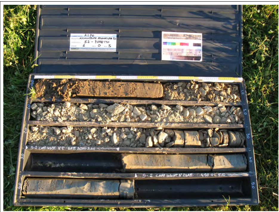
Sondaggio n. S2. Prof. 0 - 5 m. Prelevato due campioni indisturbati alla profondità di 3 m (CI-1) e 4,5 m (CI-2).
