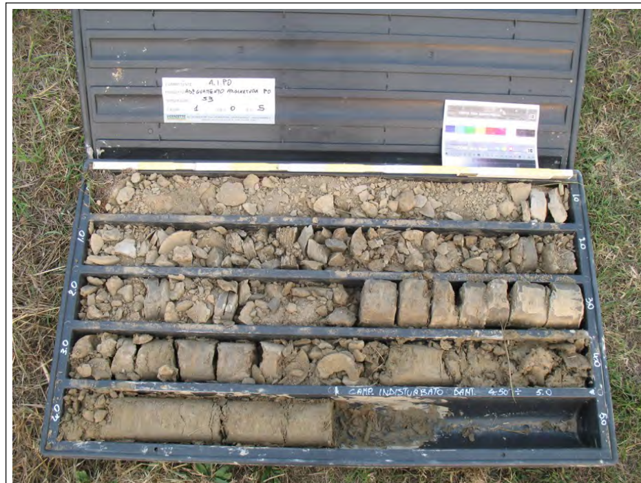
Sondaggio n. S3. Prof. 5 - 10 m. Prelevato un campione indisturbato alla profondità di 9,5 m (CI-2).
