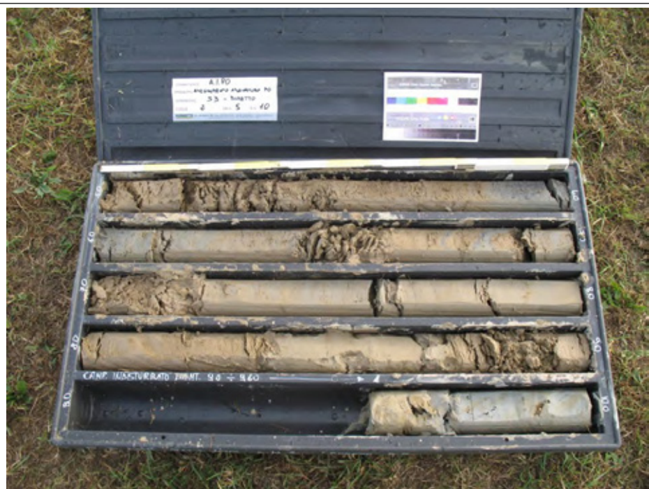
Sondaggio n. S3. Prof. 0 - 5 m. Prelevato un campione indisturbato alla profondità di 4,5 m (CI-1).
