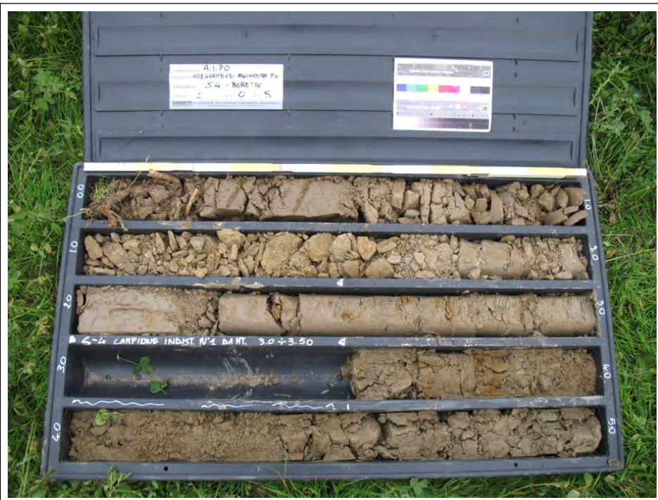
Sondaggio n. S4. Prof. 0 - 5 m. Prelevato un campione indisturbato alla profondità di 3 m (CI-1).
