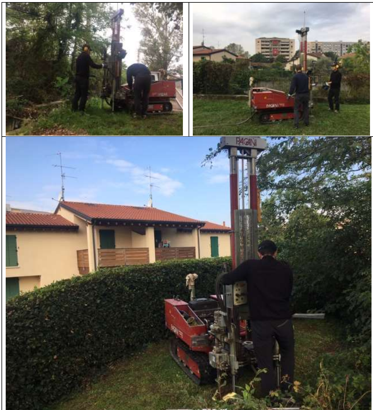
Figura 40 – Postazioni prove penetrometriche ottobre 2019
