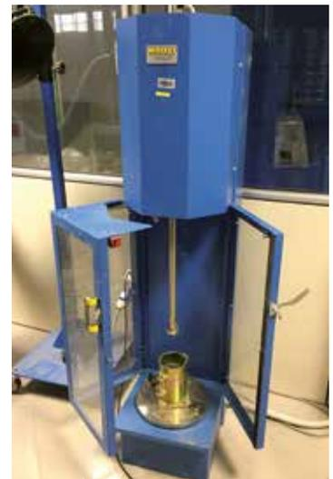
PROCTOR: l'apparecchio per la prova Proctor presente al Centro Prove e Ricerche di Boretto. La prova consiste nel disporre un campione di terra all'interno di una fustella e costiparlo mediante un pestello. Viene utilizzata per valutare il costipamento del terreno, valutando l'influenza del contenuto d'acqua sullo stesso.
