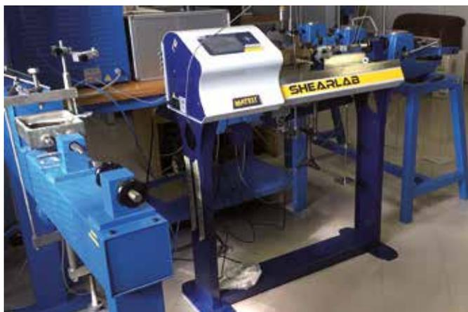
TAGLIO: una delle due macchine di taglio presenti al Centro Prove e Ricerche di Boretto. La prova consiste nell'inserire un campione di terreno all'interno di una intelaiatura metallica e nel portarlo a rottura lungo un piano orizzontale predefinito. Questa prova determina la resistenza al taglio del terreno.
