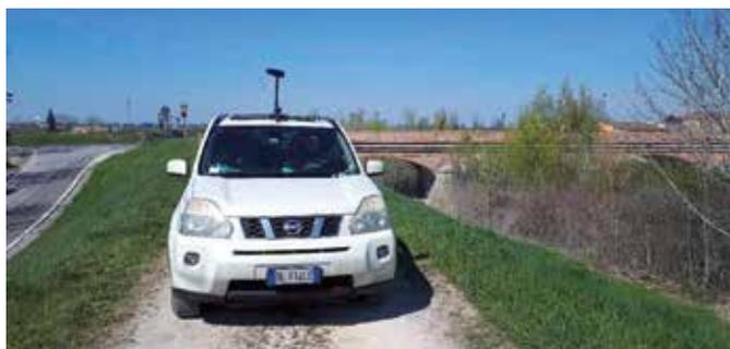
Figura 9 – equipaggiamento su autoveicolo per riprese a distanza della sponda interna opposta
