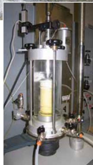
TRIASSIALE: un particolare dell'apparecchio triassiale del Laboratorio Geotecnico di Boretto. La prova consiste nel comprimere un provino di terreno, posto all'interno di una cella piena d'acqua, deformandolo in modo controllato fino a portarlo a rottura. Lo scopo della prova è quello di determinare le caratteristiche di resistenza al taglio e di rigidezza del terreno.
