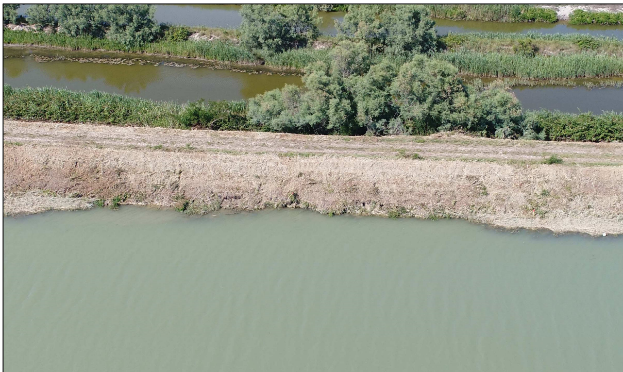
3- vista aerea da st. 70 particolare zona in erosione – giugno 2018
