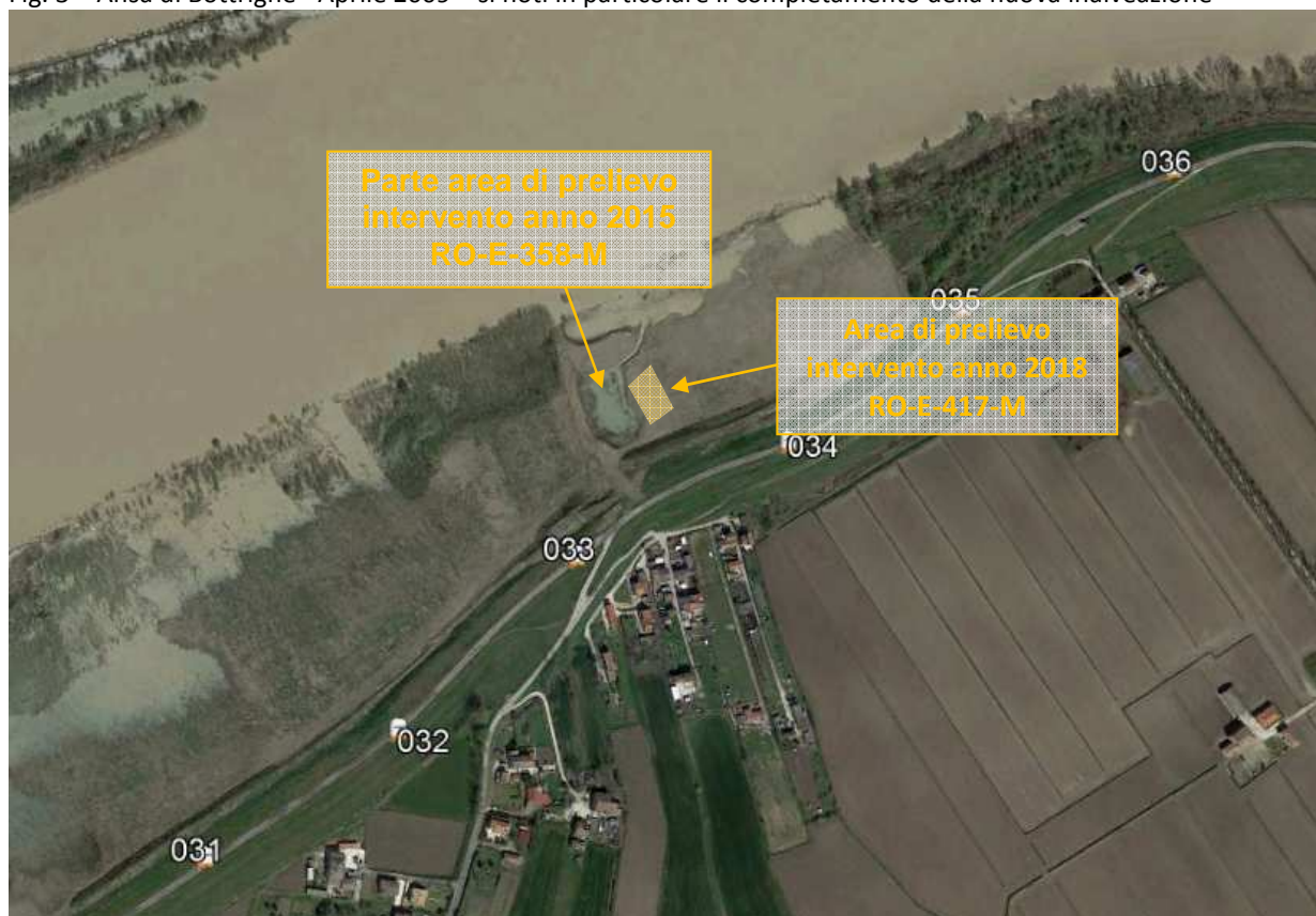
Fig. 4 – Ansa di Bottrighe – 28.03.2015 – utilizzo di parte dell'area golenale quale sito di prelievo del materiale terroso per interventi di adeguamento arginale (classifica RO-E-358-M - Adeguamento sagoma arginale in sinistra del Po di Goro tra stanti 48-52 e RO-E-417).
