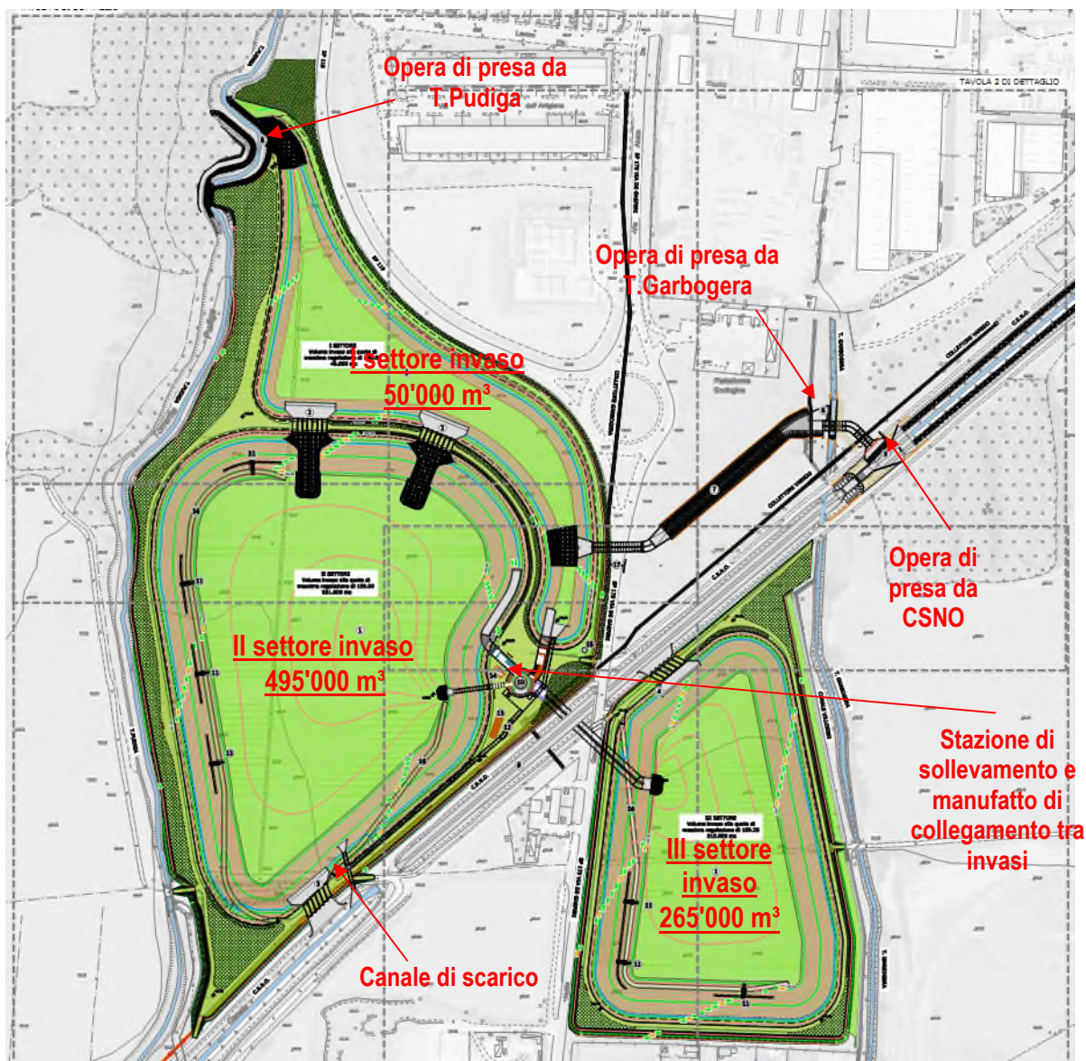
Figura 8 – Schema Alternativa n. 3-ter (come da Studio-AIPo-2011) con valori aggiornati dei volumi di laminazione a seguito prescrizioni della V.I.A.
