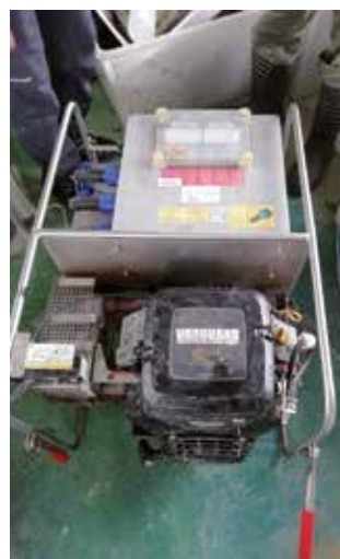
Figura 2: generatore di corrente dell'elettrostorditore
