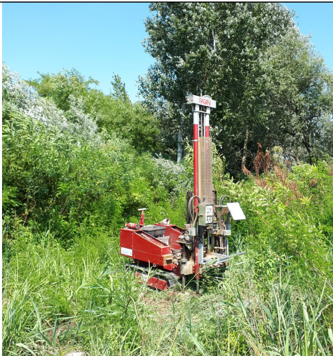
Foto 1: Esecuzione prova CPT1
