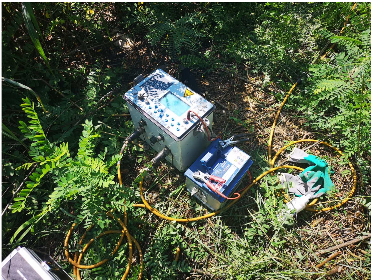
Foto 3 Strumentazione elettrica IRIS SYSCAL PRO 48canali.
