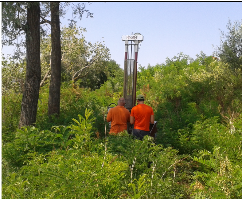
Foto 2: Esecuzione prova CPT2
