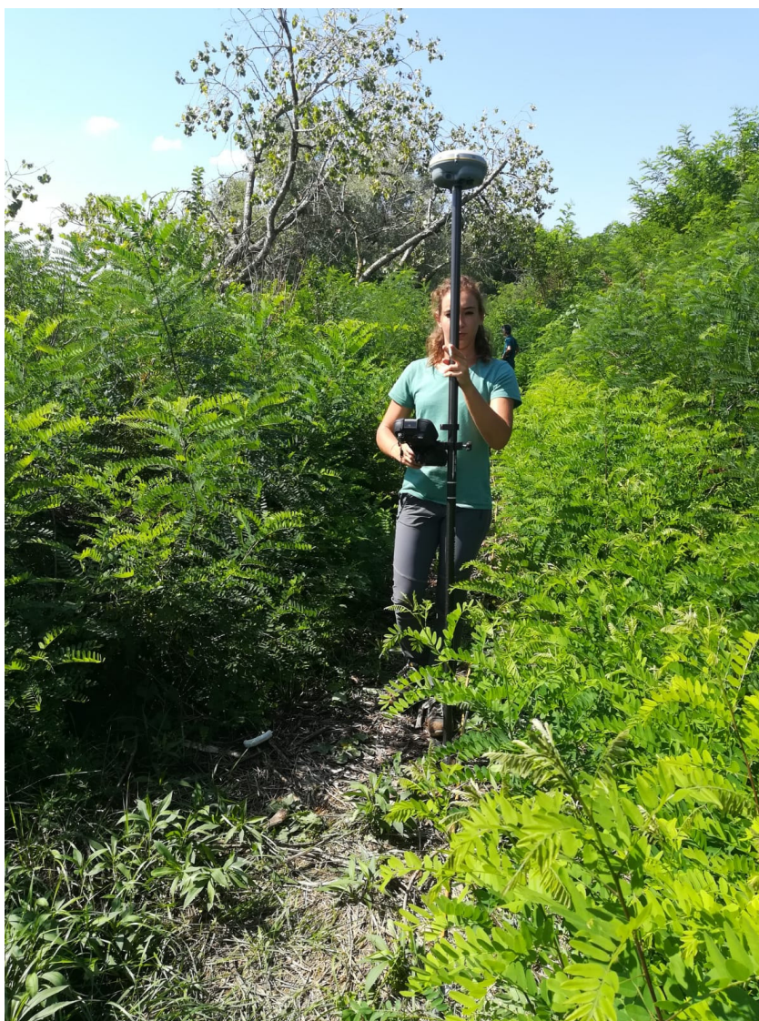
Foto 4 Rilievo GPS con strumentazione GPS/GNSS TrimbleR8s in modalità Real-Time.
