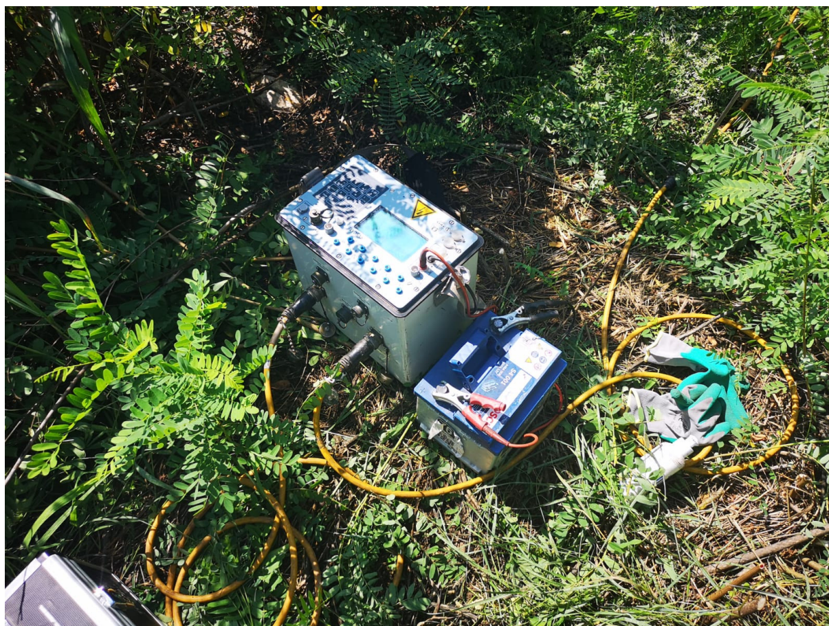
Foto 3 Strumentazione elettrica IRIS SYSCAL PRO 48canali.
