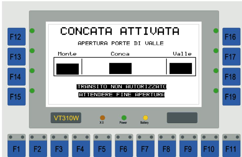
Prima di aprire le porte vinciane vengono aperte le paratoie delle canalizzazioni interne alla struttura della conca che servono a portare il livello in conca uguale al livello all'esterno della porta che si deve aprire.
