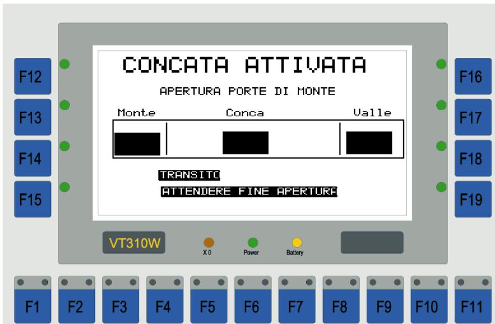
Prima di aprire le porte vinciane vengono nuovamente aperte le paratoie delle canalizzazioni interne alla struttura della conca che servono a portare il livello in conca uguale al livello all'esterno della porta che si deve aprire.
