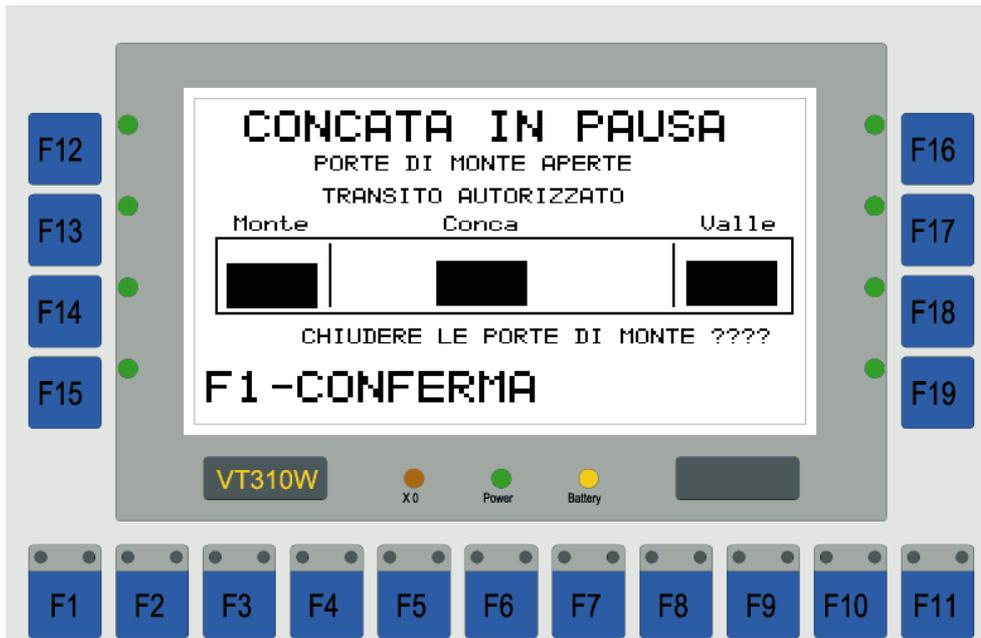
A questo punto l'operatore a bordo, una volta che il semaforo è diventato verde, può portare l'unità di navigazione all'esterno della conca.
