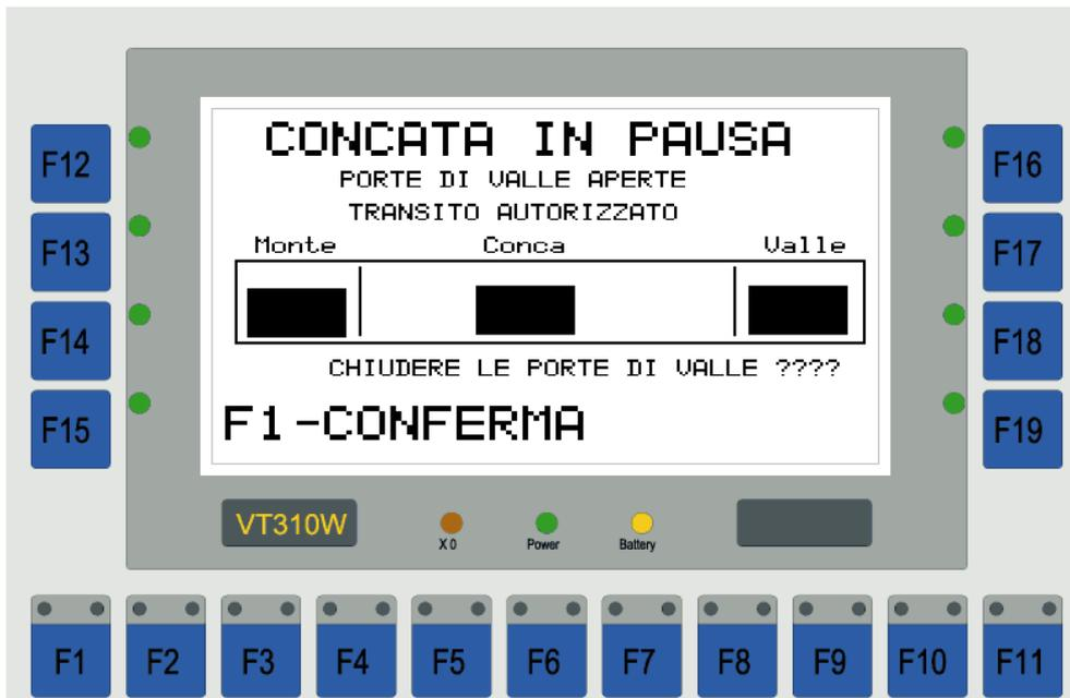
Quando le porte si sono completamente aperte e il semaforo diventa verde l'operatore a bordo può portare l'unità di navigazione all'interno della conca.
