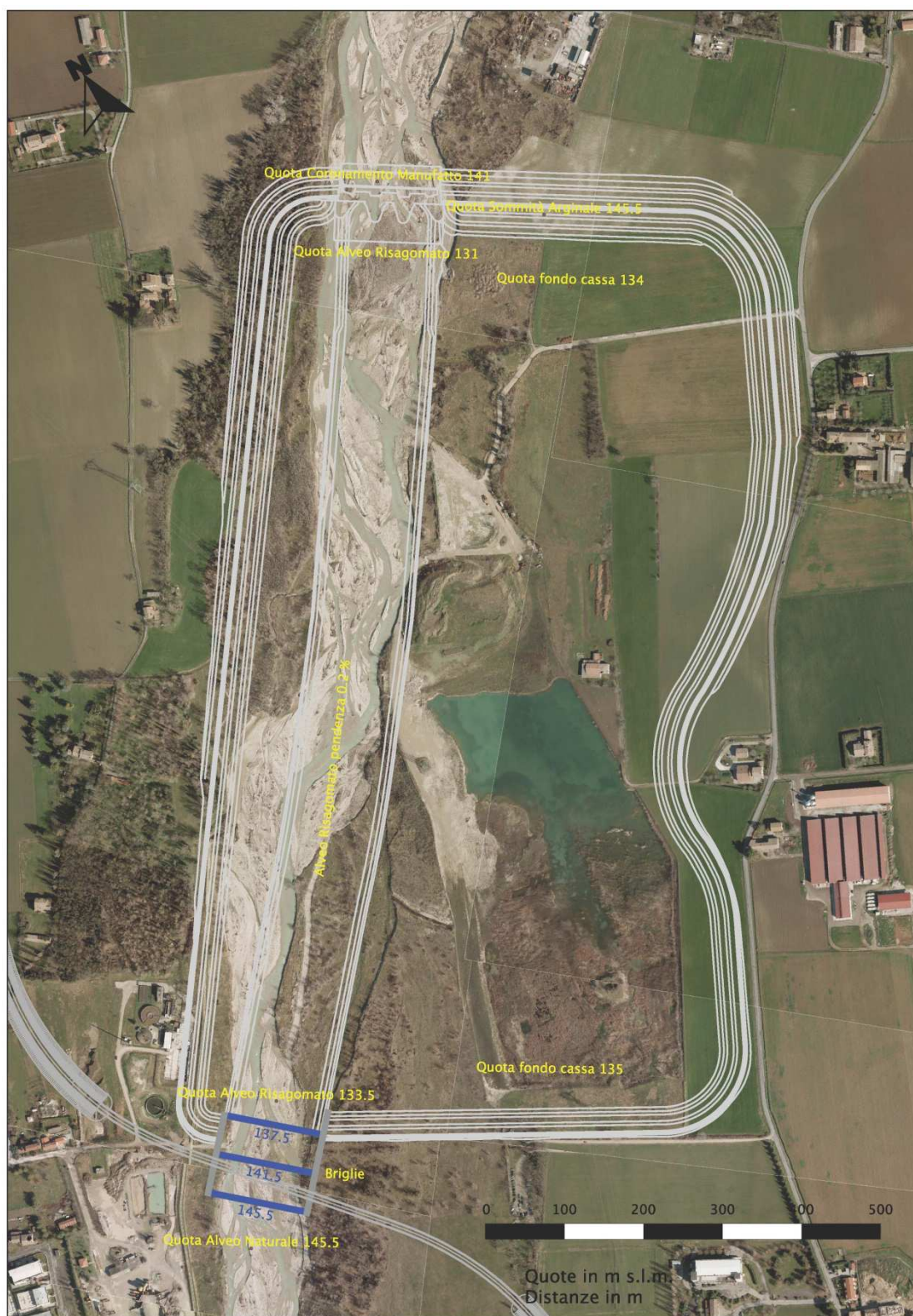
Figura 4-6 – Configurazione e principali quote di progetto della cassa di espansione.
