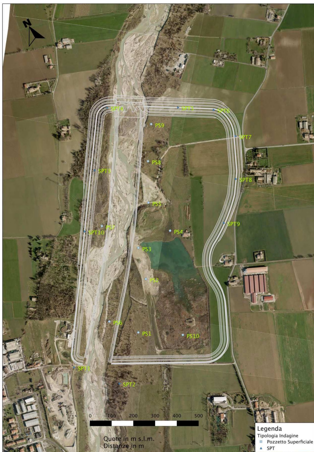
Figura 7-3 – Posizione delle prove SPT e dei pozzetti esplorativi.
