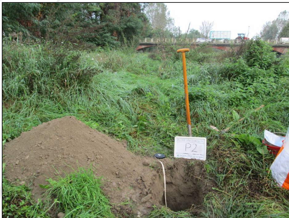
Scavo realizzato in corrispondenza del punto di indagine P2 e cumulo di terreno da cui è stato prelevato il campione P2
