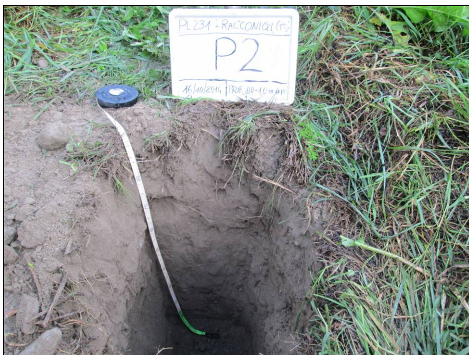
Particolare dello scavo realizzato in corrispondenza del punto di indagine P2
