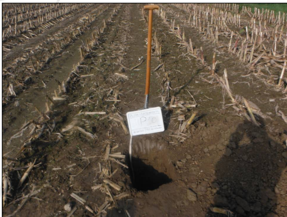
Scavo realizzato in corrispondenza del punto di indagine P10 e cumulo di terreno da cui è stato prelevato il campione P10
