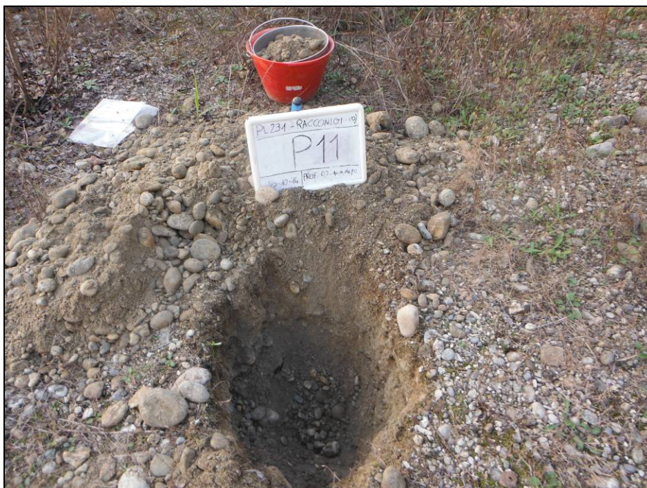
Scavo realizzato in corrispondenza del punto di indagine P11 e cumulo di terreno da cui è stato prelevato il campione P11
