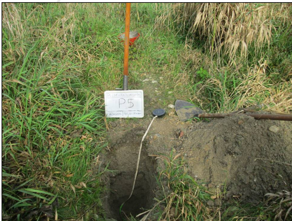
Scavo realizzato in corrispondenza del punto di indagine P5 e cumulo di terreno da cui è stato prelevato il campione P5
