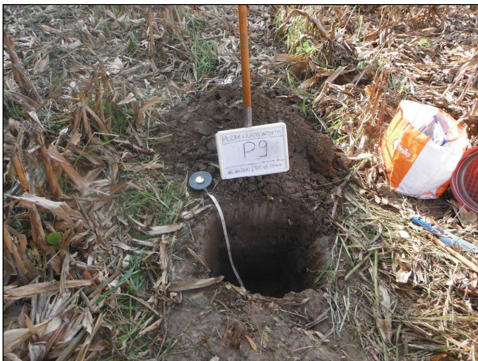
Scavo realizzato in corrispondenza del punto di indagine P9 e cumulo di terreno da cui è stato prelevato il campione P9
