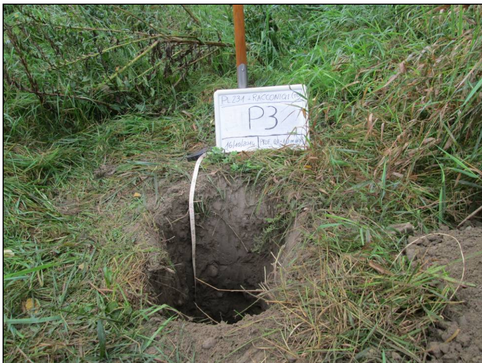
Particolare dello scavo realizzato in corrispondenza del punto di indagine P3
