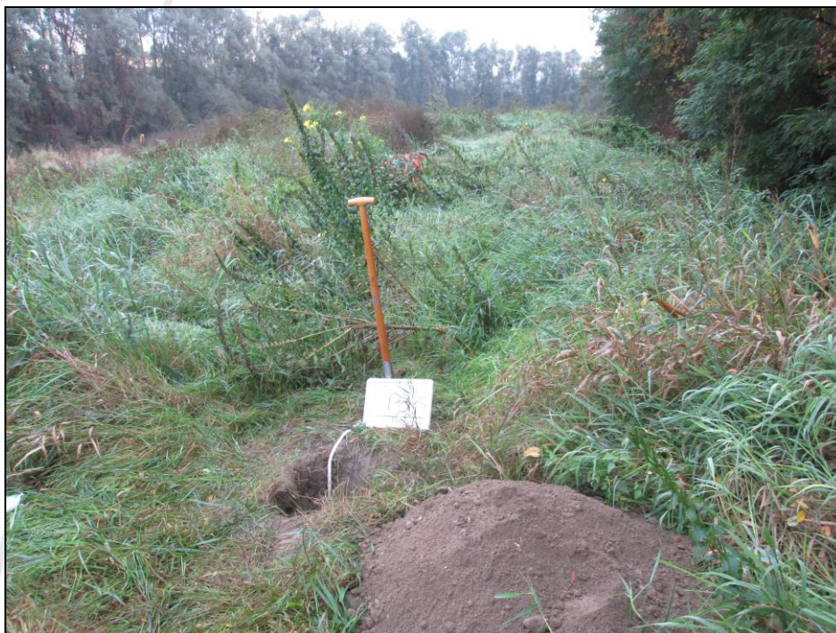
Scavo realizzato in corrispondenza del punto di indagine P3 e cumulo di terreno da cui è stato prelevato il campione P3
