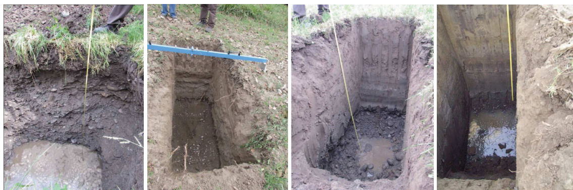
Figura 10 – differenti condizioni dei suoli di fondazione: gruppi A, B C e D (da sinistra a destra)
