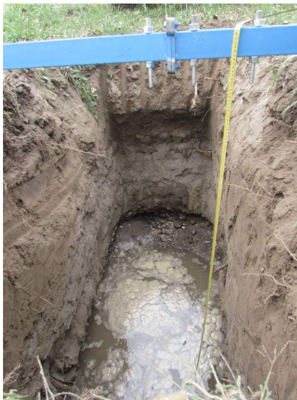
Foto 10: Pozzetto esplorativo PZ5 – prova infiltrometrica in corso
