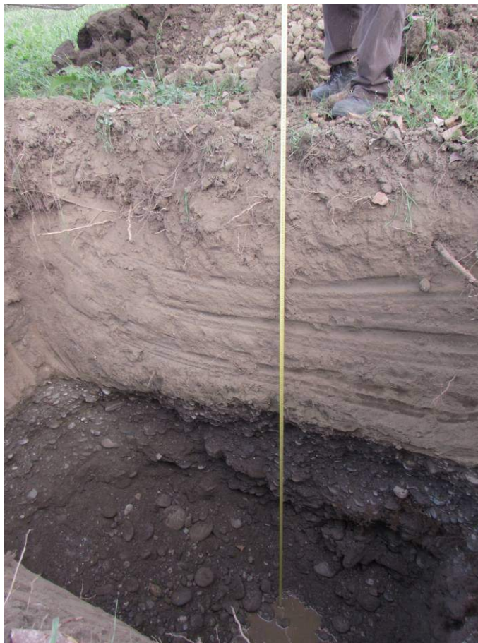
Foto 8: Pozzetto esplorativo PZ4
