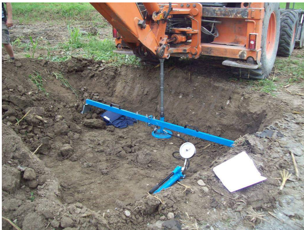
Foto 31: Prova di carico su piastra C1
