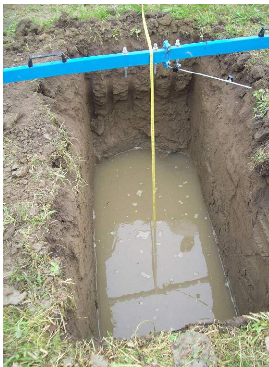
Foto 20: Pozzetto esplorativo PZ11 – prova infiltrometrica in corso
