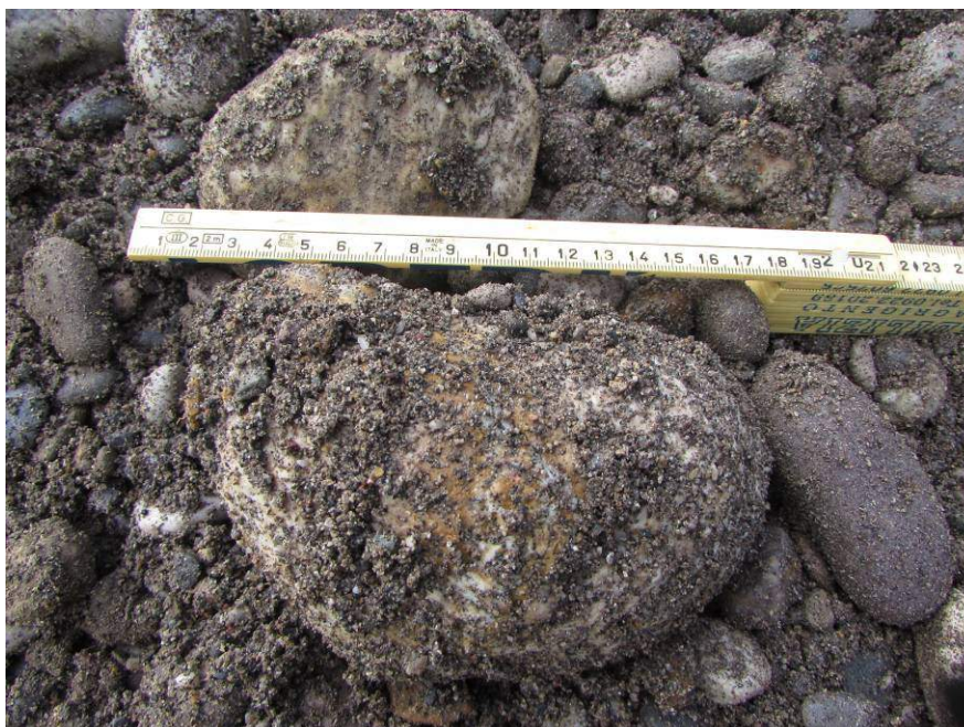
Foto 3: Particolare fotografico dell'unità ghiaiosa sabbiosa con ciottoli in PZ1
