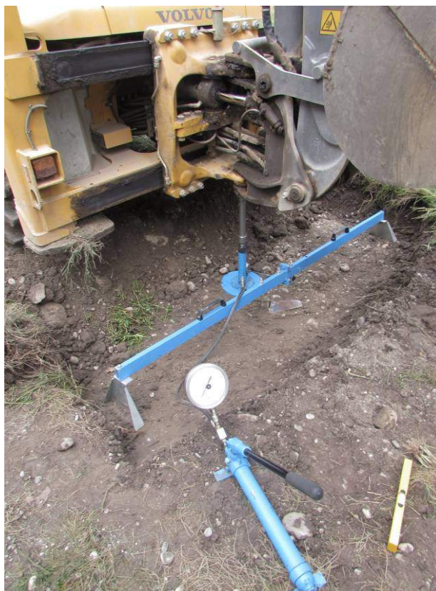
Foto 29: Prova di carico su piastra C1
