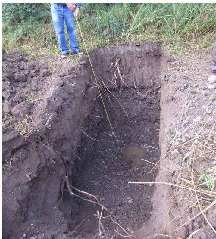
Foto 2: Pozzetto esplorativo
