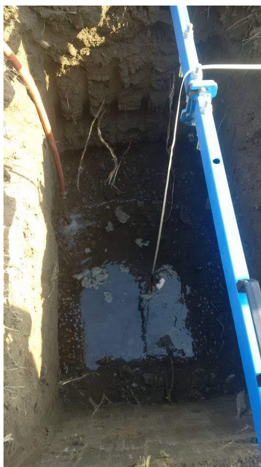
Foto 5: Pozzetto esplorativo PZ2 – prova infiltrometrica in corso
