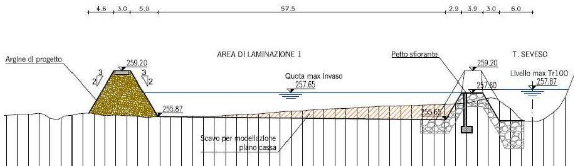
Figura 4 – Sezione trasversale Area 1: manufatto di sfioro e argine di progetto
