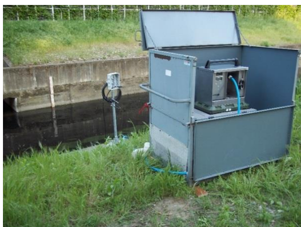
Figura 33 – Autocampionatore installato sul T. Seveso
