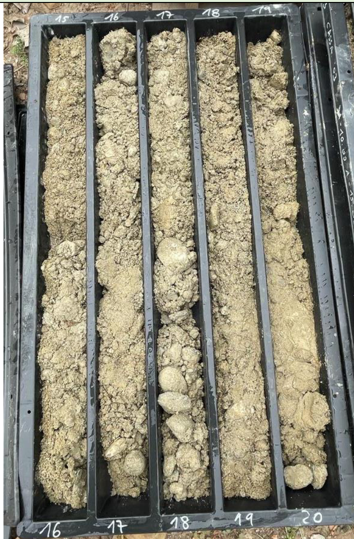
Foto n. 16 – Sondaggio S.3 15,0 m – 20,0 m
