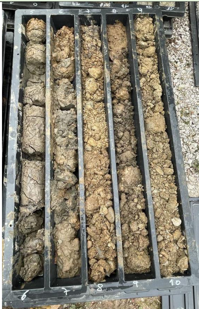
Foto n. 14 – Sondaggio S.3 5,0 m – 10,0 m
