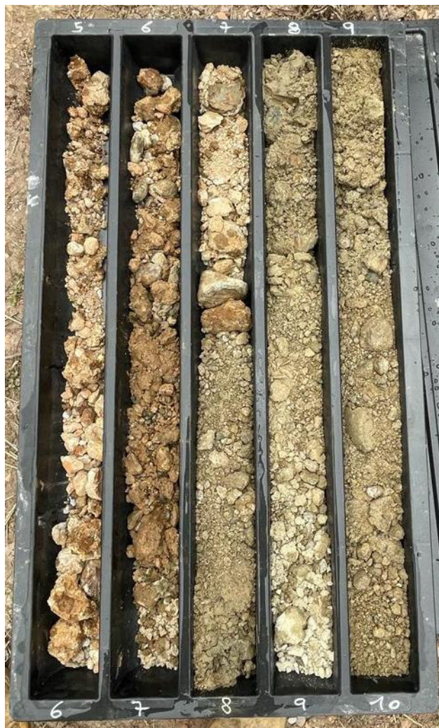
Foto n. 8 – Sondaggio S.2 5,0 m – 10,0 m
