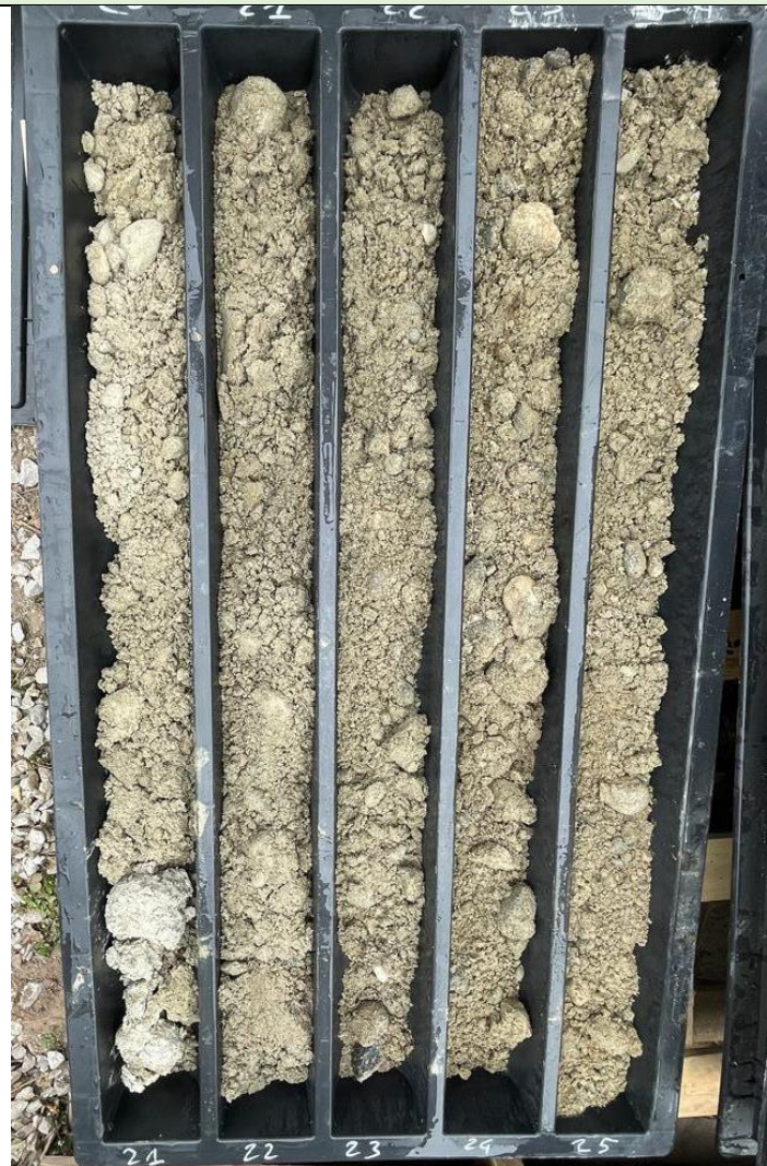
Foto n. 11 – Sondaggio S.2 20,0 m – 25,0 m
