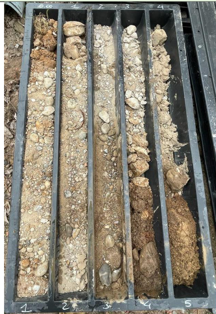
Foto n. 13 – Sondaggio S.3 0,0 m – 5,0 m
