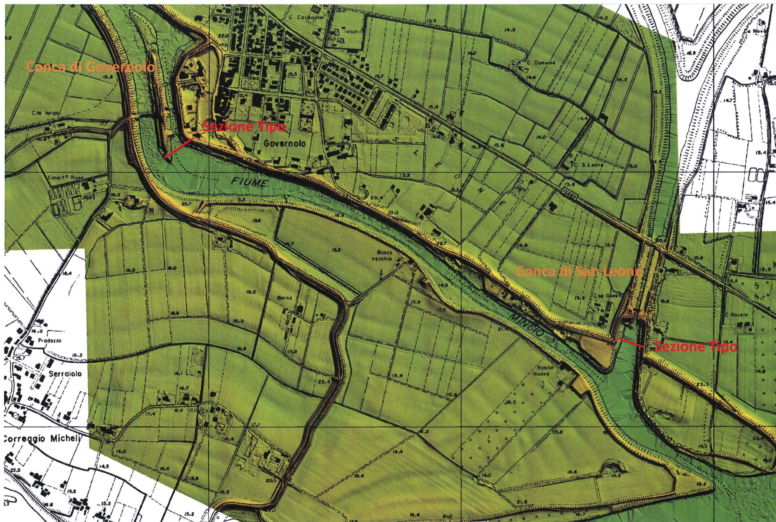
Estratto D.T.M. con indicate le tracce delle Sezioni Tipo di movimentazione materiale
