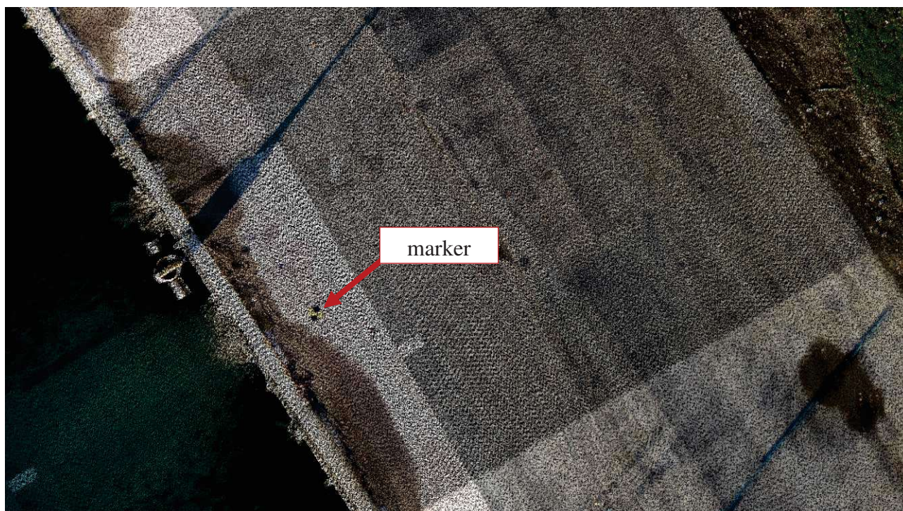
Figura 25: Estratto della nuvola di punti in cui è visibile uno dei marker utilizzati per la georeferenziazione del rilievo
