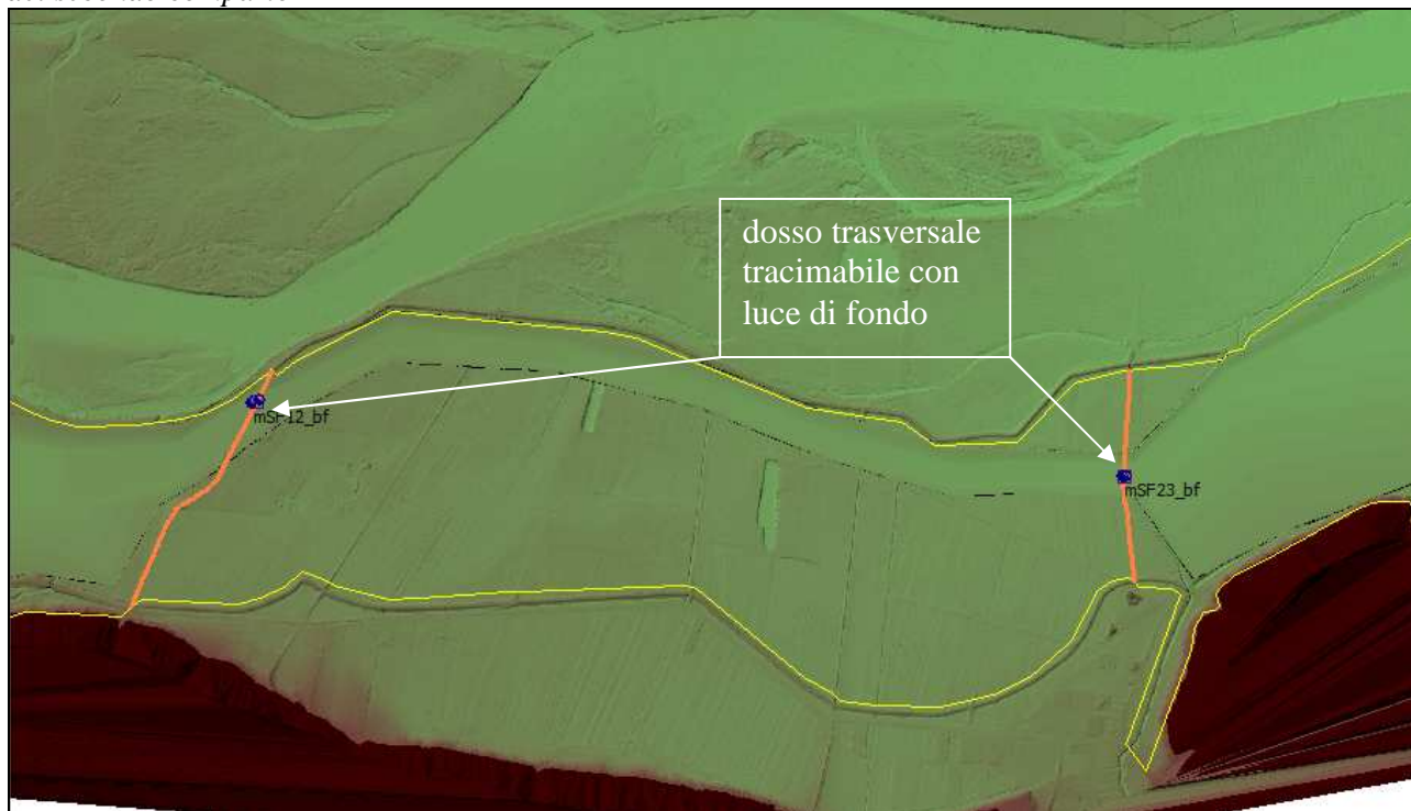
Figura 4.5: altimetria dell'area di laminazione a seguito del rimodellamento proposto e verificato: dettaglio del secondo comparto
