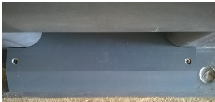
Figura 2.2 - Soglia di fondo installata nel modello, vista in pianta.
