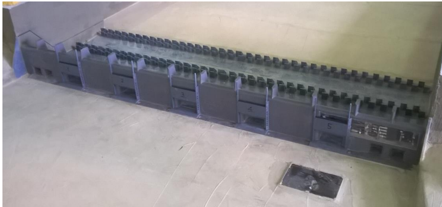
Figura 2.5. Modello del manufatto completo dei nuovi dispositivi di regolazione.
