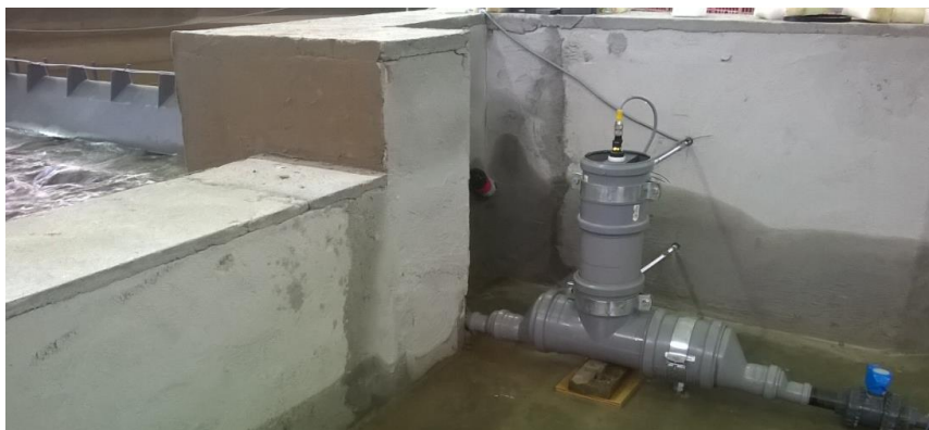
Figura 2.6. Pozzetto di calma a valle del manufatto per la lettura del livello idrico.
