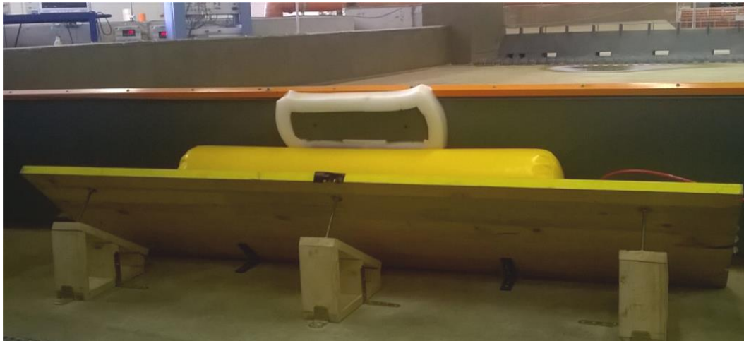
Figura 2.8. Sistema di appoggio per il rullo gonfiabile.
