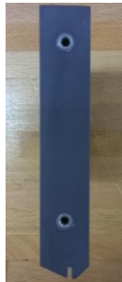
Figura 2.4. Vista laterale di una paratoia e particolare delle boccole per il fissaggio ai gargami.
