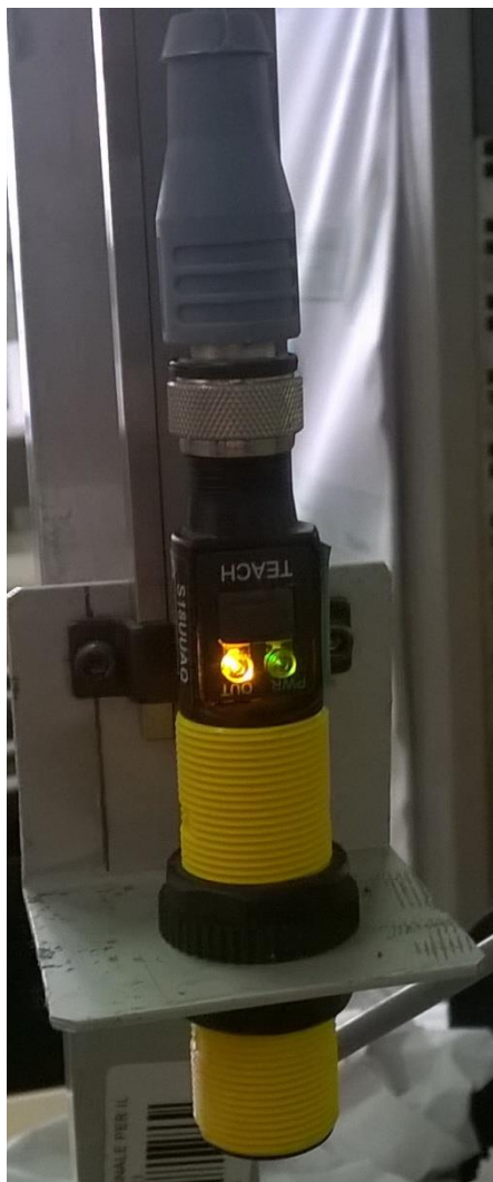
B.3. Sonda Banner S18UUAQ in fase di calibrazione ed in posizione nel pozzetto di calma di valle.
