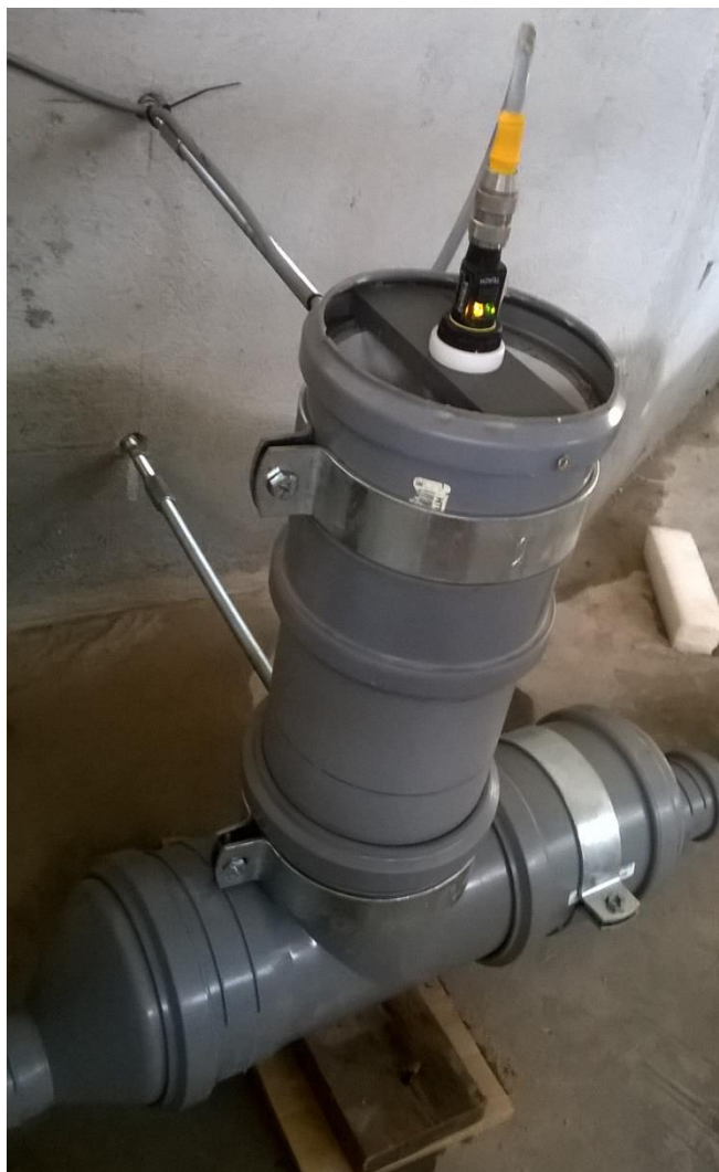
B.3. Sonda Banner S18UUAQ in fase di calibrazione ed in posizione nel pozzetto di calma di valle.
