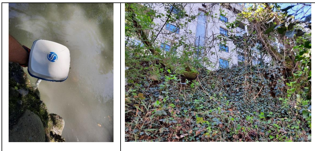
Figura 2 – Misura con strumentazione GPS nei pressi della sezione n. 4 che evidenziano una buca erosiva di profondità >3 metri (SX) e sponda nei pressi della sezione n. 2 in cui la distanza del condominio sito al civico 13 di Via Sondrio è pari a circa 8 metri (DX).
