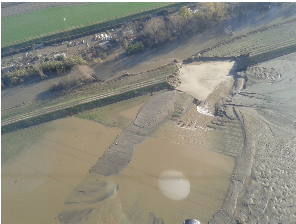
Foto 9 – 26/11/2016: Rotta arginale a valle del ponte di strada Barauda su argine sinistro Vista aerea
