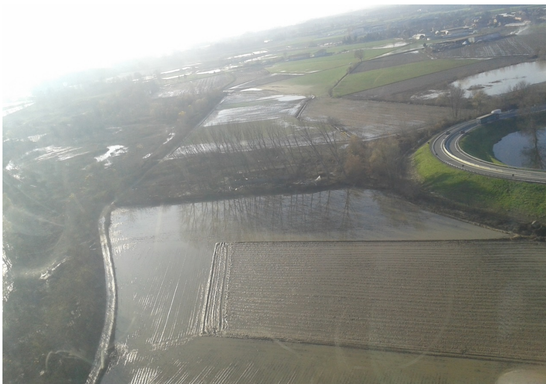
Foto 21 - 26/11/2016: Allagamenti diffusi per effetto dell'esondazione del T. Chisola in sinistra idrografica, a monte del tratto arginato. Vista aerea
